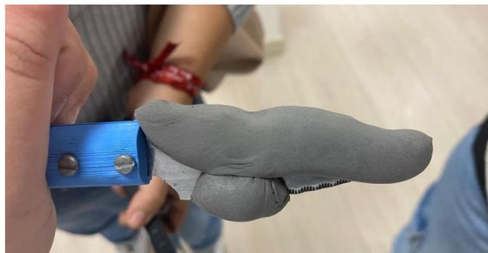
***Ilustración 4: Medida del filo del cuchillo con masilla Guumyart.***
