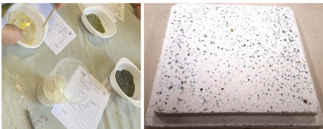
Figura 2. Fabricación con la receta de la placa de yeso reciclada y placa de yeso con residuos.
