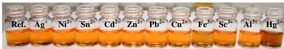
Figura II.67: Respuesta del cicloaducto 42f ( 10^{-4}M , MeCN) frente a 1 eq de la sal perclorato del catión correspondiente.
