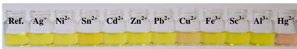
Figura II.16: Respuesta de la ditiolona 13 ( 10^{-4}\text{M} , MeCN) frente a 1 eq de la sal perclorato del catión correspondiente.
