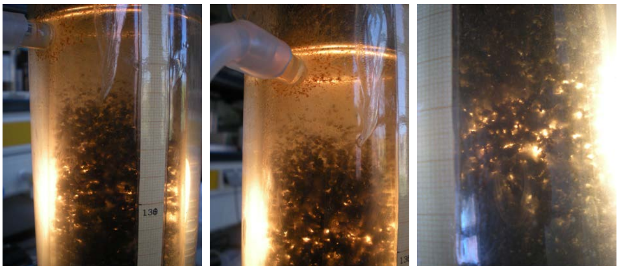
Figura 104: Imágenes del proceso de floculación producido en el EGSB.
