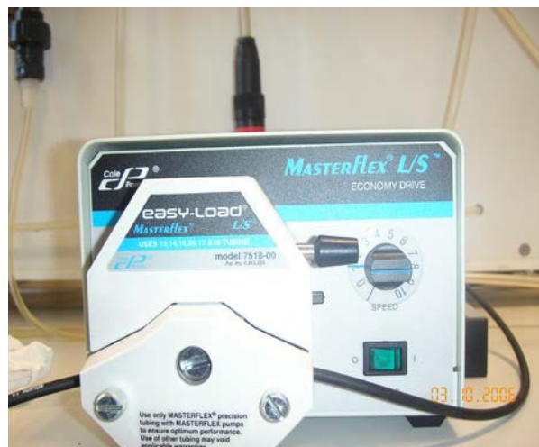
Figura 37: Bomba utilizada para graduar la alimentación
