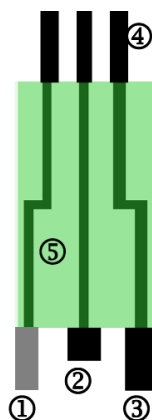
Figura 4.3. Diagrama del sistema electródico usado en un electrodo serigrafiado de carbón. 1. Electrodo de referencia; 2. Electrodo de trabajo de carbón; 3. Contra electrodo; 4. Conexiones eléctricas; 5. Capa aislante dieléctrica.
