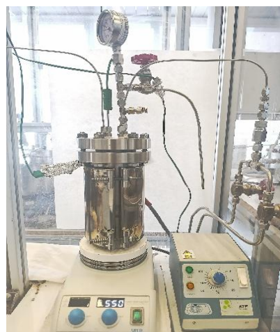
Figura 6. Esquema y foto del reactor para la extracción PLE: (1) Reactor (2) Camisa (3) Placa de agitación (4) Toma de muestra (5) Entrada de gas.
