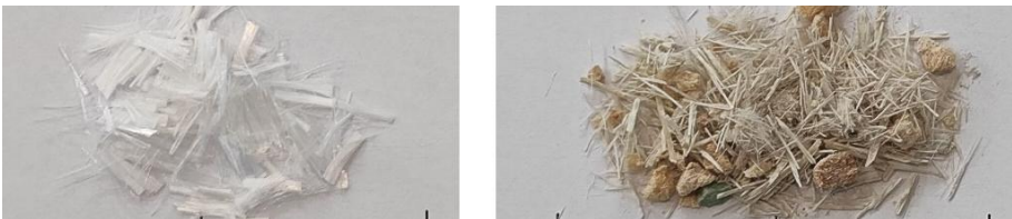
Figura 2. Tipos de fibras: fibras de polipropileno (izquierda) y TPA (derecha)
