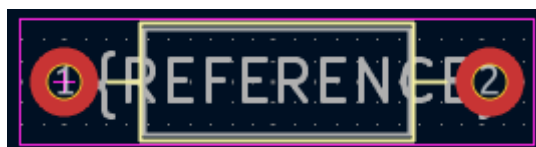
Figura 2.6. Huella de una resistencia axial THT, con separación de 10.16 mm entre sus agujeros de diámetro 2.54 mm
