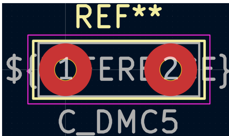
Figura 5.9: Huella C_Rect_L7.0mm_W2.5mm_P5.00mm modificada, con pads cuyo agujero es de 1 mm y cuyo diámetro exterior es de 2.5 mm
