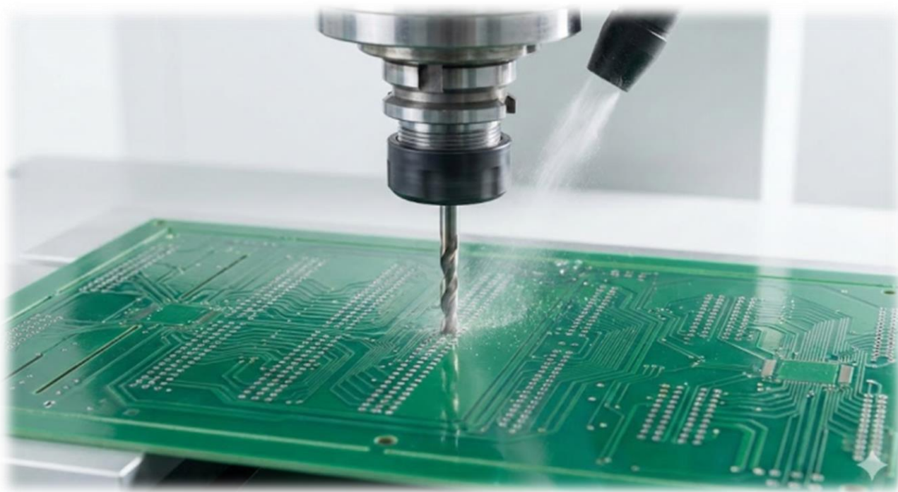
Figura 8.3: Taladrado de un agujero en una PCB con las capas de cobre ya grabadas [14]
