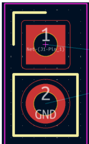
Figura 2.7. Huella de una pareja de pines de conexión, a los que el usuario de la placa deberá conectar una fuente de tensión
