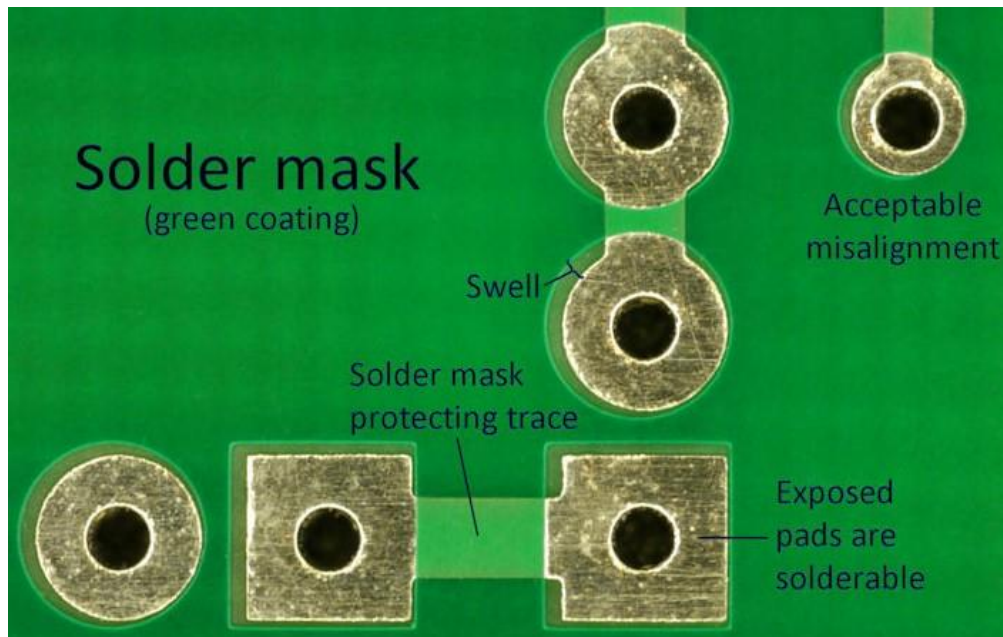
Figura 8.6: Ejemplo de aplicación de una máscara sobre las pistas de una PCB. La máscara no se aplica sobre los pads, los cuales quedan con el cobre expuesto, para poder soldar los componentes [17]
