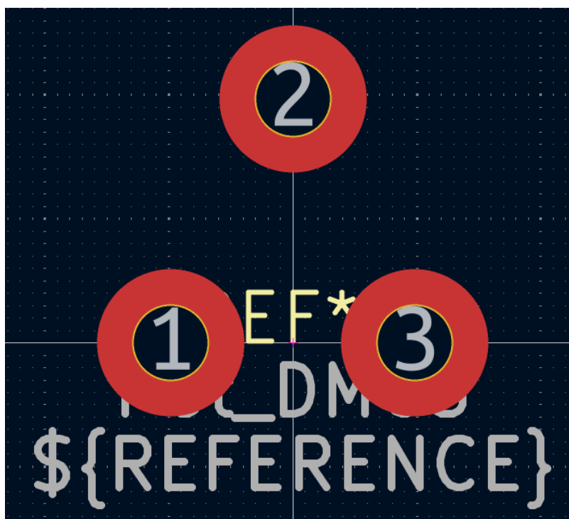
Figura 5.11: Pads de la huella del potenciómetro BOURNS 3306F
