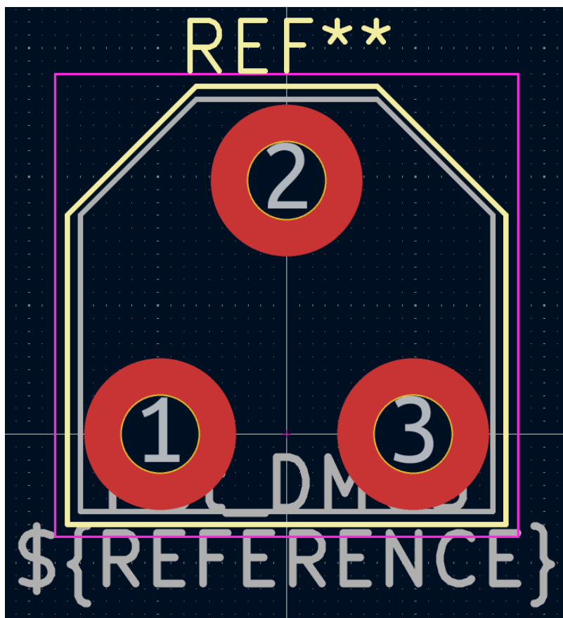
Figura 5.12: Huella personalizada del potenciómetro BOURNS 3306F
