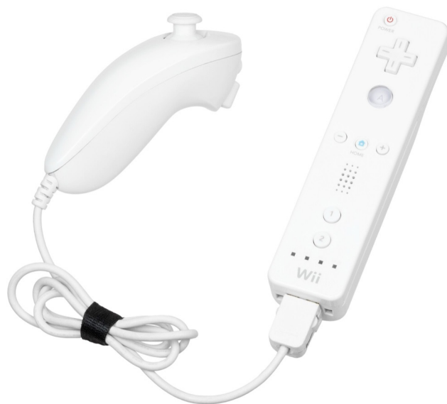
Figura 1.6. El Wii Remote y el Nunchuk: acelerómetros para detectar el movimiento, un sensor infrarrojo para apuntar a la pantalla y enlace inalámbrico por Bluetooth. (foto: Evan-Amos · dominio público)
