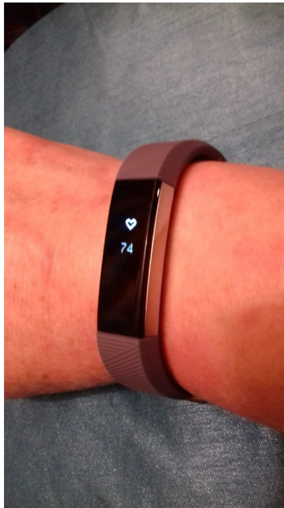
Figura 10.1. Una pulsera de actividad: dentro lleva una IMU, un sensor óptico de pulso, una batería diminuta y radio para enviar los datos al móvil. (foto: PamD · CC BY-SA 4.0)
