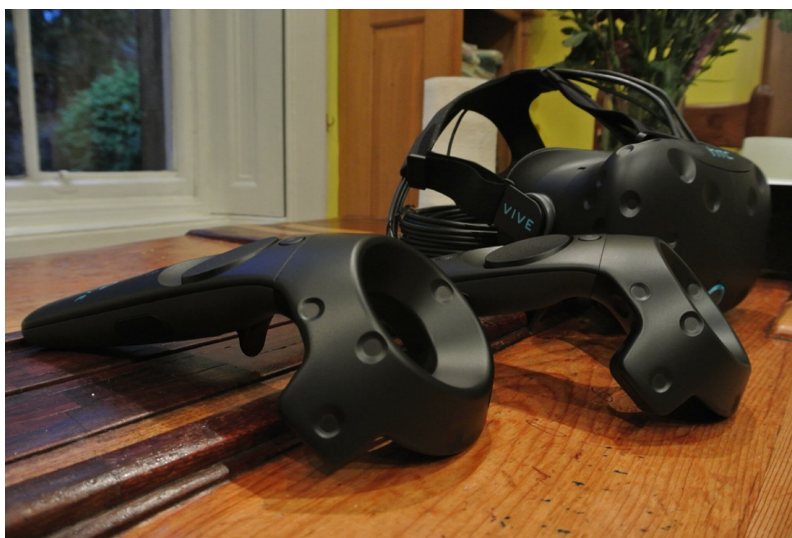
Figura 10.2. Un visor de realidad virtual y sus dos mandos. Cada mando lleva una IMU, botones, un gatillo y elementos que el sistema de seguimiento localiza en el espacio con seis grados de libertad. (foto: PB · CC BY-SA 4.0)
