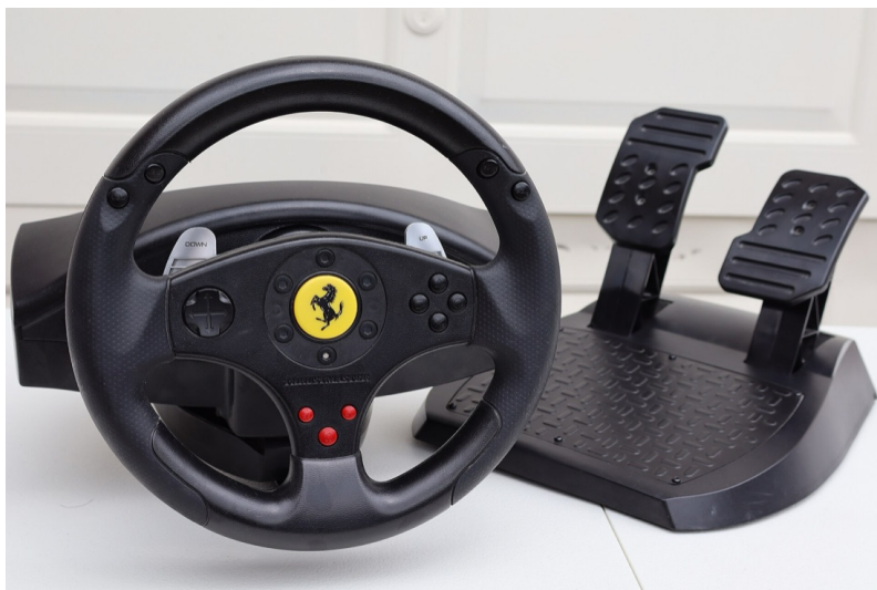
Figura 6.6. Un volante con pedales: el giro se mide con un potenciómetro o un encoder , los pedales con potenciómetros, y un motor devuelve fuerza al volante (capítulo 7). (foto: FreeMediaKid! · CC BY 4.0)
