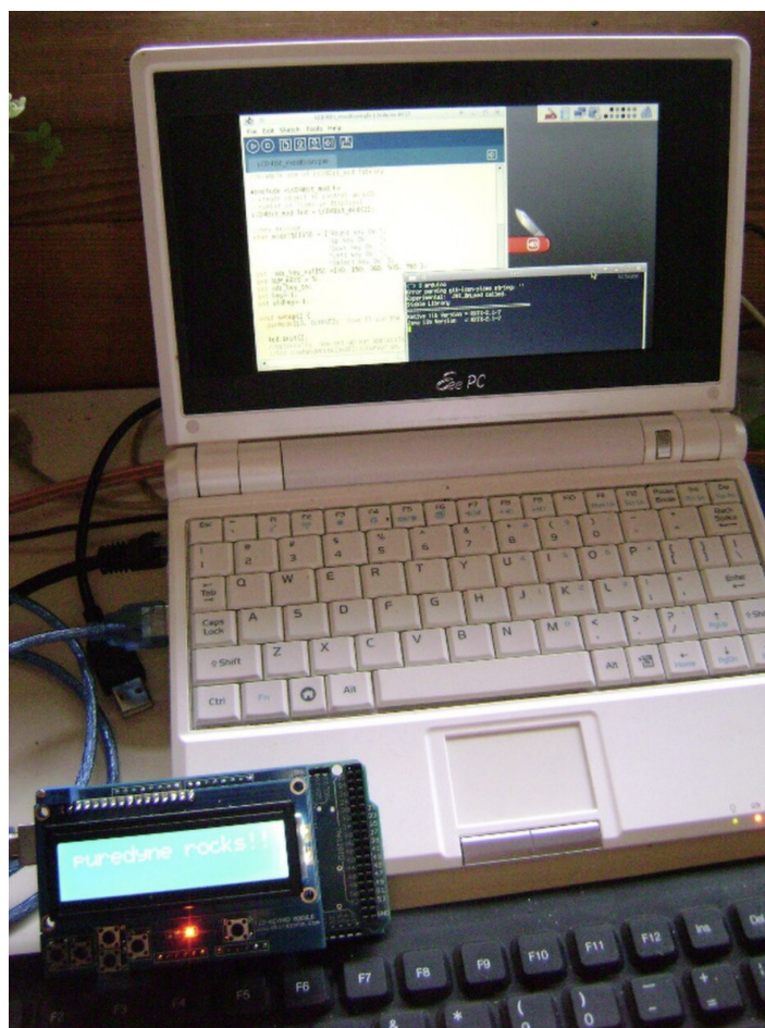
Figura 9.3. Montaje de extremo a extremo: una placa Arduino con un sensor, conectada por un cable USB al ordenador donde corre el motor de juego.
