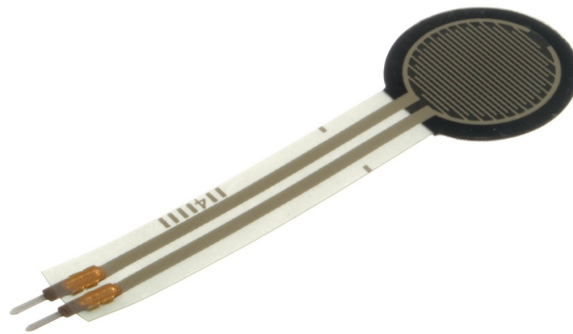
Figura 3.3. Un resistor sensible a la fuerza (FSR), plano y redondo, y un sensor de flexión en tira. Ambos cambian de resistencia al deformarse y se leen con un divisor. (foto: oomlout / Bomazi · CC BY-SA 2.0)
