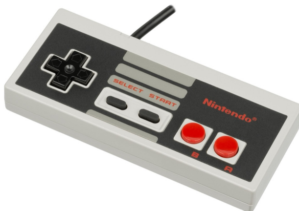
Figura 1.3. El mando de la NES: la cruceta y los botones A/B son un conjunto de contactos digitales; su disposición marcó décadas de diseño de mandos. (foto: Evan-Amos · dominio público)
