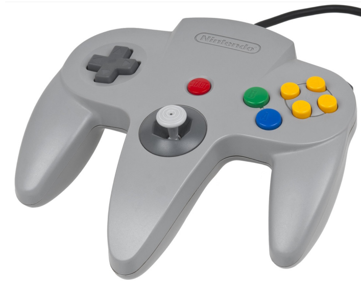
Figura 1.5. El mando de la Nintendo 64 y su palanca analógica, el primer stick de una consola doméstica. (foto: Evan-Amos · dominio público)
