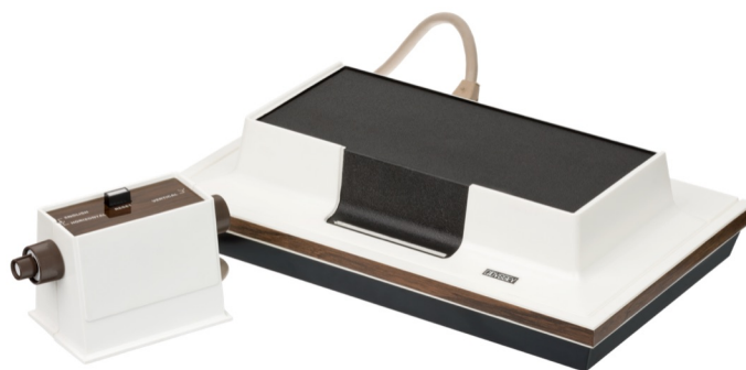
Figura 1.2. La perilla de la Magnavox Odyssey y de las máquinas de Pong : girarla mueve el cursor de forma continua, generando una señal analógica. (foto: Evan-Amos · dominio público)
