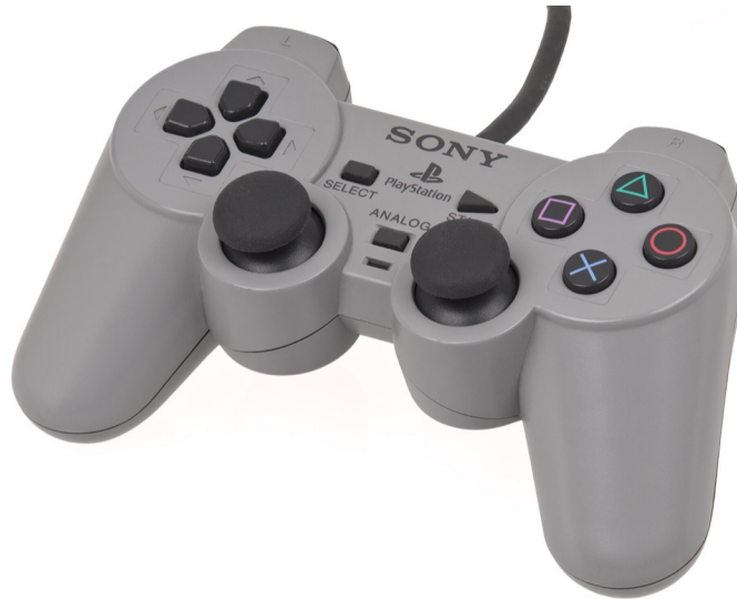
Figura 1.4. El DualShock de PlayStation: dos palancas analógicas, que exigen un convertidor analógico-digital, y el primer motor de vibración integrado en un mando. (foto: Evan-Amos · dominio público)
