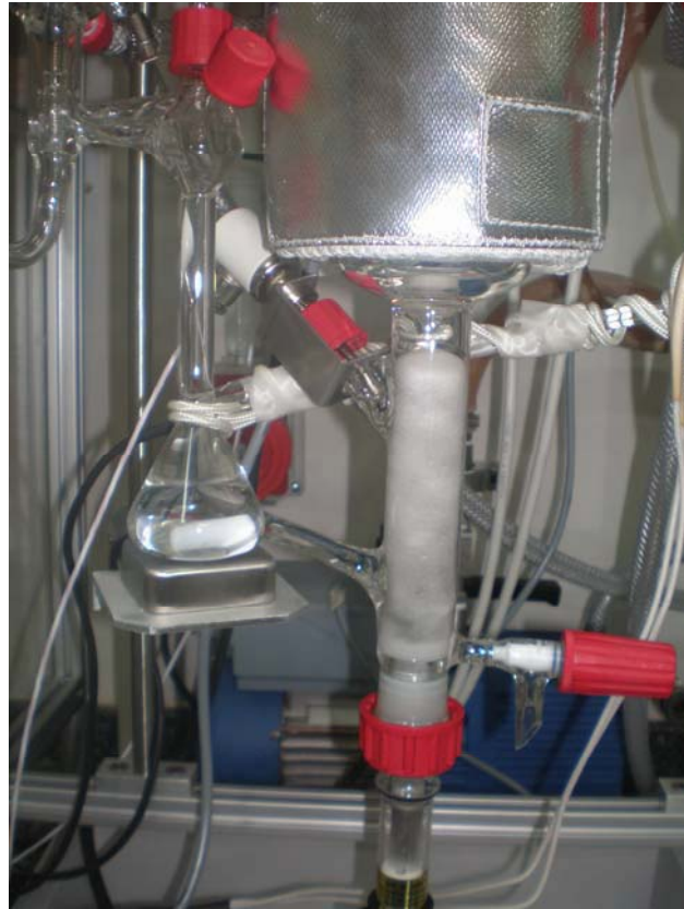
Figura 3.6 Detalle zona inferior del equipo VLE 602S.
