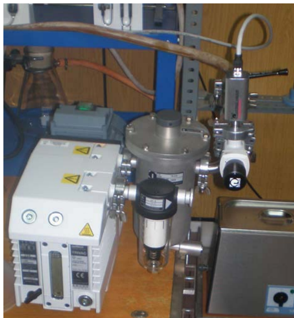
Figura 5.6 Detalle de la bomba rotativa de vacío, vacuómetro, válvulas y trampa fría
