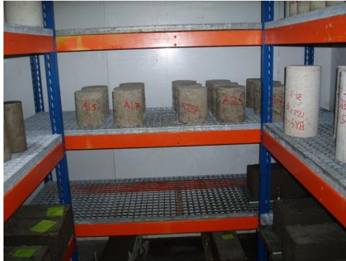
Foto 80. Disposición en la cámara de curado de las probetas cilíndricas
