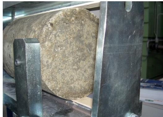
Foto 96. Rotura a tracción indirecta de una probeta cilíndrica
