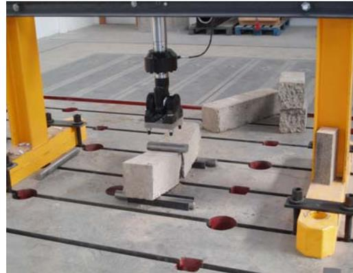
Foto 101. Ensayo a fatiga de una probeta prismática
