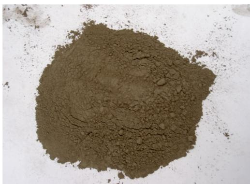
Foto 37. Muestra de cemento ESP VI-1 32,5 N
