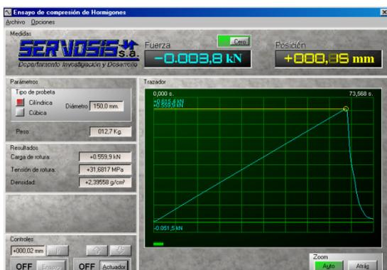
Figura 15. Detalle pantalla del programa para rotura de las probetas cilíndricas
