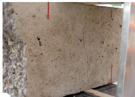
Foto 98. Rotura de una probeta prismática a tracción indirecta
