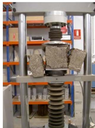
Foto 94. Rotura de la probeta mitad de una prismática ya ensayada
