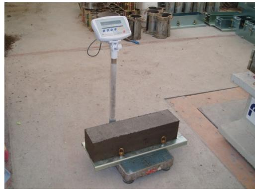
Fotos 65 y 66. Pesaje de probeta prismática tras su fabricación y a los 5 días de curado apoyada en la base del molde
