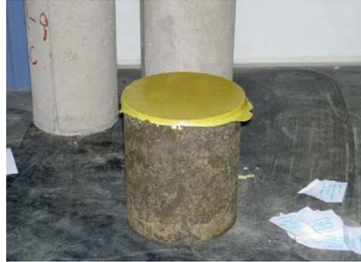
Foto 43. Probeta cilíndrica refrentada con azufre
