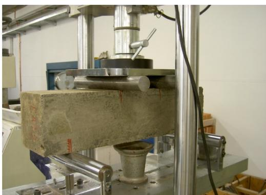
Foto 99. Colocación de la probeta prismática para ensayar a flexotracción
