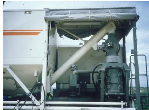
Fotos 6 y 7. Detalles del distribuidor de lechada Wirtgen WM-100
