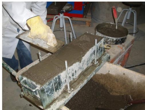
Foto 87. Acabado con mortero de la probeta
