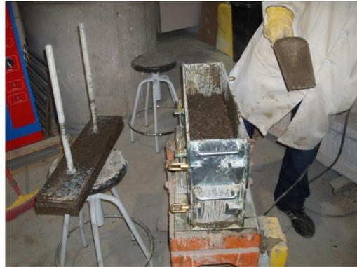
Foto 85. Fabricación de probeta prismática
