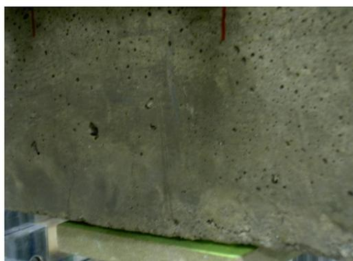
Foto 100. Aspecto de la probeta fisurada
