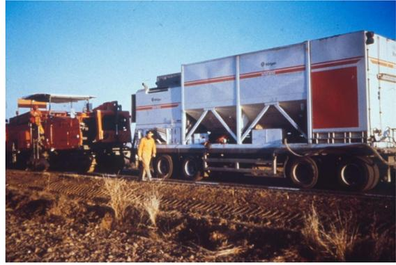
Foto 5. Distribuidor de lechada Wirtgen
