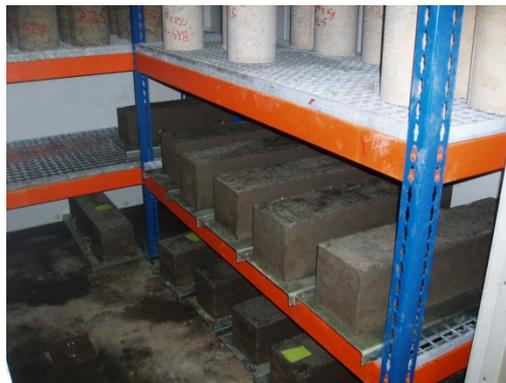
Foto 90. Disposición en la cámara de curado de las probetas prismáticas
