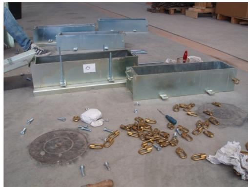
Fotos 48 y 49. Moldes cilíndricos y montaje de moldes prismáticos
