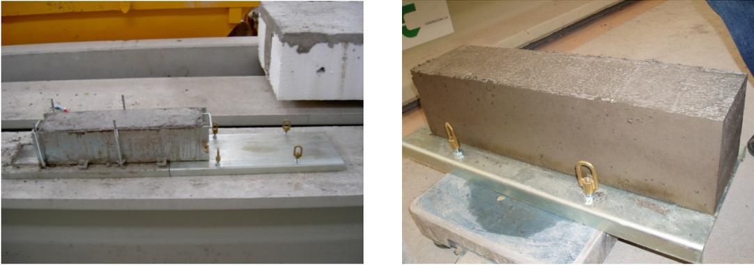
Fotos 88 y 89. Desmoldeo de probetas prismáticas
