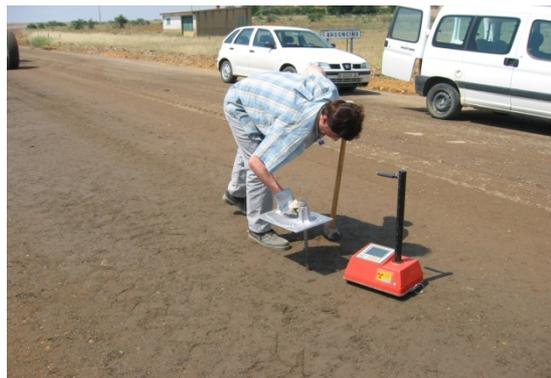
Fotos 13 y 14. Control del espesor, características y densidad del material
