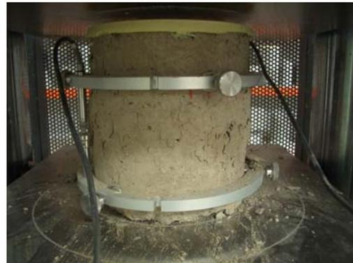
Foto 103. Detalle de la probeta rota a compresión para medir el módulo
