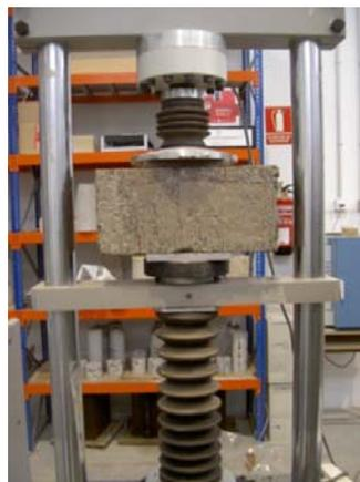
Foto 93. Colocación de la mitad de una prismática para romper a compresión
