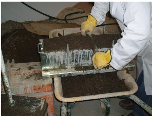
Foto 86. Enrasado de probetas prismáticas
