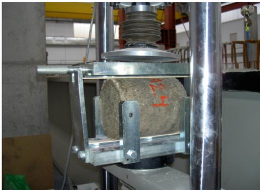
Foto 95. Colocación de una probeta cilíndrica para ensayar a tracción indirecta
