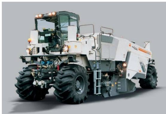
Foto 10. Recicladora Wirtgen con dosificador de conglomerante incorporado
