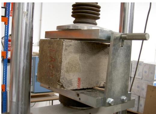
Foto 97. Colocación de la mitad de una probeta prismática para ensayar a tracción indirecta
