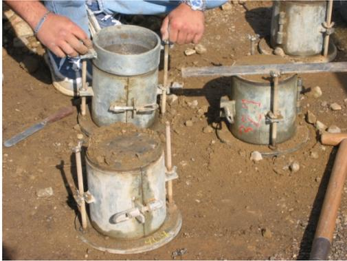
Foto 3. Realización de probetas
