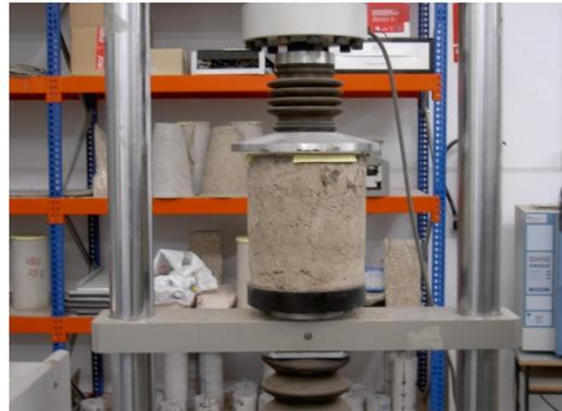
Foto 92. Rotura de una probeta cilíndrica
