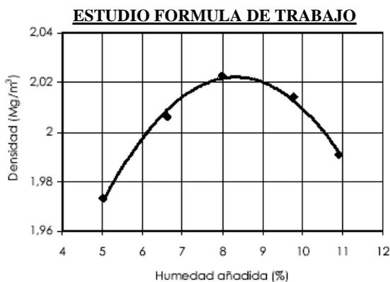
Figura 3. Ensayo Proctor modificado
