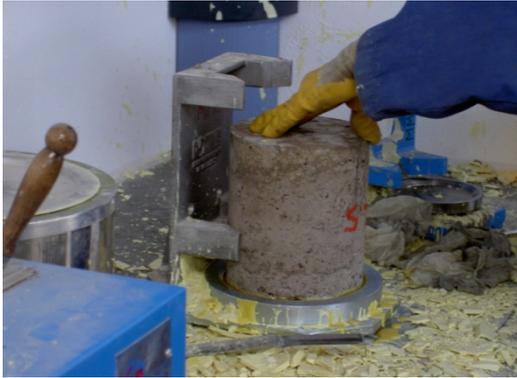
Foto 42. Refrentado de una probeta cilíndrica
