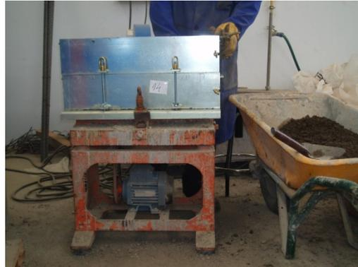
Fotos 53 y 54. Mordazas para la sujeción de los moldes a la mesa vibrante
