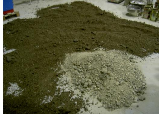
Fotos 82 y 83. Secado del material en el suelo y en la estufa
