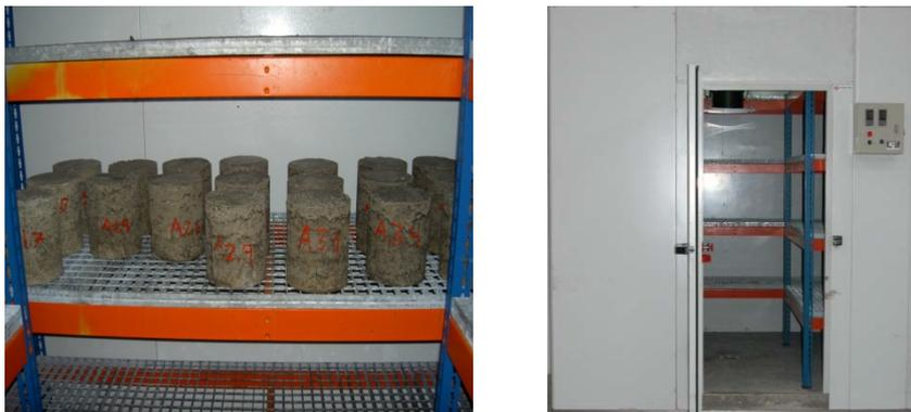
Fotos 58 y 59. Cámara húmeda, interior y exterior
