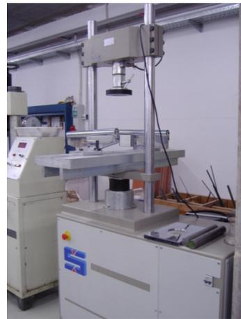
Fotos 62 y 63. Equipos de rotura para compresión y flexotracción
