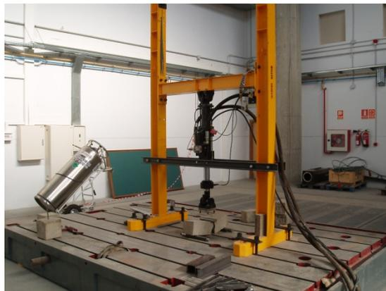
Foto 64. Prensa dinámica empleada en los ensayos de fatiga
