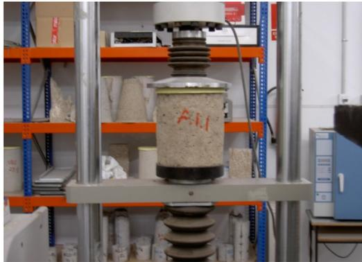
Foto 91. Colocación de una probeta cilíndrica para romper a compresión
