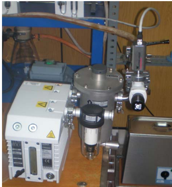
Figura 3.6 Detalle de la bomba rotativa de vacío, vacuómetro, válvulas y trampa fría
