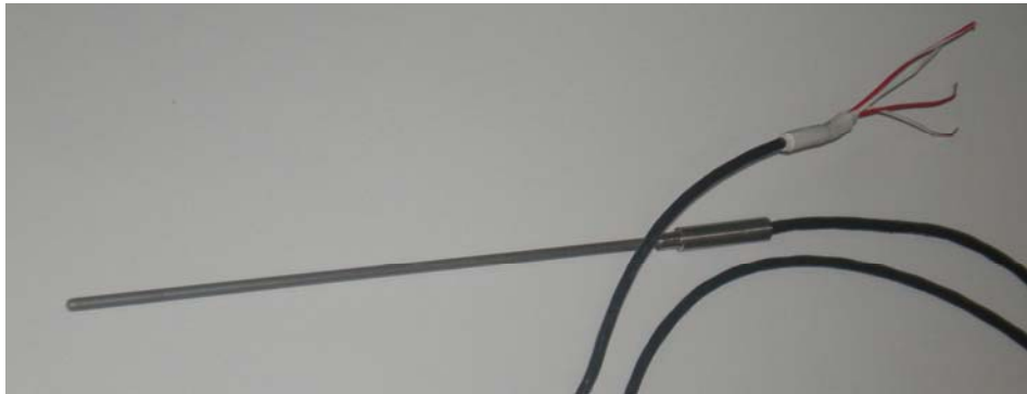
Figura 3.3 Termómetro Pt 100. Se encuentra alojado en el módulo DMA HPM
