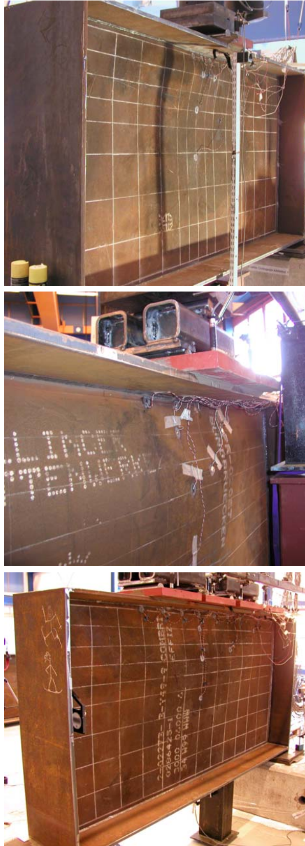
Figura 5. 7. Imágenes en carga última de las vigas de los ensayos P200, arriba, P700, centro, y P1400, abajo, [Gozzi, 2007].
