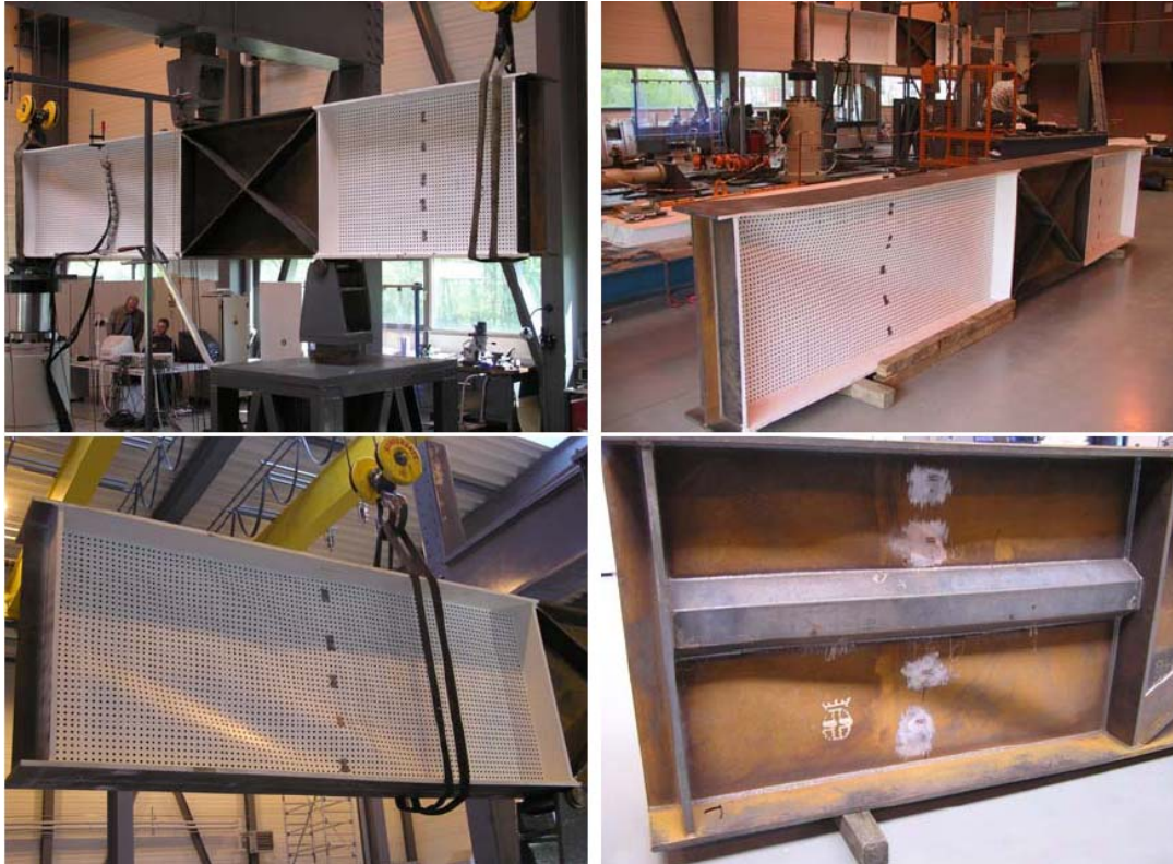
Figura 4. 6. Deformadas en los especímenes tras la realización de los ensayos, [COMBRI, 2005b].
