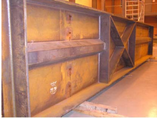
Figura 4. 3. Viga de acero con rigidizador longitudinal trapecoidal fabricado a partir de las placas de acero suministradas por Dillinger Hütte AG, [COMBRI, 2005a].
