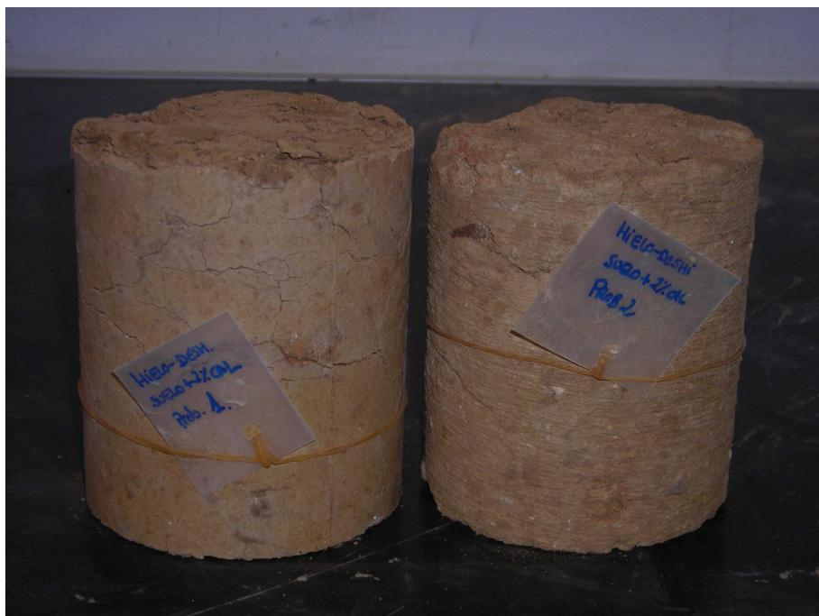
Figura 171. Probetas tras ensayo hielo-deshielo de la mezcla S3C2
