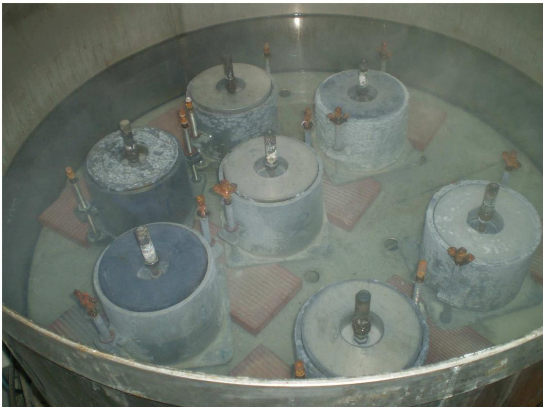
Figura 155. Baño para probetas en el ensayo de expansión potencial
