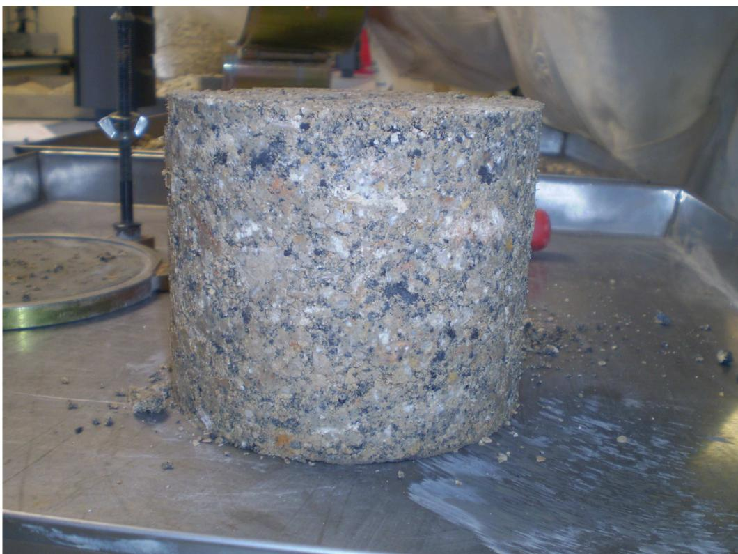
Figura 189. Probeta de de la mezcla 40EN-60D
