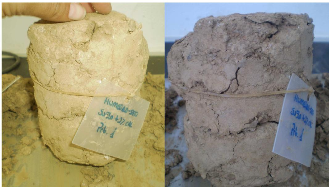
Figura 165. Probetas tras ensayo humedad-sequedad de la mezcla S1C2
