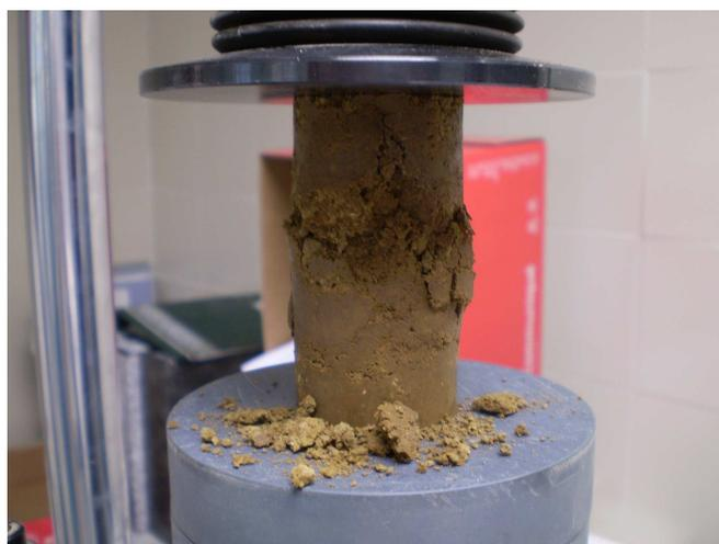
Figura 144. Probeta de suelo S3 con 90 días de curado
