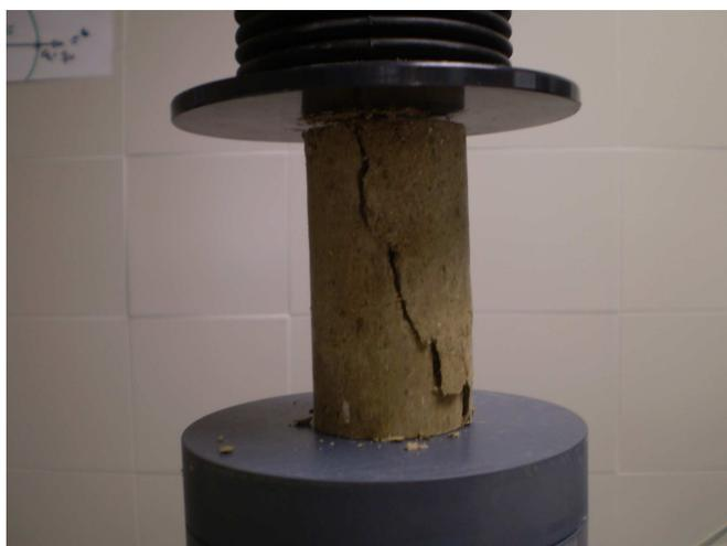
Figura 143. Probeta de mezcla con escoria S1E5 con 90 días de curado
