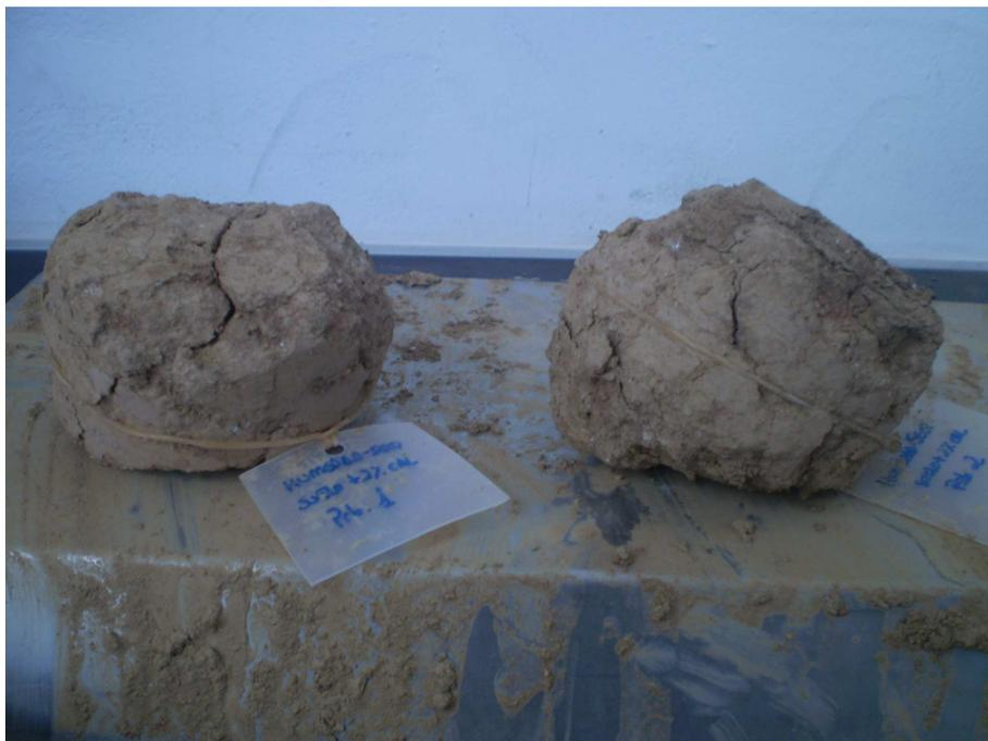
Figura 167. Probetas tras ensayo humedad-sequedad de la mezcla S3C2
