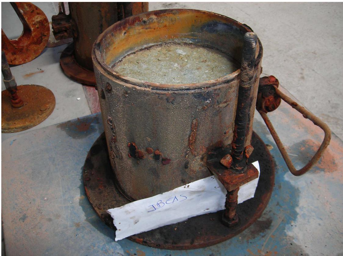
Figura 157. Probeta de S2E5 tras el ensayo de expansión potencial
