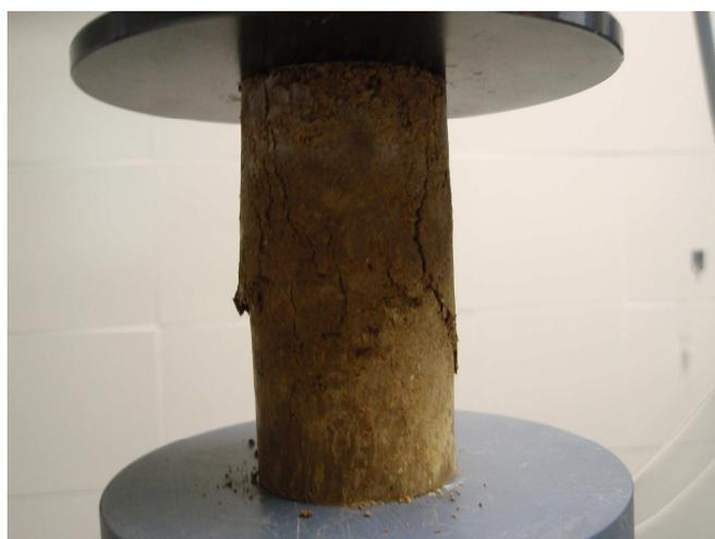
Figura 146. Probeta de mezcla con escoria S3E5 con 90 días de curado
