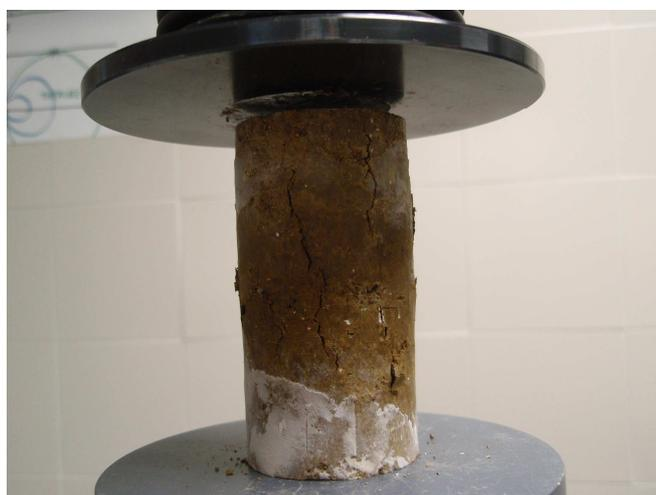
Figura 145. Probeta de mezcla con cal S3C2 con 90 días de curado
