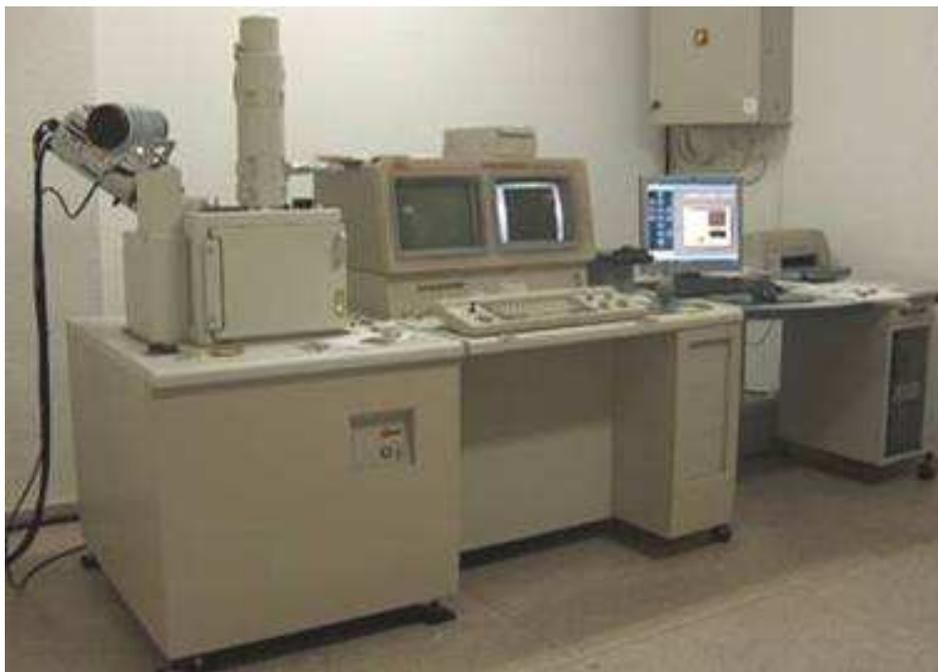
Figura 23. Microscopio electrónico de barrido
