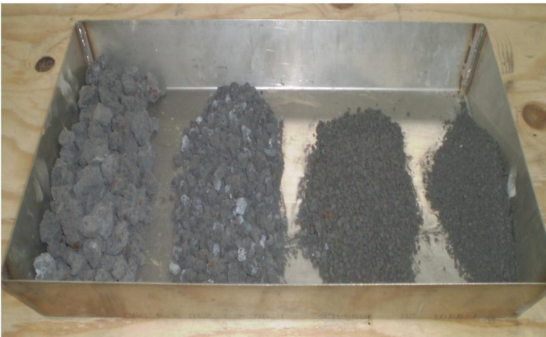
Figura 80. Diferentes fracciones granulométricas de escoria de EAF
