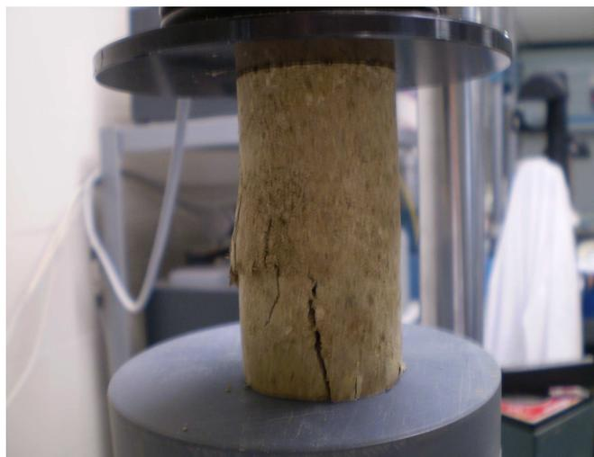
Figura 141. Probeta de suelo S1 con 90 días de curado
