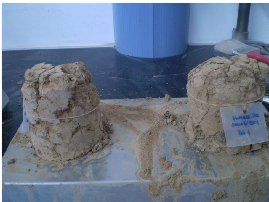
Figura 168. Probetas tras ensayo humedad-sequedad de la mezcla S3E5
