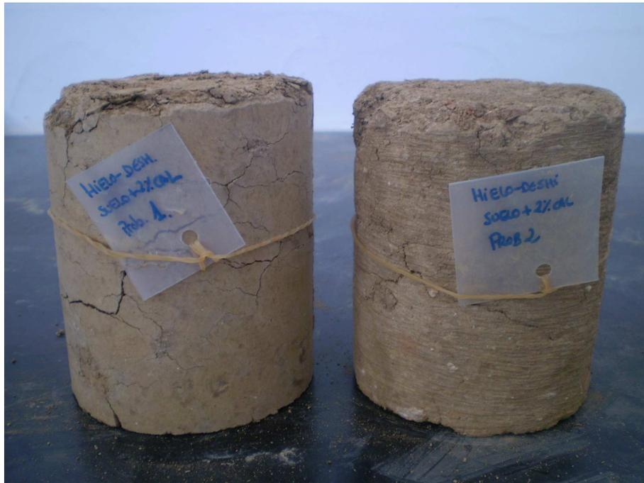
Figura 169. Probetas tras ensayo hielo-deshielo de la mezcla S1C2
