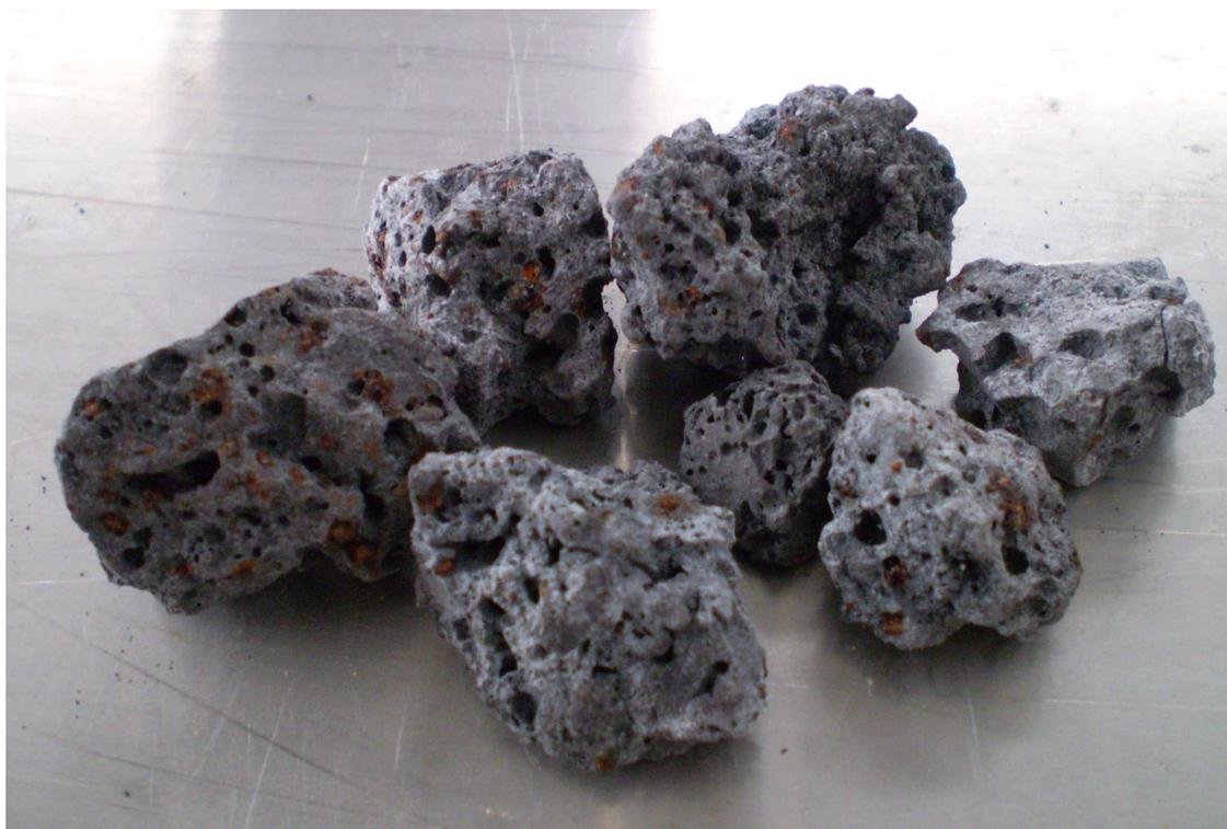
Figura 81. Detalle de árido grueso de escoria de EAF
