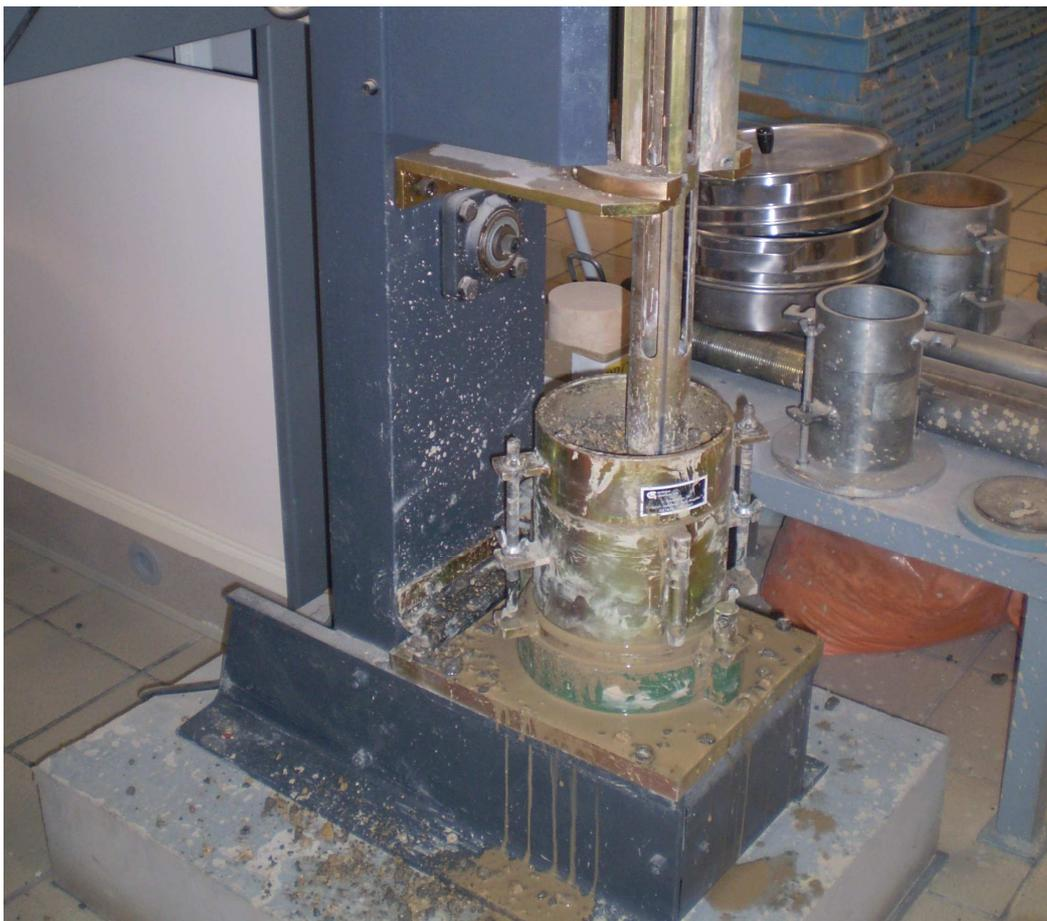
Figura 186. Compactación de la mezcla 60EN-40D con maza automática
