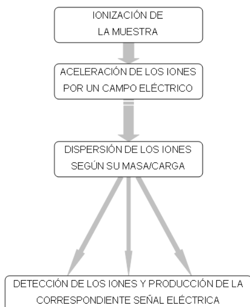
Figura A.4. Esquema de las etapas fundamentales en espectrometría de masas.
