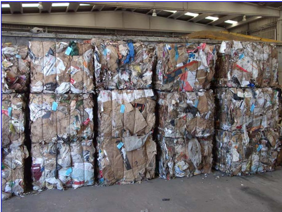
**Figura 3.14.** Balas de Papel/cartón almacenadas para recogida por un recuperador.
