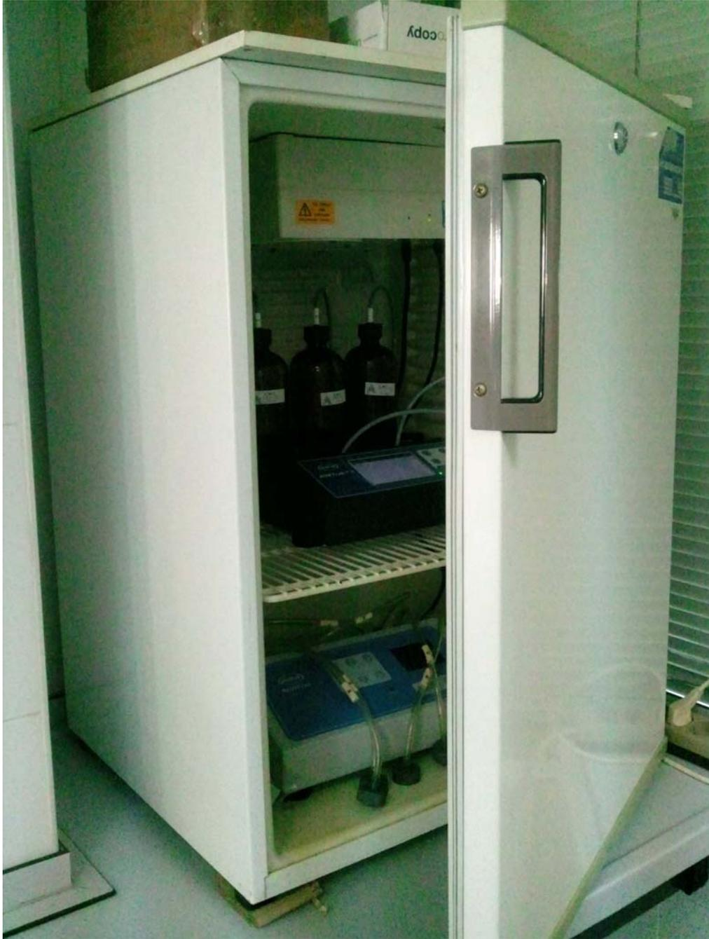
**Figura 3.51.** Determinación de la  $DBO_5$  (III)
