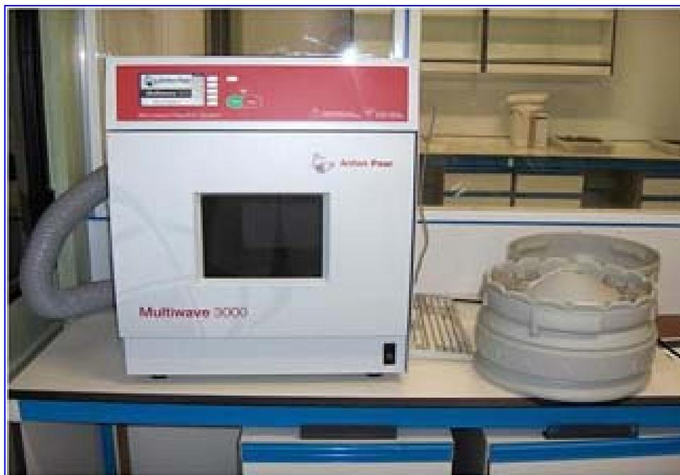
**Figura 3.43.** Digestión de muestras en microondas Anton Paar multiwave 3000
