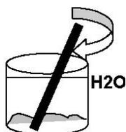
6.-Comprobar el pH del agua destilada después de lavar el cadmio 10 veces. Cuando el pH sea neutro continuar con el paso 7. Si el pH no es neutro continuar lavando el cadmio con agua destilada.
