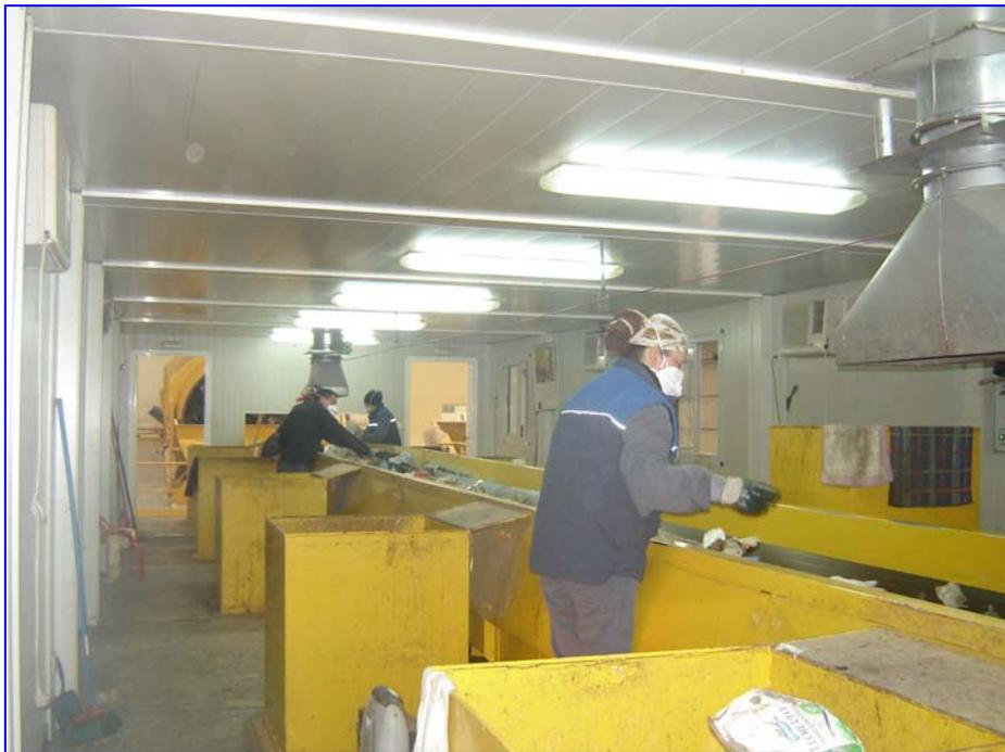
**Figura 3.9.** Operarios realizando 1 er triaje manual
