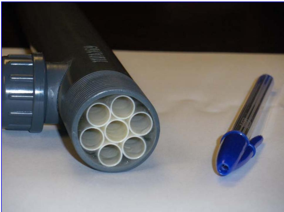
**Figura 3.30.** Interior de la membrana de cartucho de PVDF
