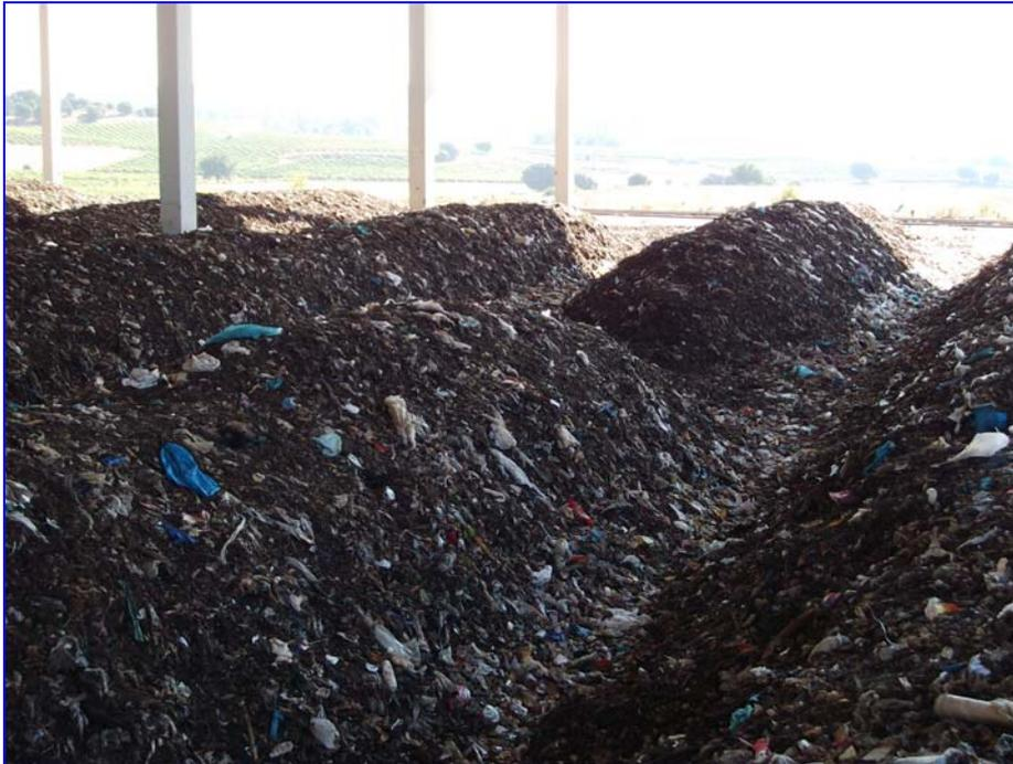
**Figura 3.21.** Cordón en dos mitades.  $\frac{1}{2}$  regado con lixiviado y  $\frac{1}{2}$  con agua industrial
