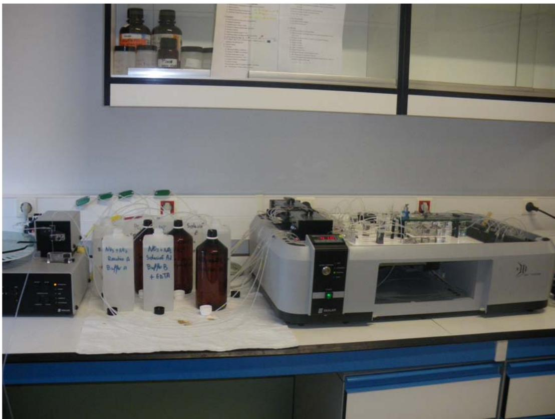
**Figura 3.46.** Determinación de nitratos y nitritos con el SKALAR SAN<sup>plus</sup> ANALYZER
