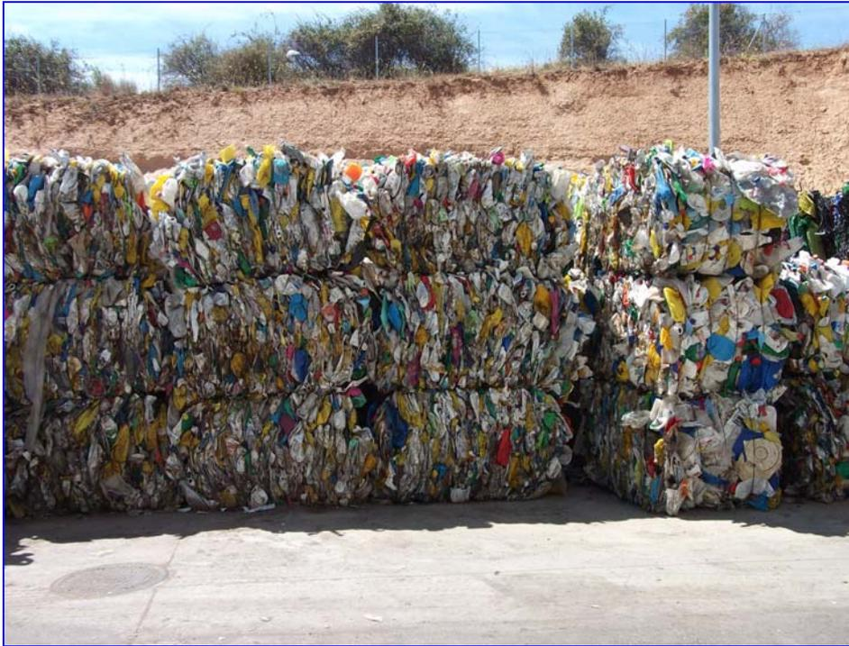
**Figura 3.11.** Balas de PEAD almacenadas para recogida por un recuperador.
