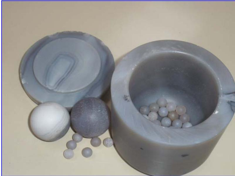
**Figura 3.41.** Molino de bolas FRITSCH, mod pulveristte para triturado de las muestras de residuo
