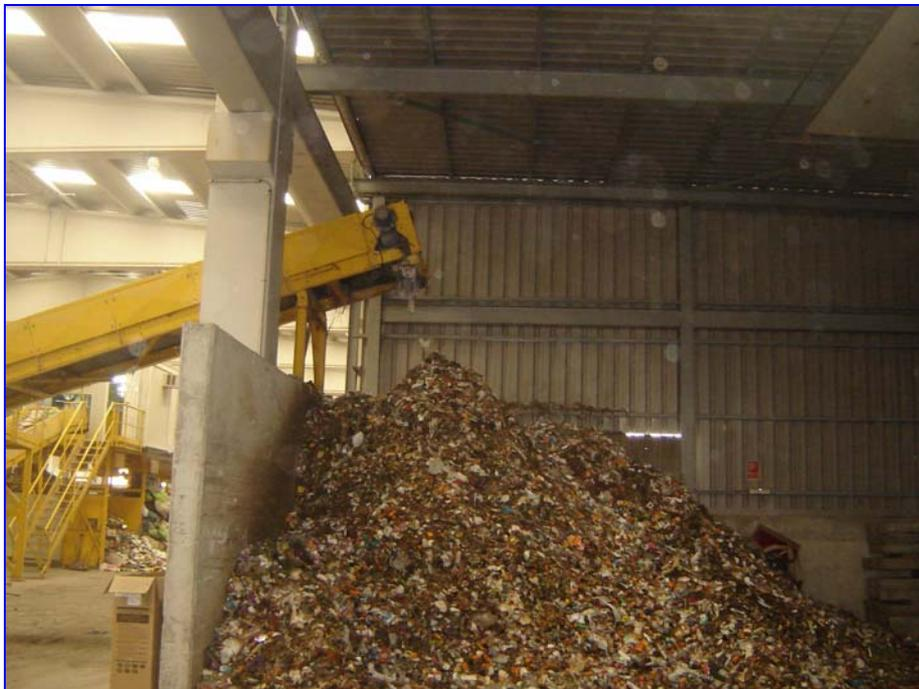
**Figura 3.18.** Cinta de descarga de la fracción pasante (<90mm).Principalmente MO
