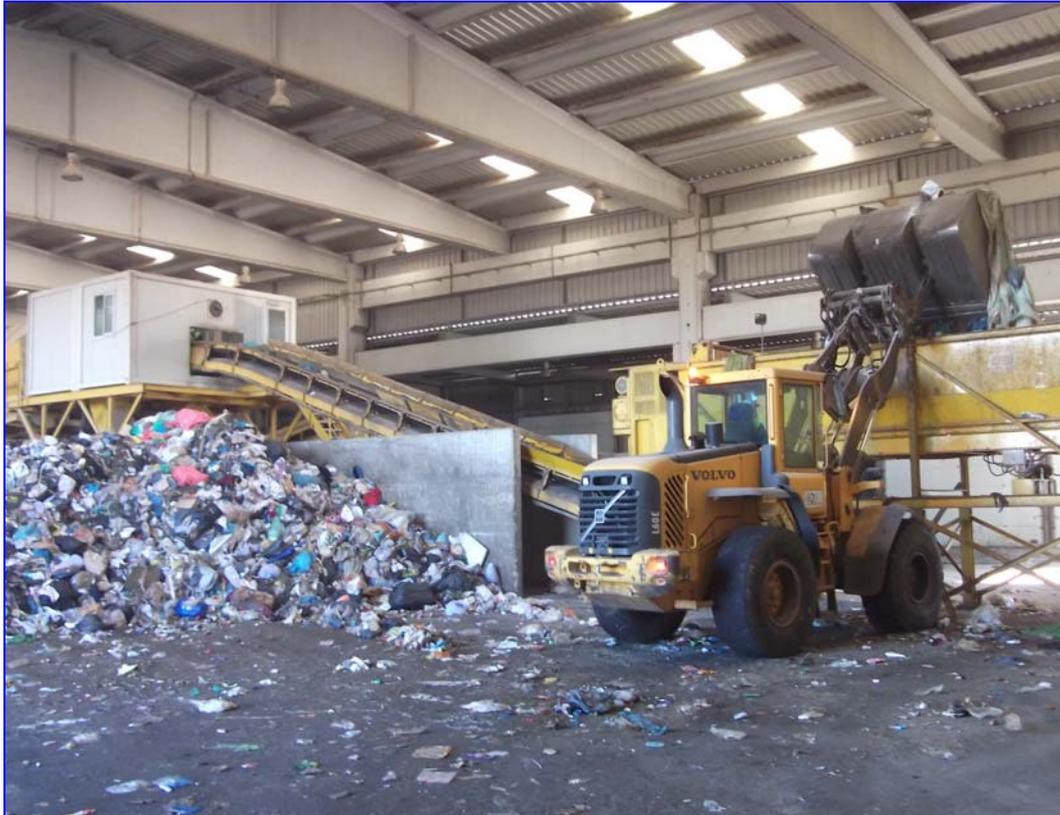
**Figura 3.8.** Pala cargando los RSU desde la playa al molino rompebolsas. Cinta transportadora a la cabina de triaje 1º manual
