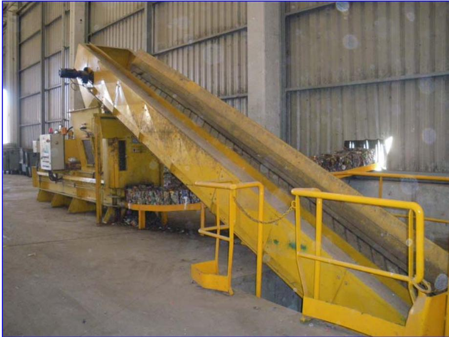
**Figura 3.17.** Prensa empacando balas de férricos
