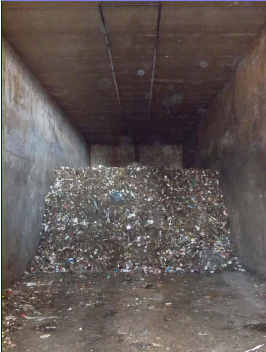
**Figura 3.19.** Residuo bruto constituido, en su mayor parte, por MO (<90mm) introducida en un túnel de fermentación. Sistema de riego del túnel.
