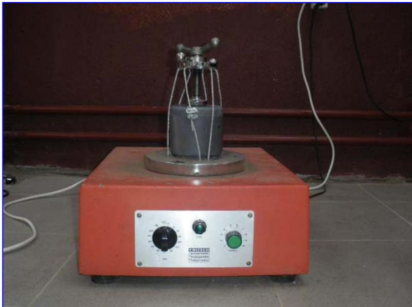
**Figura 3.42.** Molino de bolas FRITSCH, mod pulveristte en acción
