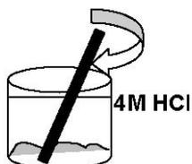
4.-Eliminar la capa de solución de ácido clorhídrico 4M del vaso de precipitado.
