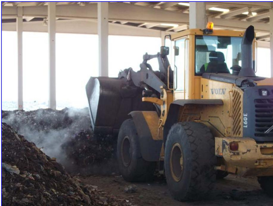
**Figura 3.20.** Formación de un cordón con RSU saliente del túnel de fermentación.
