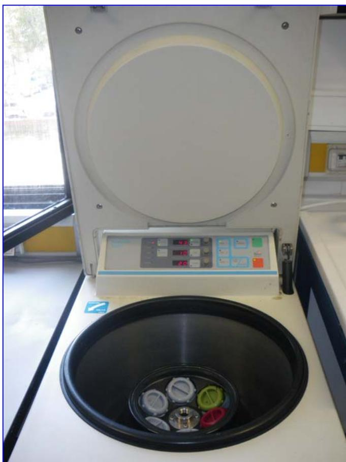
**Figura 3.40.** Centrifuga KUBOTA 6900 para analíticas de los lixiviados
