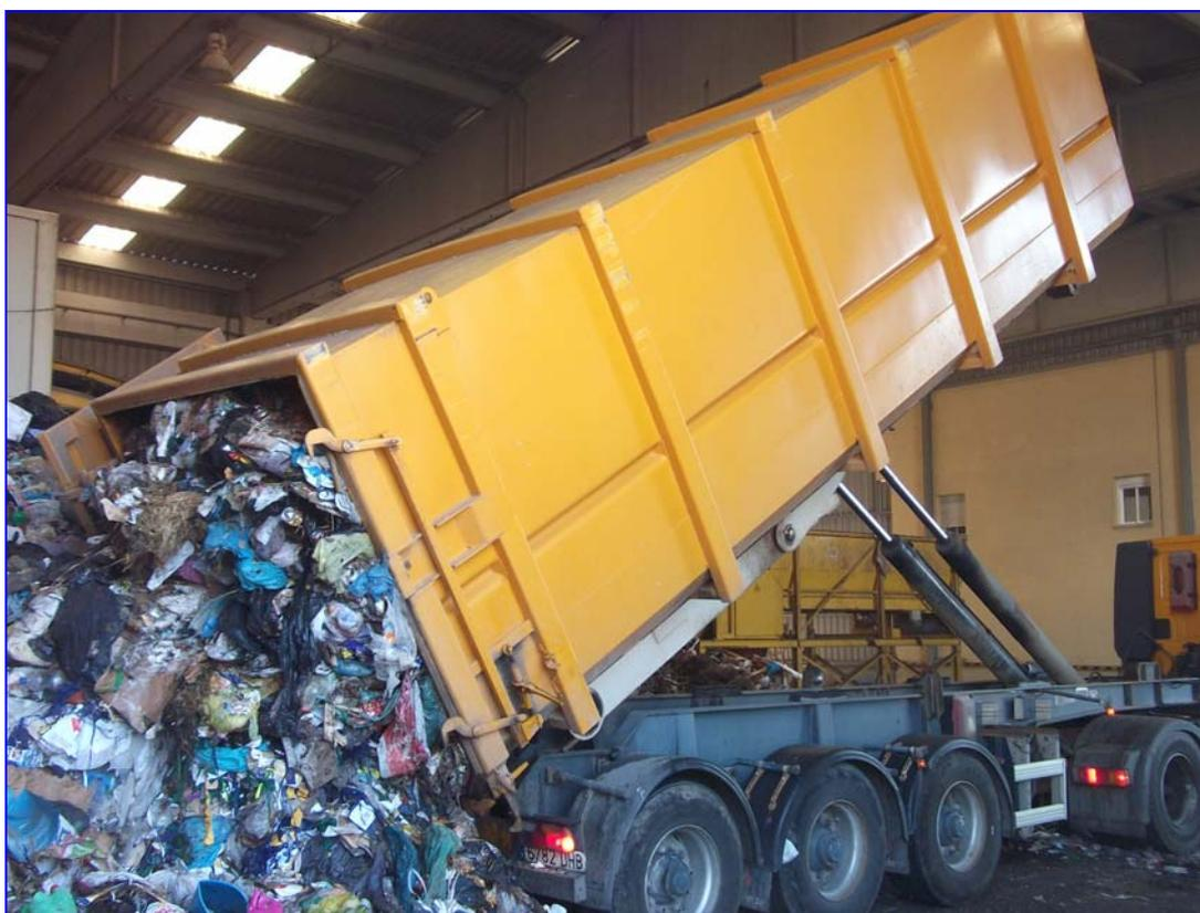
**Figura 3.7.** Playa de descarga. Vehículo de transferencia descargando RSU
