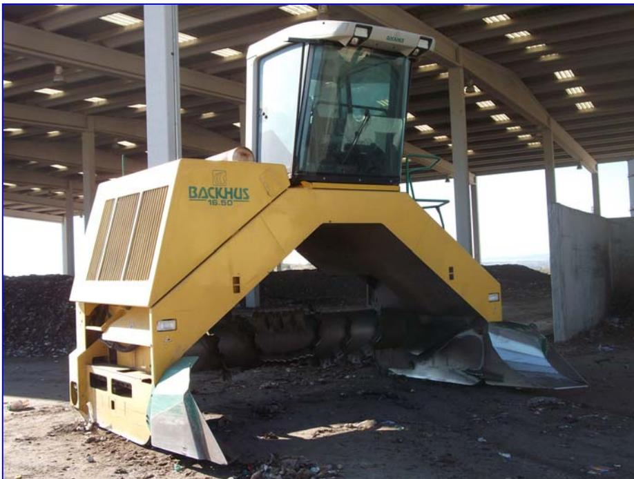
**Figura 3.22.** Volteadora del cordón en nave de maduración.
