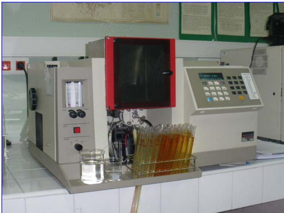
**Figura 3.44.** Espectrómetro de absorción atómico de llama PERKIN ELMER mod 3100
