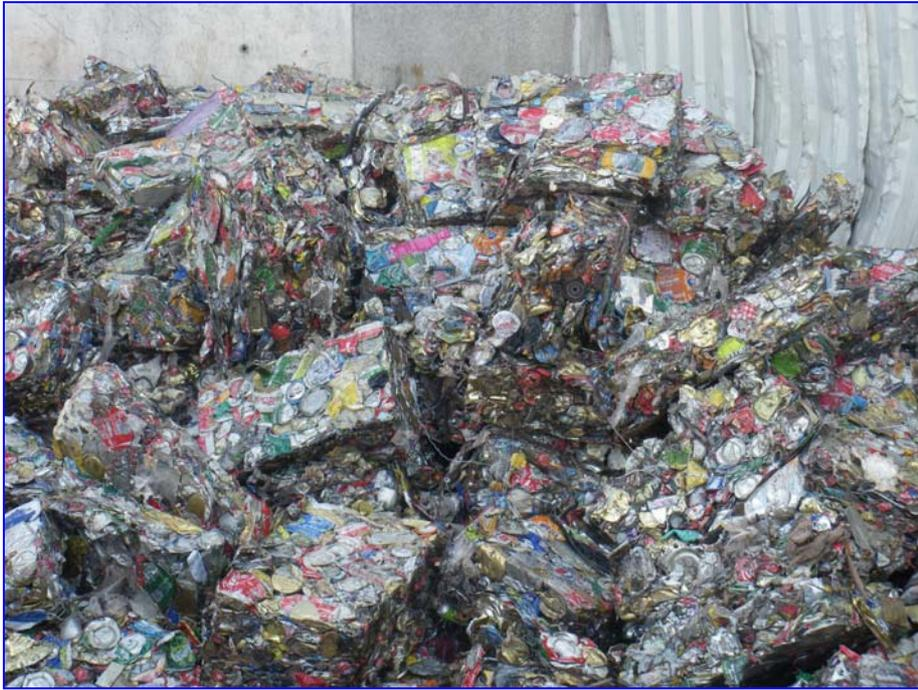
**Figura 3.15.** Balas de férricos almacenadas para recogida por un recuperador
