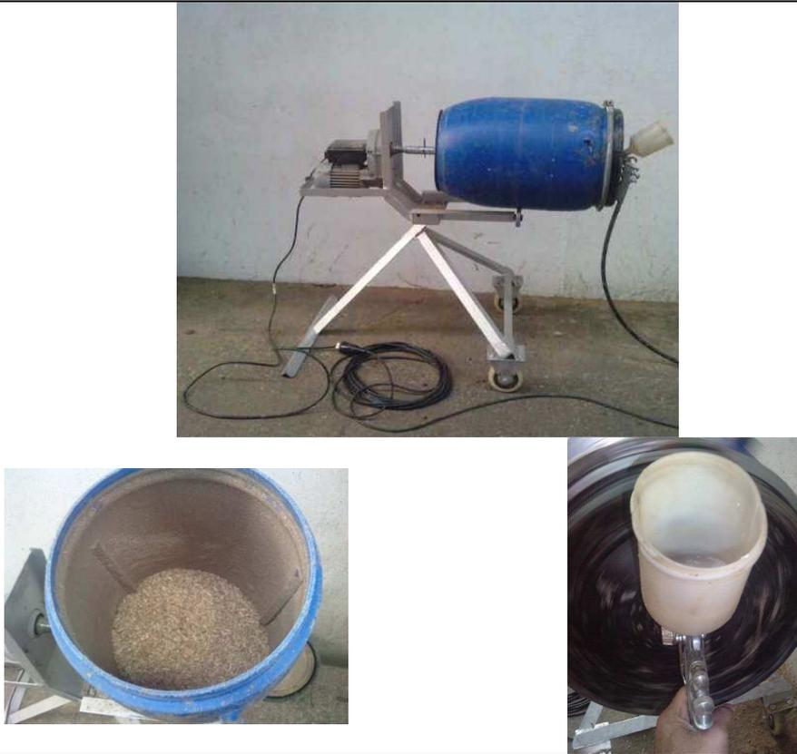
**Figura 19.** Fotografías del equipo utilizado en el encolado de las partículas de madera.
