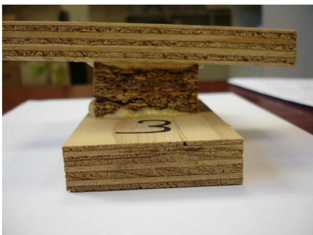
**Figura 56.** Probeta de tablero fabricado con cola **10705** tras el ensayo de cocción.
