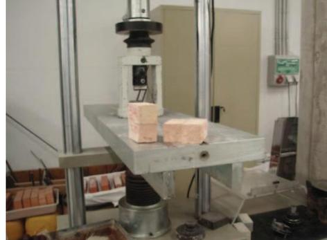
Rotura de la probeta a flexión
