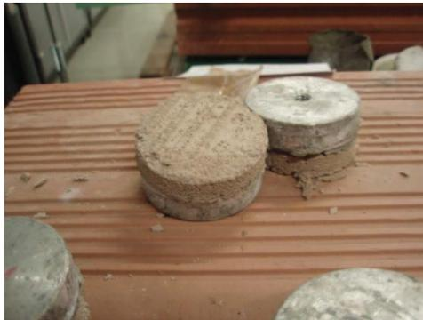
Probetas con la pastilla de tracción colocada
