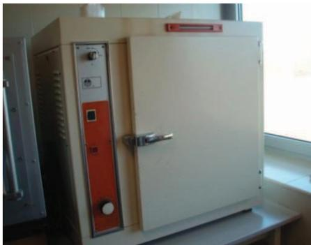
Horno de secado de las probetas
