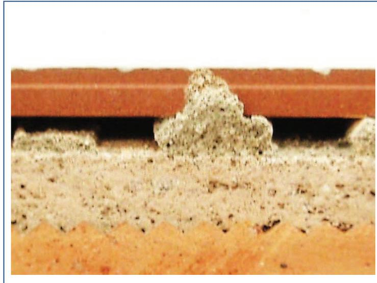
**Figura 7.8. Distribución homogénea del mortero sobre la superficie del ladrillo**
