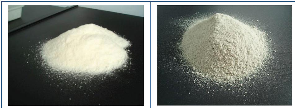
Figura 3.2. Espuma triturada tipo "A".
