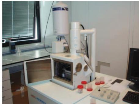
Microscopio electrónico de barrido
