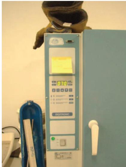
Probetas a 70°C durante 28 días en agua salina
