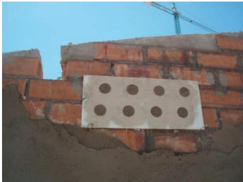
Plantilla y mortero para el ensayo de adhesión
