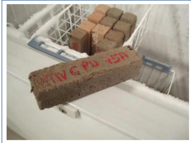
Figura 6.2. Daños mínimos de la muestra M IV-6PU75A
