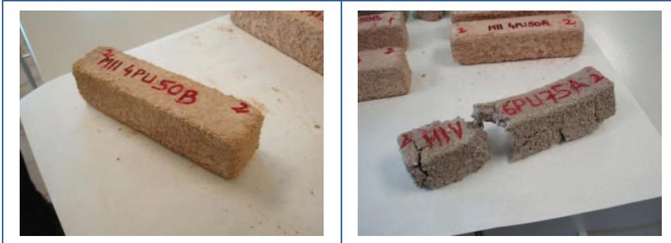
Figura 6.10. Degradación ligera (M II-4PU50B) y excesiva (M IV-6PU75A)
