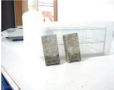
Altura penetración probetas sin aditivos
