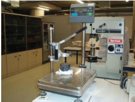
Balanza a "0", antes de la penetración
