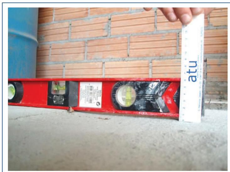
**Figura 7.4.** Descenso de 4 mm de la solera realizada con M IV-6PU75B
