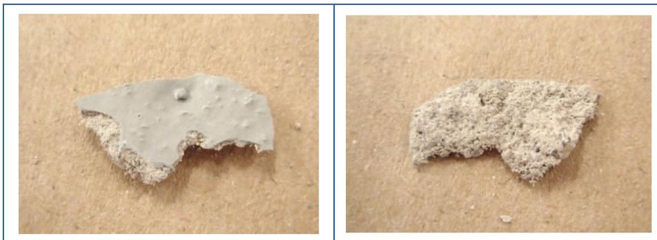
Figura 7.11. Adherencia entre revestimiento epoxi y mortero M IV-6PU75B
