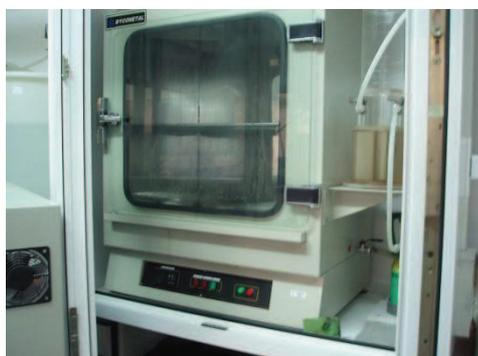
Cámara con humedad condensada
