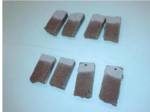
Altura penetración probetas con aditivos
