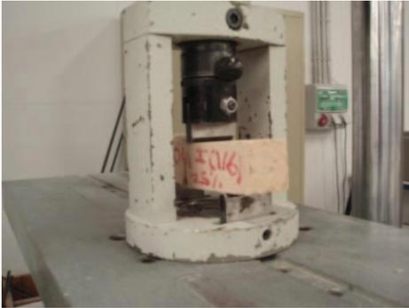
Dispositivo rotura y colocación de probeta
