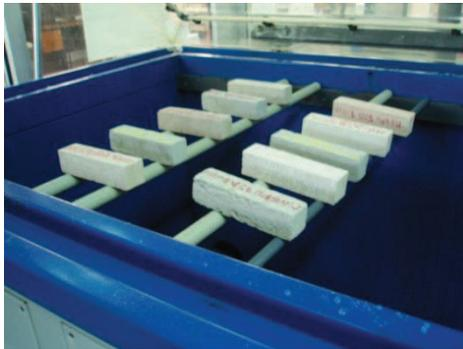
Probetas secas en la cámara
