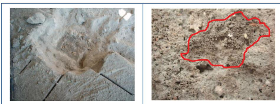
Figura 7.10. Testigo y plano de contacto solera de hormigón-mortero
