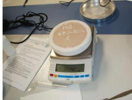
Sucesivas pesadas del molde y probeta
