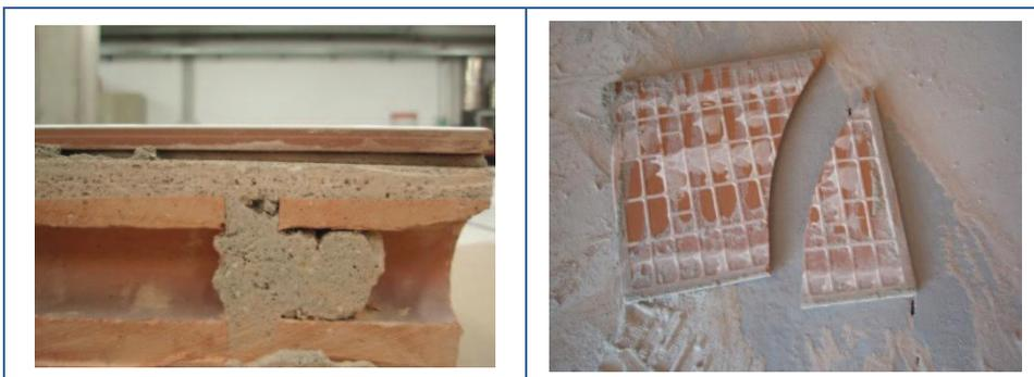
Figura 7.7. Buena adhesión del mortero a fábrica y adhesivo
