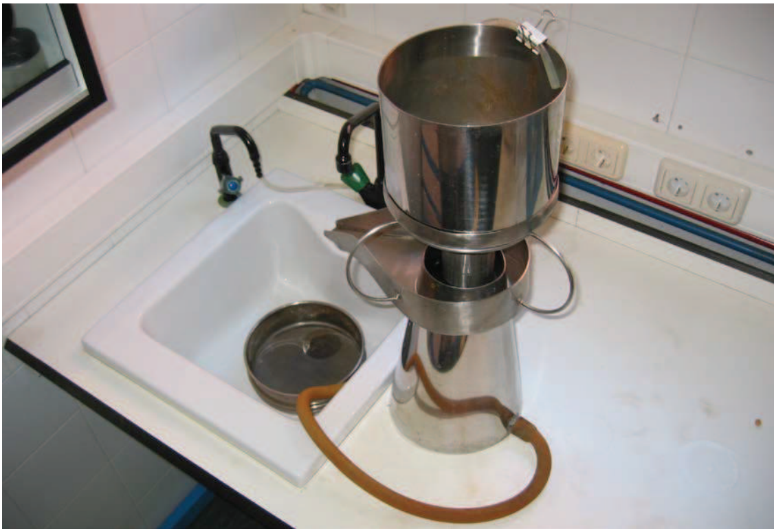
Figura 3.3.- Esquema de la jarra de Fenwick y fotografía de la utilizada en laboratorio.
