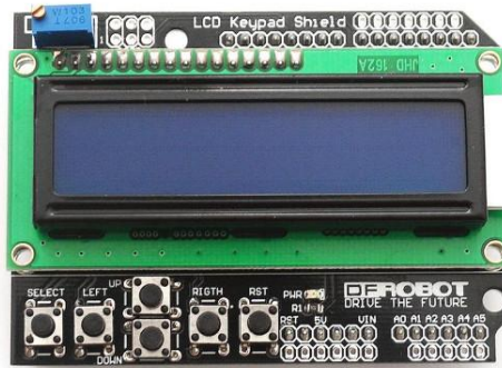
Ilustración 4. LCD Keypad Shield 16x2 HD44780 ( www.ajpdssoft.com ).
