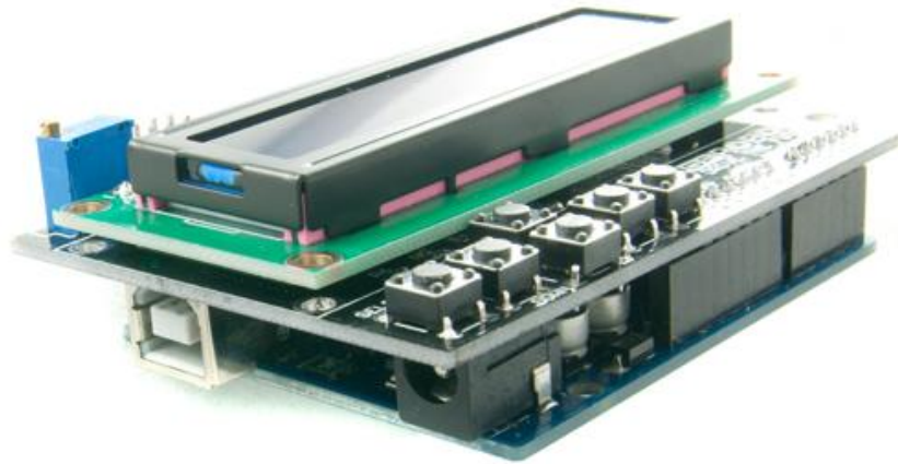
Ilustración 9. Shield LCD + Keypad en un Arduino UNO (www.ebay.com).
