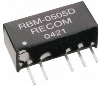
Figura 2. Convertidor DC/DC con aislamiento
