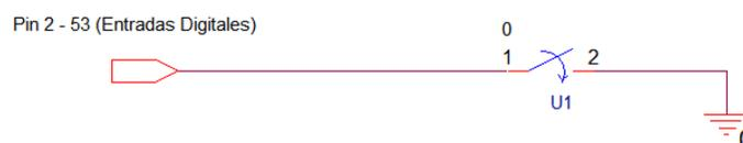
**Figura 45.** Esquema del conexionado eléctrico para comprobación de entradas digitales.
