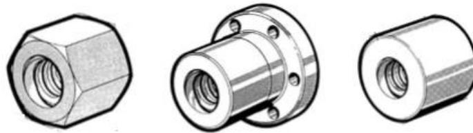
**Figura 91.** Formas de tuerca (Hexagonal, Con Valona, Cilíndrica)
