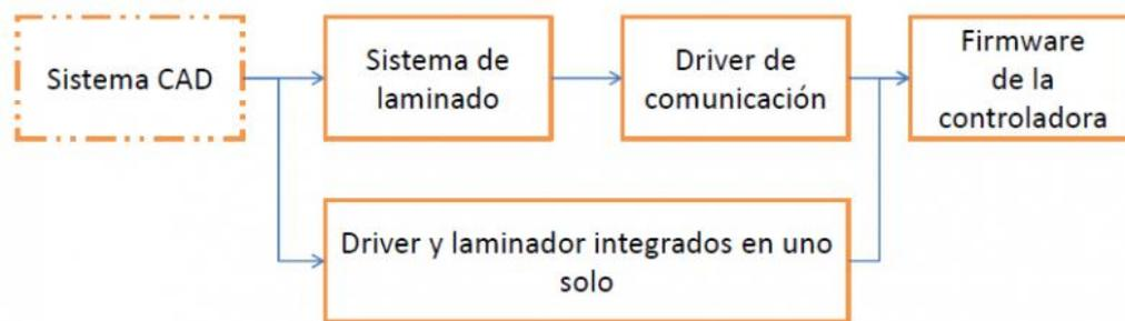
**Figura 5.** Diagrama de flujo de una impresora 3D RepRap
