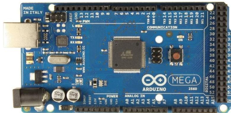
**Figura 44.** Detalle de la placa Arduino Mega 2560. Se observan numeradas las entradas/salidas.
