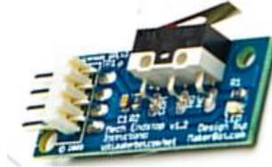
**Figura 13.** Final de carrera utilizado en la Impresora 3D
