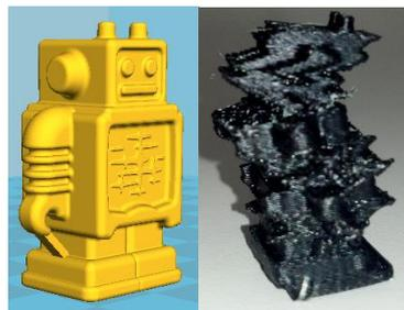
**Figura 52.** Comparación del resultado fallido de la impresión con respecto al diseño.
