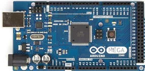
**Figura 9.** Placa Arduino Mega 2560
