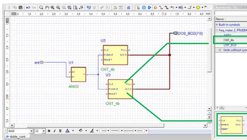
Al final se obtiene el diagrama de bloques deseado en un fichero .bde.
