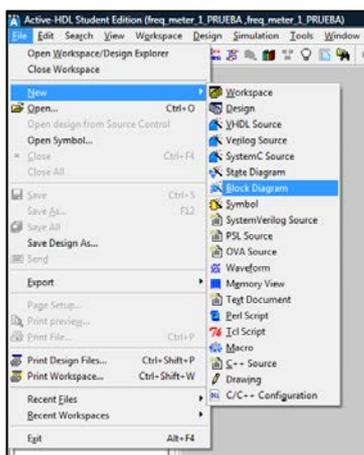
Se crea un nuevo diagrama de bloques. Mediante un asistente se pone nombre al diseño y se generan las entradas y salidas al diseño, al igual que la entidad en vhdl.
