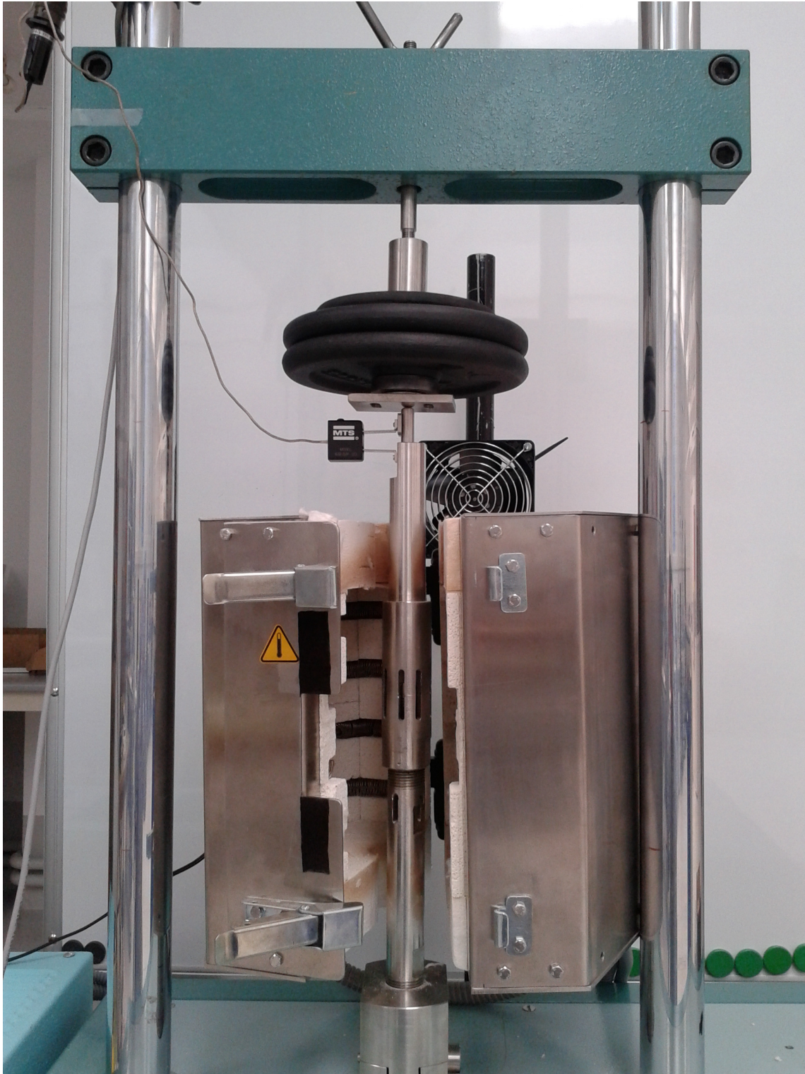
Figura 4.8. Equipo de ensayo SPCT.
