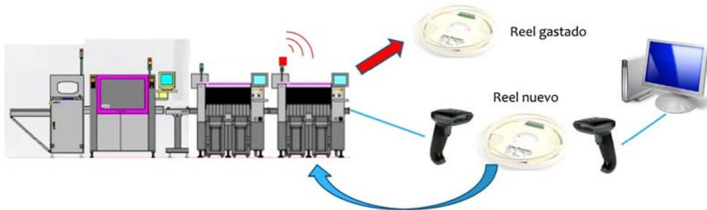
**Figura X.X. Reemplazo de componente SMD.**
