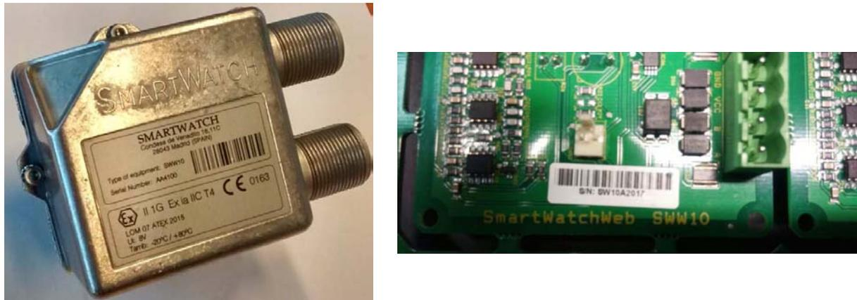
**Figura 7.16. Detalle serial PCB y envoltente sensor SWW**
