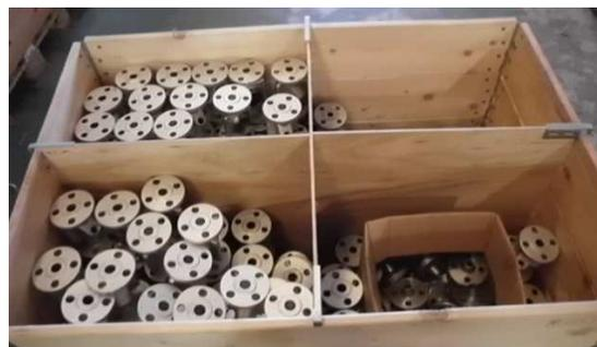
**Figura 7.27. Cajón reutilizable tamaño palé con separadores internos.**
