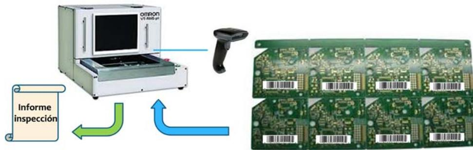
Figura 7.11. Lectura seriales placas electrónicas con máquina AOI.
