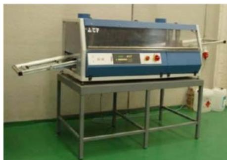
**Figura 7.22. Máquina de soldadura por Ola.**
