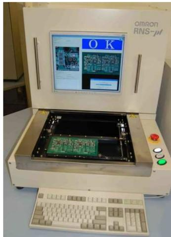
**Figura 7.5. Máquina de inspección óptica OMRON RNS-pt.**
