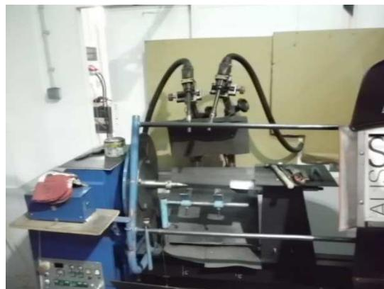
Figura 2.11. Máquina soldadura orbital.
