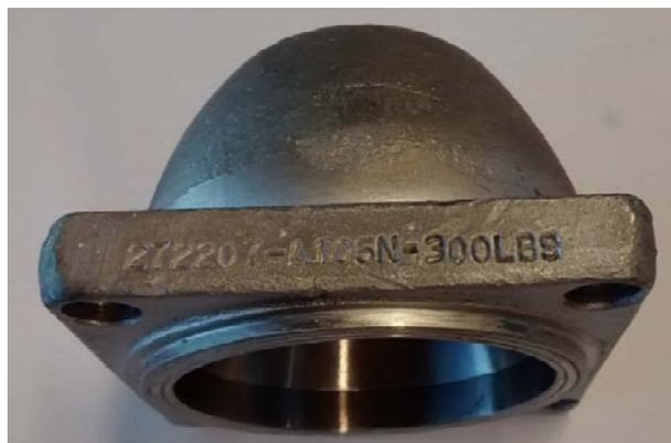
**Figura 7.15. Detalle número de colada en pieza forja.**
