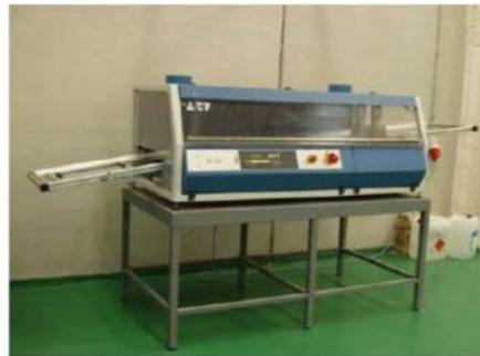
**Figura 2.21. Máquina de soldadura por ola.**
