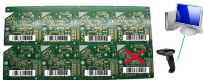
**Figura 7.21. Registro placa circuito electrónico SMD defectuoso.**
