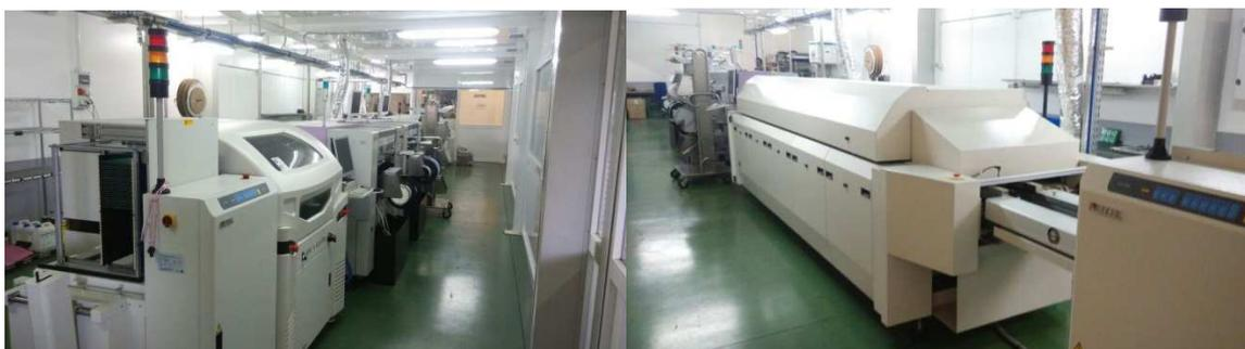
Figura 2.20. Detalle línea fabricación SMD.
