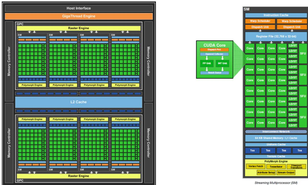
Figura i.3. Arquitectura de una tarjeta gráfica CUDA-enabled.
