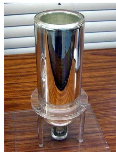
El calor de neutralización  $Q_r$  desprendido al mezclar el ácido y la base será absorbido por la disolución resultante (reactivos, productos de reacción, disolvente) y por el calorímetro (paredes, varilla agitadora, termómetro inmerso, etc...). Por tanto el calor  $Q_r$  se expresa como:
