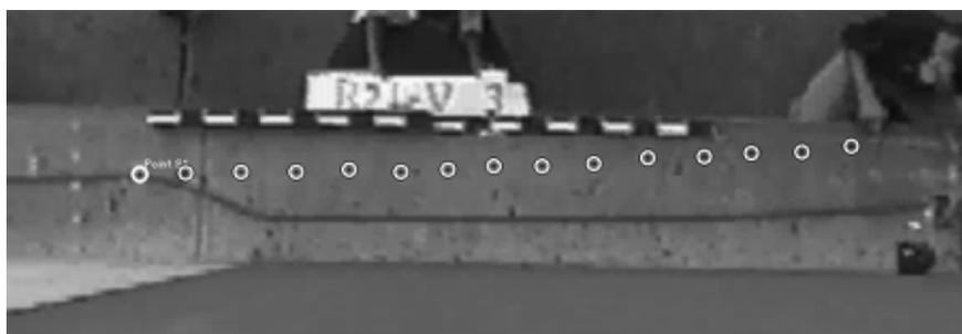
Figura 4.- Posiciones del pico del pulso que se propaga en un resorte tenso, en cada cuadro de la película ( $\Delta t = 0.033$  s), mediante el programa VideoPoint<sup>TM</sup>
