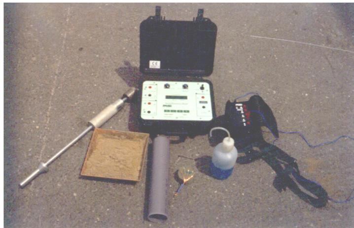
Figura 5.2. Material utilizado para las mediciones de resistividad sobre muestras de laboratorio.
