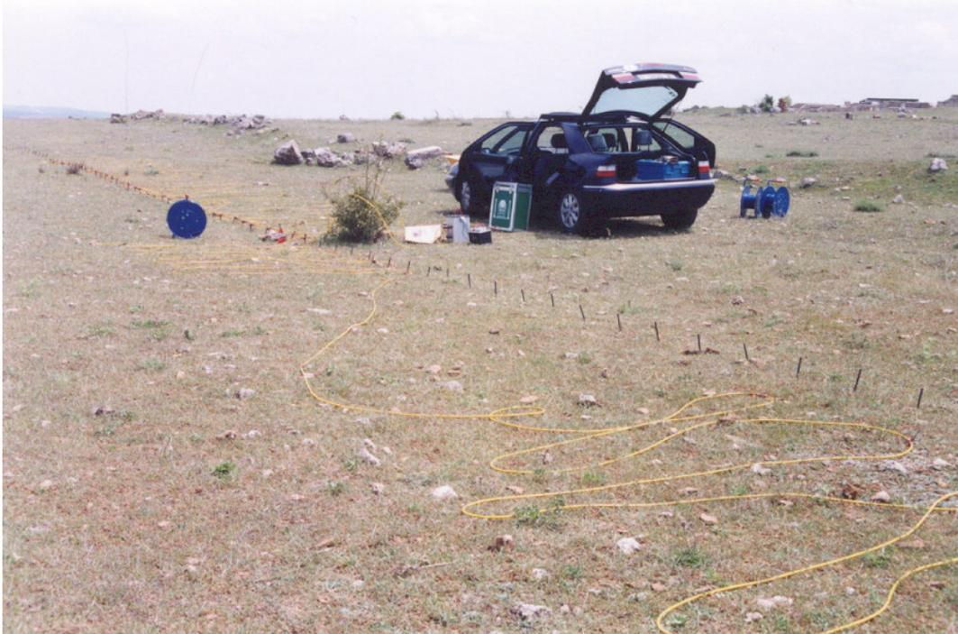
ARRIBA: Lugar que corresponde al centro de los perfiles Zona II. Se pueden distinguir los electrodos de corriente clavados cada 0,5 m y los cables multinodo que se irán conectando al dispositivo con separación creciente de 0,5 m a 5 m hasta completar 10 perfiles.
