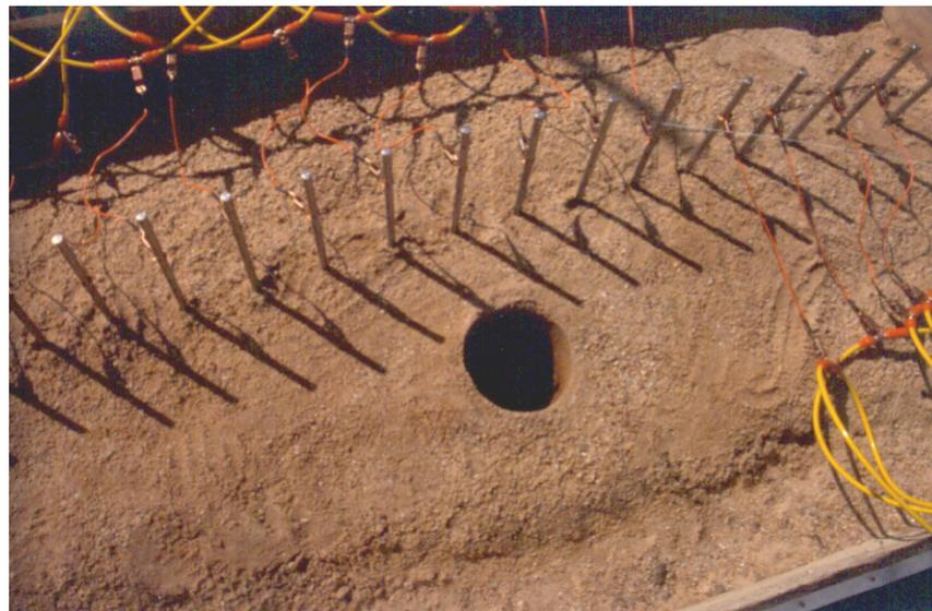
5.3.12.1.2 CILINDRO HUECO VERTICAL -a distancia 15 cm - **-Dispositivo Dipolo-dipolo-**
