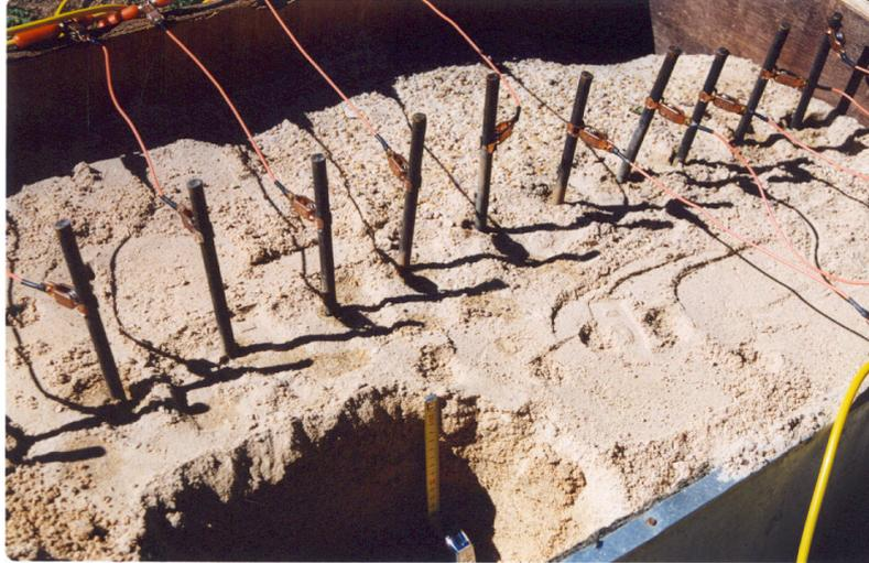
Se realizarán dos perfiles, uno con dispositivo Wenner y otro con dispositivo Dipolo-dipolo. Esto permitirá ver la diferencia de resolución entre ambos dispositivos.
