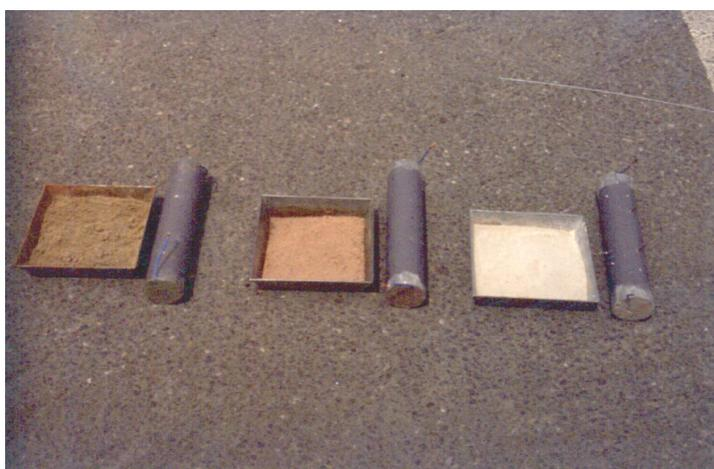
Figura 5.3. Muestras de arena de tres litologías distintas con su correspondiente probeta preparada. De izquierda a derecha: arena de playa, arena de río lavada y arena de facies Utrillas.
