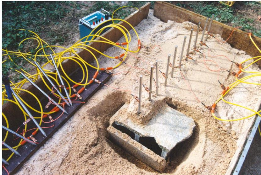
Las dimensiones de la anomalía coinciden en gran medida con el volumen interior del bloque de hormigón. Se admite, por tanto, que las paredes de hormigón se comportan como materiales con valores muy altos de resistividad, en torno a 2000 ohm.m, ya que el perímetro de la imagen resistiva (colores amarillo y pardo) representan esos valores.
