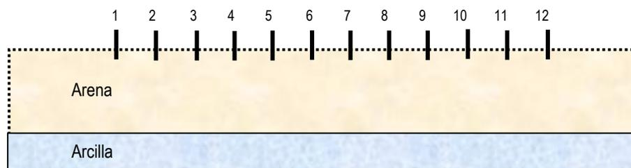
Se pretende determinar si el dispositivo es capaz de localizar y diferenciar el contacto entre esas dos formaciones y utilizar esta imagen para compararla con las de experiencias posteriores para identificar anomalías de resistividad que reflejen la presencia de objetos enterrados.
