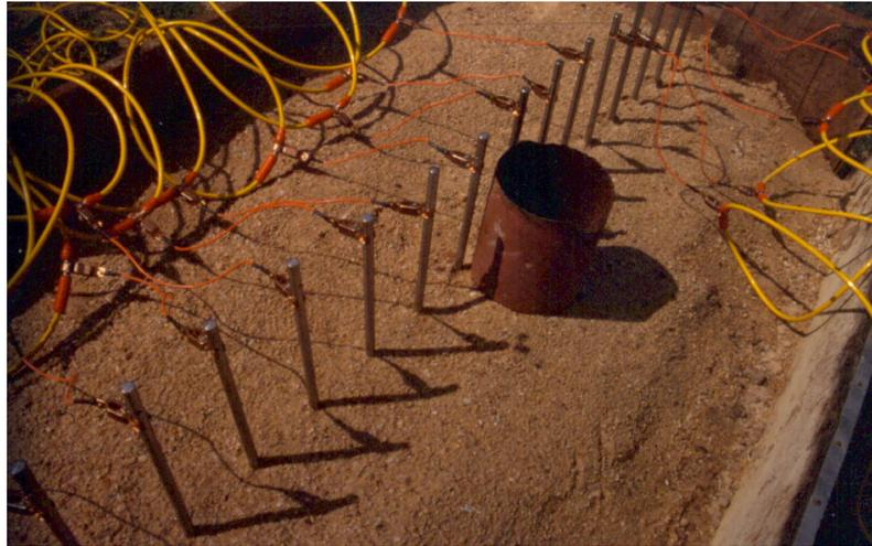
El máximo de esa curvatura está situado entre los electrodos nº9 y nº10, donde también es apreciable un máximo adelgazamiento de la capa resistiva de arena. Esta imagen recuerda los casos ya vistos de solapamiento de resistividad entre el estrato de arcilla conductor y un cuerpo enterrado también conductor (subapartado 5.3.7.1, experiencia 5: Tubo metálico 15 cm de diámetro -Dispositivo Wenner-).
