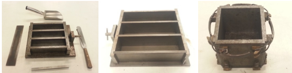
Figura 5.3: Molde de (40 \times 40 \times 160) mm 3 (izquierda), molde (100 \times 100 \times 275) mm 3 (centro), y molde (100 \times 100 \times 100) mm 3 (derecha).
