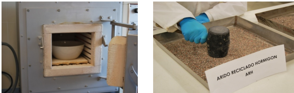
Figura 3.15: Introducción muestra mufla (dcha.). Separación mortero adherido (izq.).
