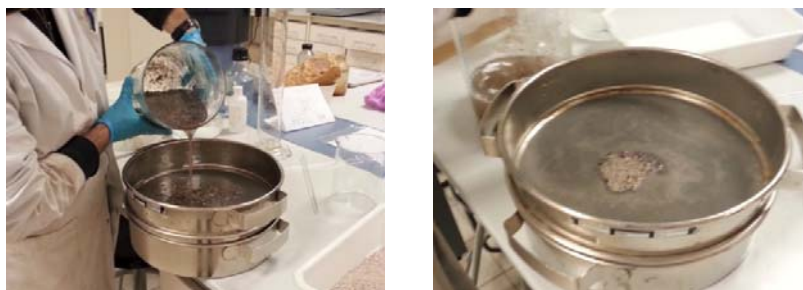
Figura 4.19: Decantado de precipitados y partículas retenidas.
