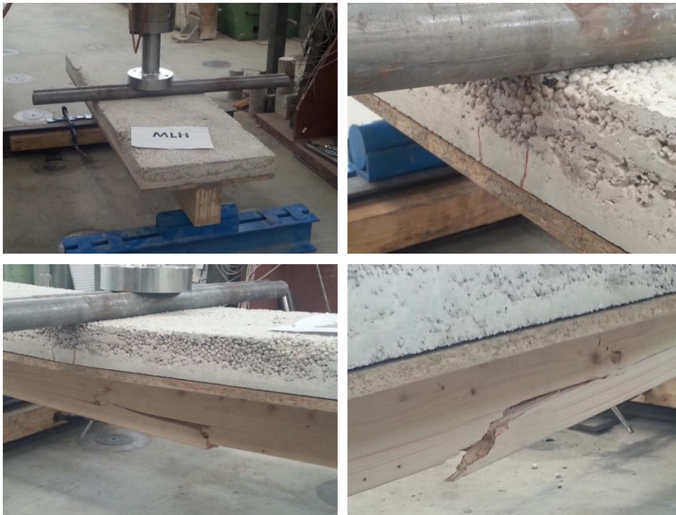
Figura 6.15: Fases ensayo rotura a flexión mortero MLH.
