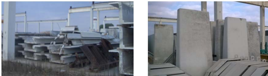
Figura 4.3: Acopios de los elementos prefabricados rechazados.
