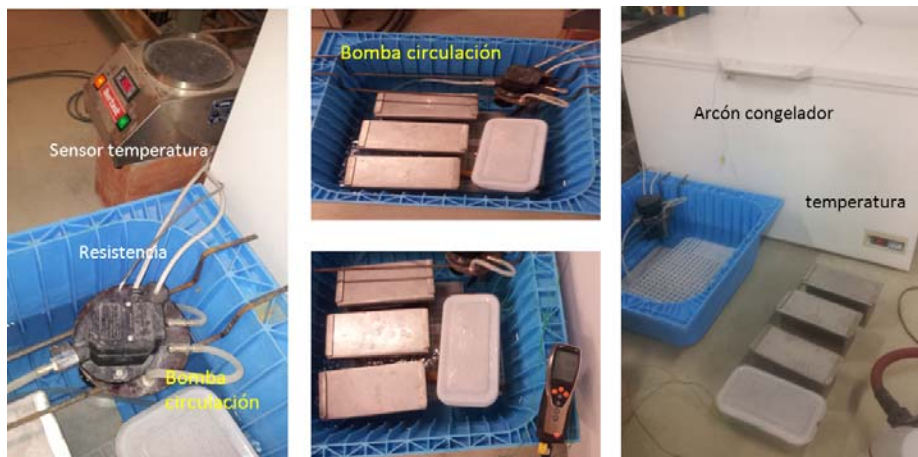
Figura 5.28: Equipo utilizado durante los ciclos de hielo-deshielo.
