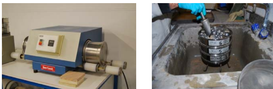
Figura 4.9: Máquina Micro-Deval (derecha). Lavado de la muestra (izquierda).
