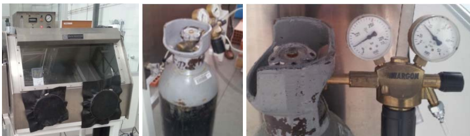
Figura 5.33: Equipos utilizados ensayo de carbonatación. Cámara estanca, botella CO 2 y reloj de medición del caudal de CO 2 .
