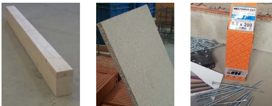
Figura 6.2: Vigueta de madera laminada, tablero aglomerado y conectores.
