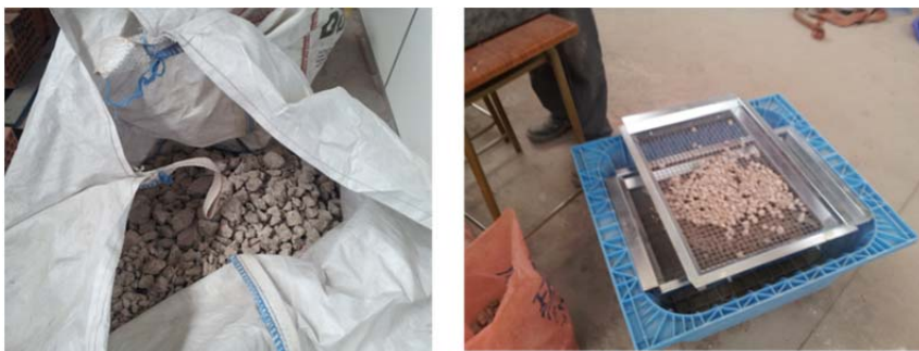
Figura 4.5: Sacas de transporte del árido reciclado y cribado manual.
