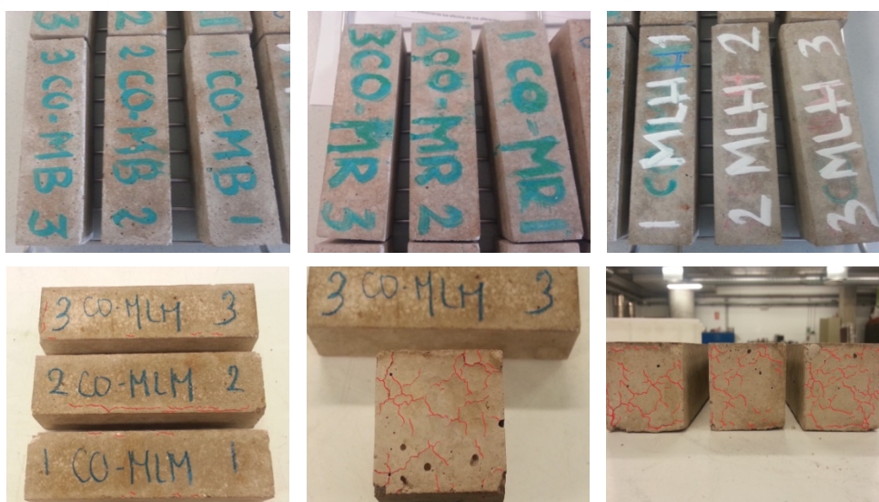
Figura 5.25: Probetas después ensayo soluciones salinas. Imagen superior probetas no alteradas. Imagen inferior probetas con fisuras.
