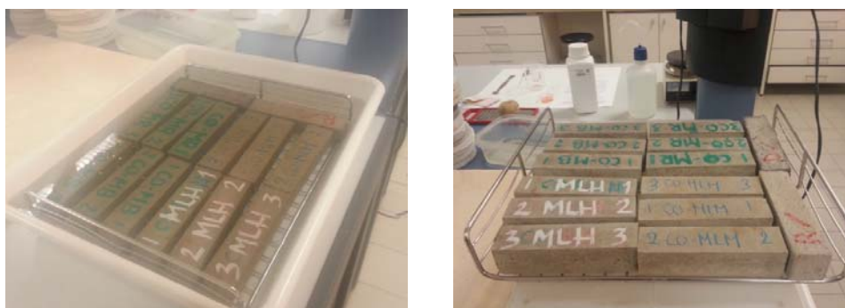
Figura 5.24: Probetas sumergidas en solución salina y proceso de enfriamiento.
