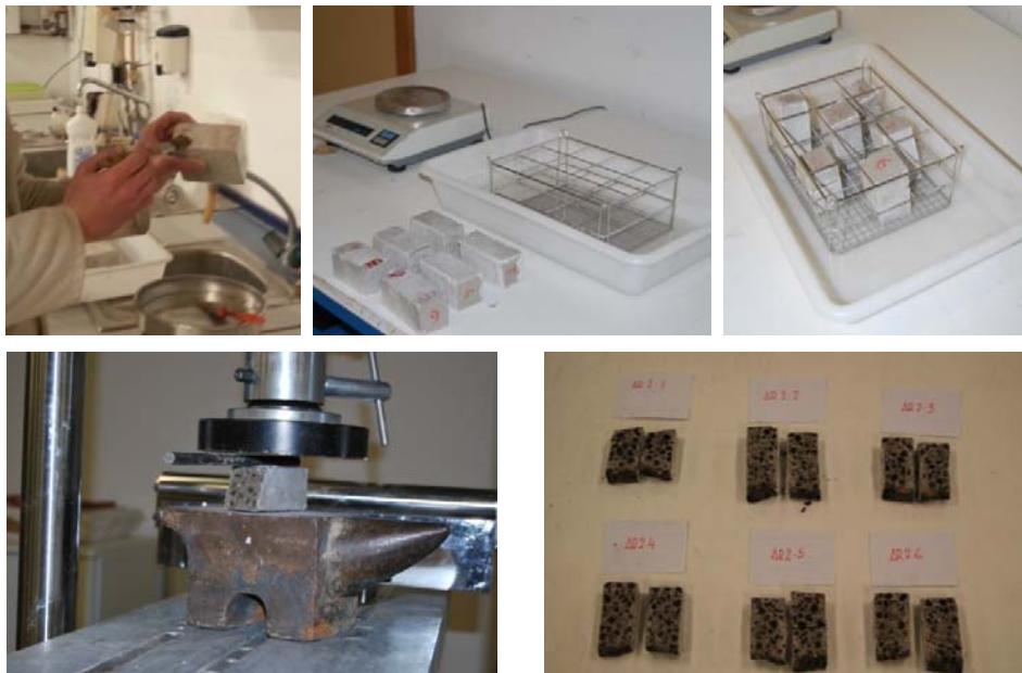
Figura 5.14: Proceso determinación del absorción por capilaridad y altura de penetración.
