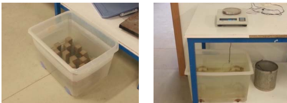
Figura 5.23: Probetas sumergidas. Báscula para determinar el peso de las probetas.
