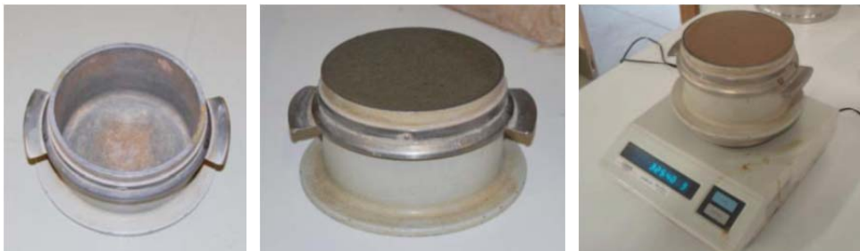
Figura 5.6 : Determinación de la densidad aparente del mortero fresco.
