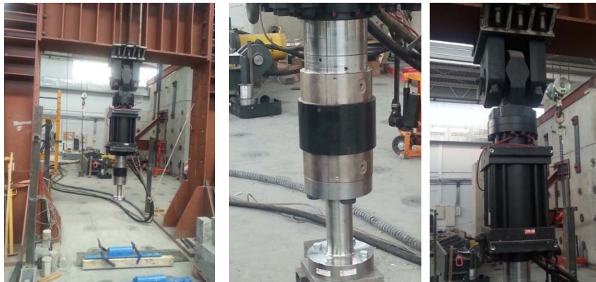
Figura 6.8: Prensa de 1000 KN. Detalle del actuador y del transductor.
