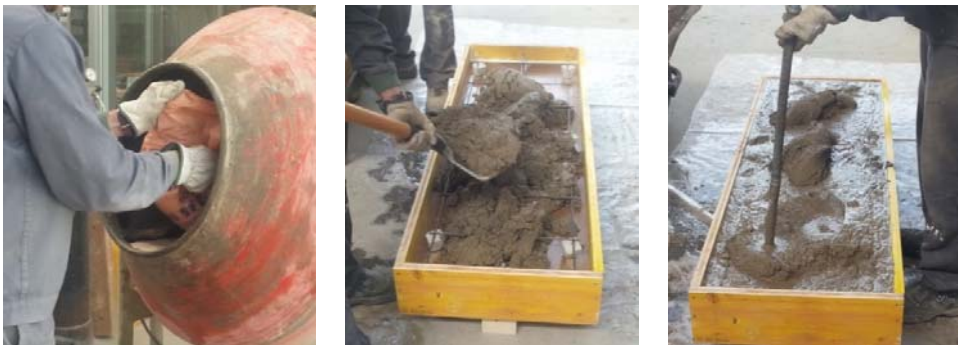
Figura 6.6: Proceso de amasado y vertido en el molde del forjado.
