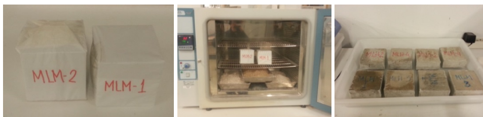
Figura 5.15: Preparación probetas y probetas en recipiente con agua.
