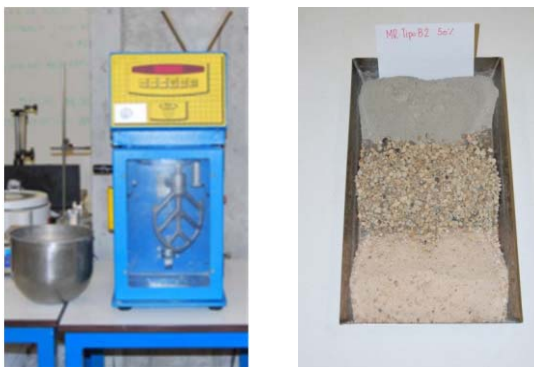
Figura 5.2: Amasadora mecánica (derecha). Preparación de los materiales (izquierda).
