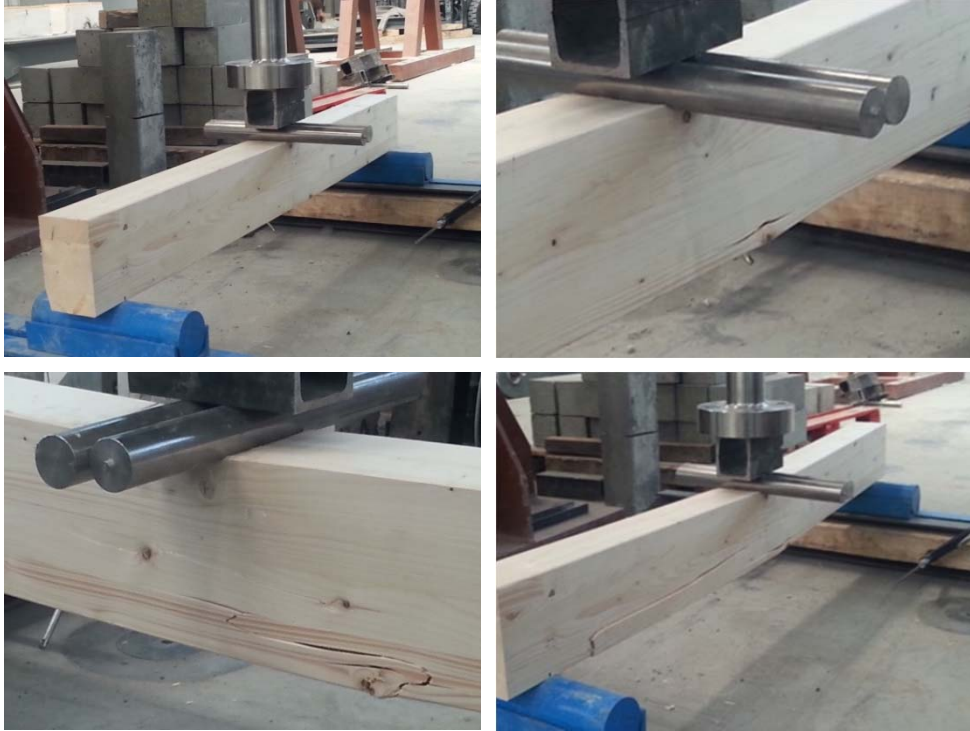
Figura 6.17: Fases ensayo rotura a flexión viga laminada GL24c.
