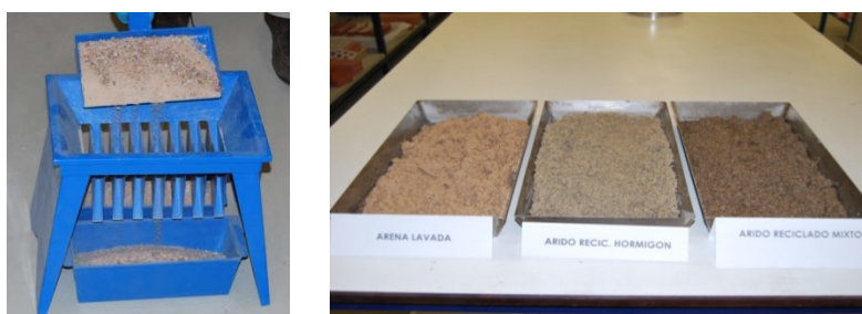
Figura 4.8: Preparación material ensayo friabilidad.
