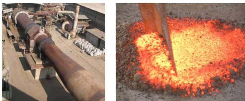
Figura 3.5: Horno rotario y arcilla expandida recién salida horno.
