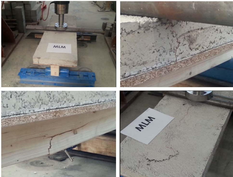
Figura 6.16: Fases ensayo rotura a flexión mortero MLM.
