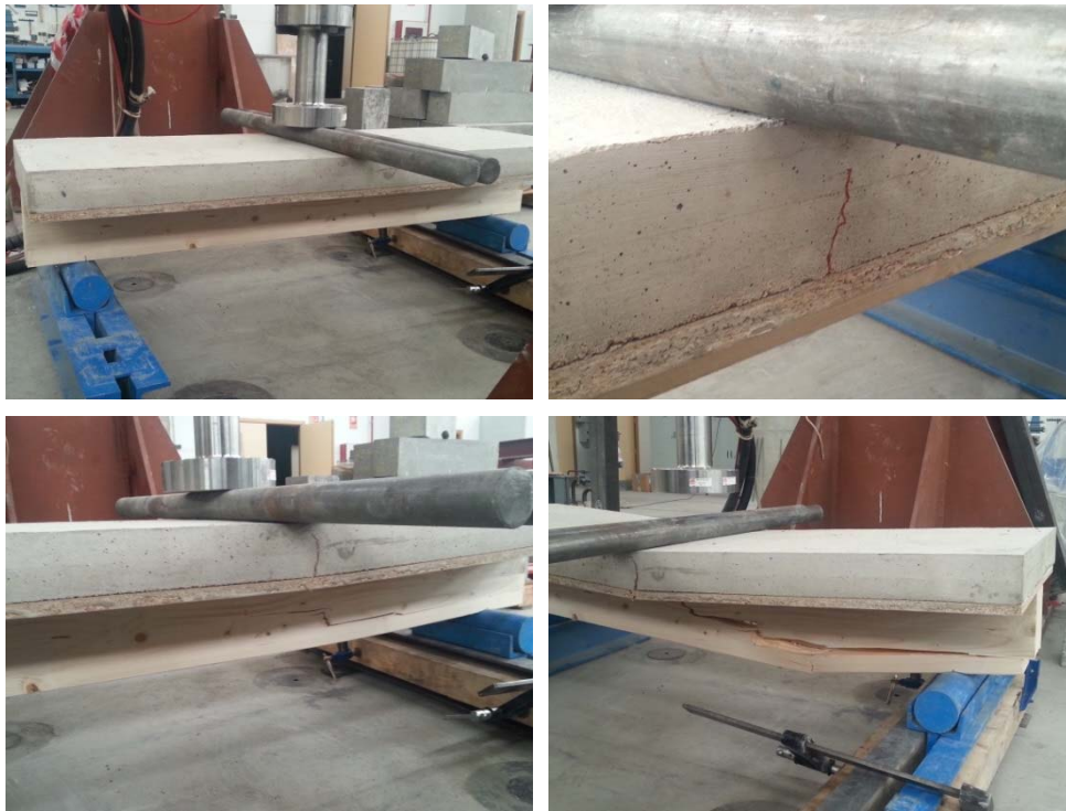
Figura 6.14: Fases ensayo rotura a flexión mortero base.
