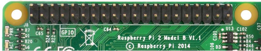
Figura 3.6: Detalle de los puertos GPIO de una Raspberry Pi Modelo 2B.
