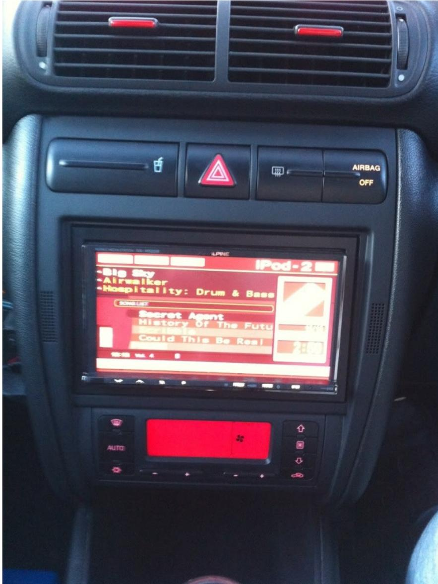
Figura 1.2: Implantación de una autorradio en un vehículo real.
