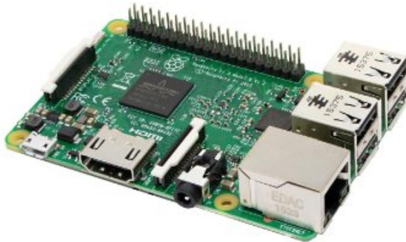
Figura 3.4: La placa Raspberry Pi es una de las placas de hardware de bajo coste más famosas, reconocidas y en auge. Hay infinidad de proyectos disponibles para ella.
