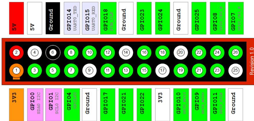
Figura 5.20: Esquema de los pines GPIO de la Raspberry Pi 3.
