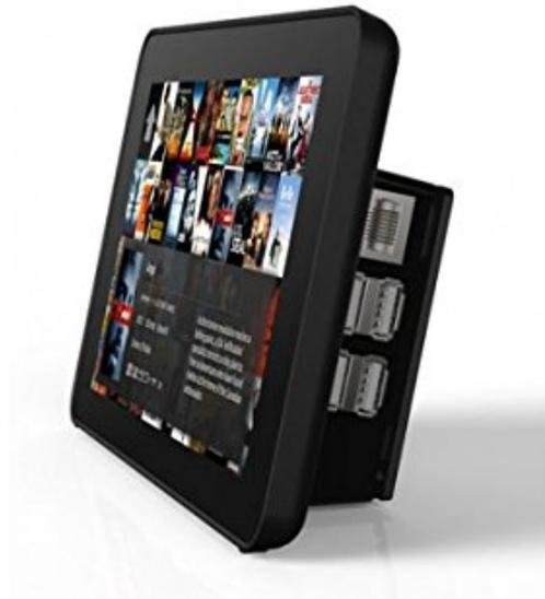
Figura 5.17: Pantalla táctil oficial para la Raspberry Pi 3 utilizada para este prototipo.
