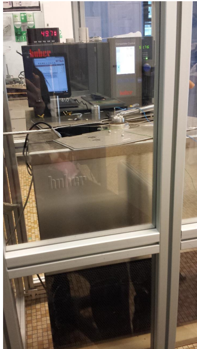
Figura 3. Situación del baño termostático en cuyo interior se encuentra la celda de medida de la velocidad del sonido a alta presión. Se observan en la parte superior del mismo los tres conectores eléctricos que conectan con el generador.
