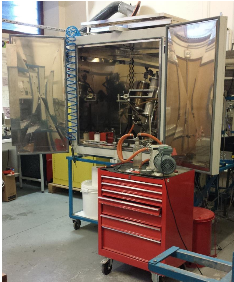
Figura 1. Vista general del viscosímetro de caída de cuerpo situado en el Laboratoire des Fluides Complexes et leurs Réservoirs de la Universidad de Pau (Francia).
