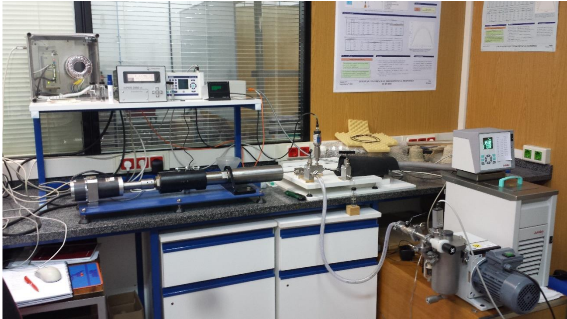
Figura 3. Vista general de los elementos para la medida de la densidad a alta presión en el Laboratorio de Ingeniería Energética de la Universidad de Burgos.
