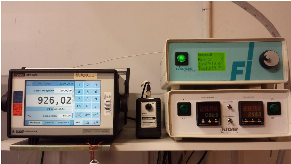
Figura 3. Dispositivos de regulación y control de presión y temperatura del ebullómetro.
