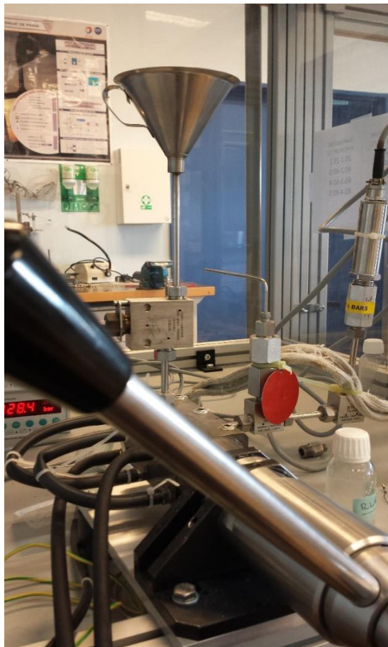
Figura 6. Dispositivo de llenado de la celda de medida de la velocidad del sonido a alta presión. En primer plano se aprecia la bomba manual, al fondo a la izquierda uno de los registradores de presión, y a la derecha el sensor de presión.
