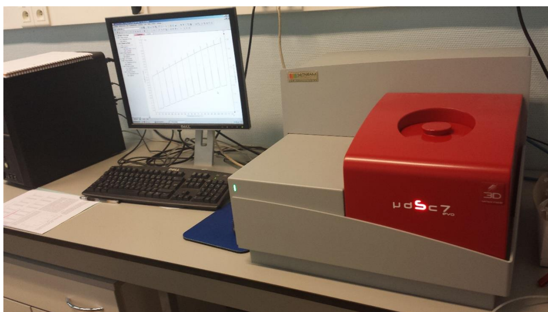
Figura 4. Calorímetro micro-DSC VII Evo de Setaram con el que se han determinado las capacidades caloríficas de las muestras a presión atmosférica.
