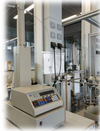
Reactores de alta presión
