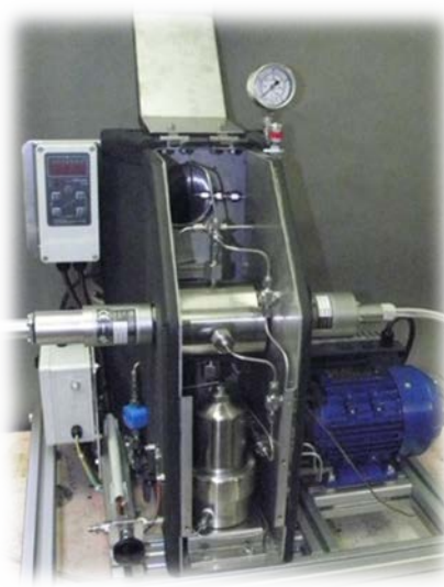
Equipo de determinación de equilibrio entre fases
