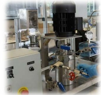
Reactores de alta presión
