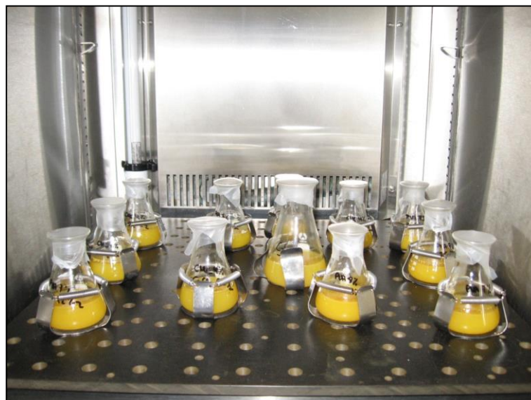
Fig. 3.4. Matracas con zumo natural de naranja y células de R. fascians inmovilizadas por atrapamiento en criogeles de PVA-PEG y perlas huecas de alginato de calcio bajo agitación orbital continua a 100 rpm y 25 °C.
