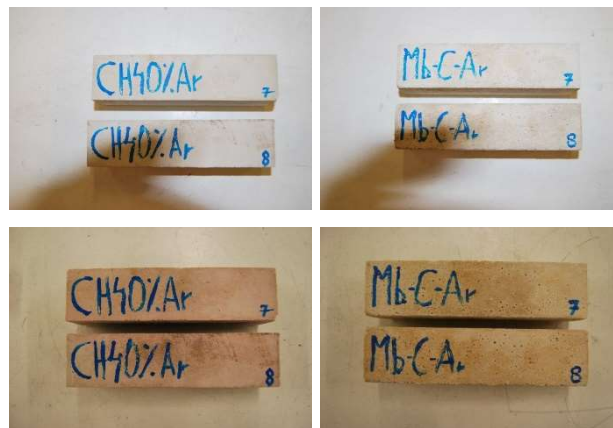
Figura 7.27 Inspección visual en el ensayo de agua salina de los morteros patrón con árido natural (NA). (Parte superior: antes de ensayo; Parte inferior: después del ensayo).
