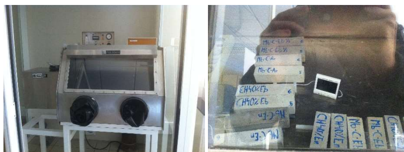
Figura 3.42 Realización del ensayo de carbonatación acelerada.
