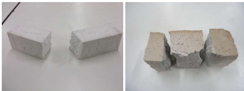
Figura 3.32 Probetas sometidas al ensayo de flexión y compresión.
