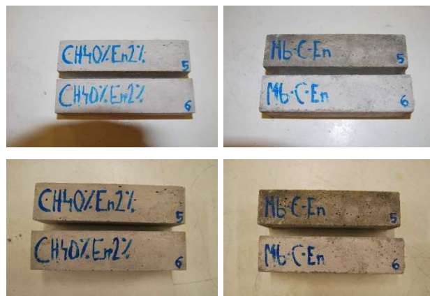
Figura 7.22 Inspección visual en el ensayo de carbonatación acelerada de los morteros definitivos de fábrica. (Parte superior: antes de ensayo; Parte inferior: después del ensayo).
