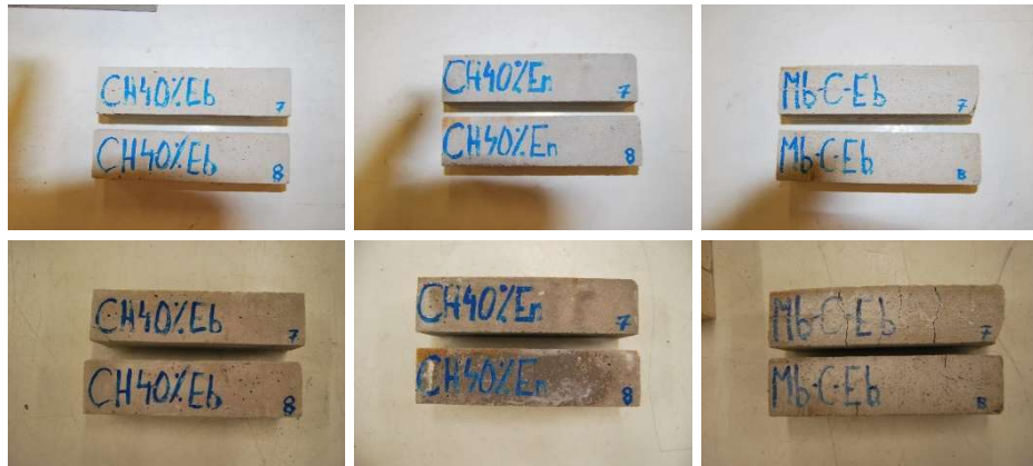
Figura 7.28 Inspección visual en el ensayo de agua salina de los morteros patrón con áridos siderúrgicos (LF y EAF). (Parte superior: antes de ensayo; Parte inferior: después del ensayo).
