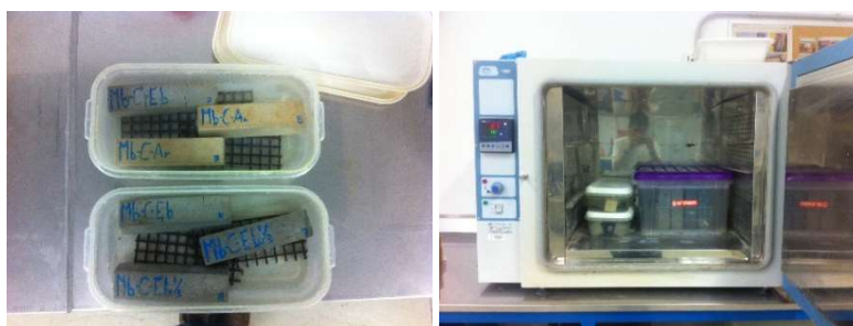
Figura 3.44 Realización del ensayo de agua salina.
