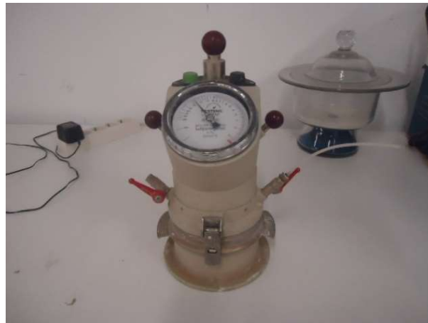
Figura 3.8 Determinación del aire ocluido.
