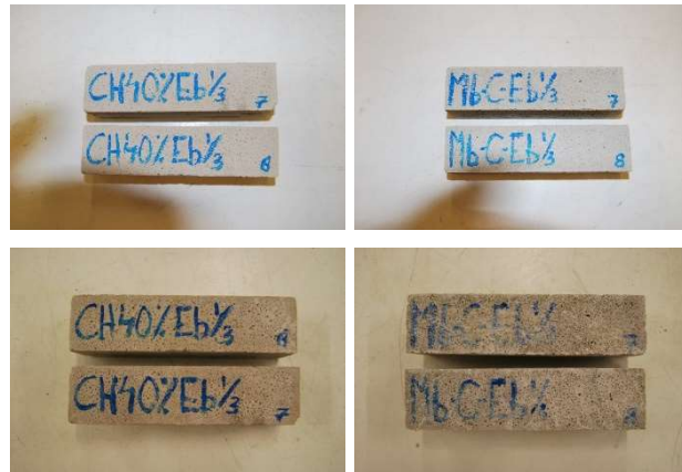
Figura 7.29 Inspección visual en el ensayo de agua salina de los morteros definitivos de revestimiento. (Parte superior: antes de ensayo; Parte inferior: después del ensayo).
