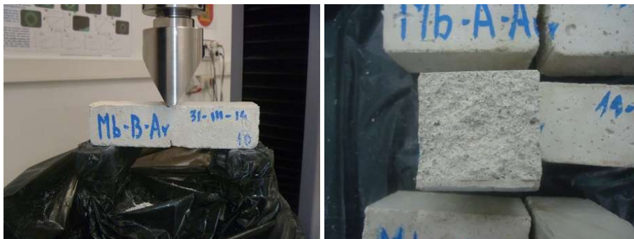
Figura 3.28 Probeta previamente entallada dispuesta en la máquina de ensayo (izquierda) y ligamento resistente de la probeta ensayada a fractura (derecha).
