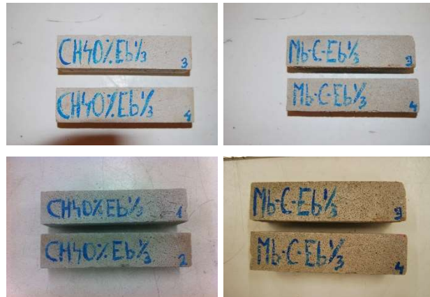
Figura 7.17 Inspección visual en el ensayo de choque térmico de los morteros definitivos de revestimiento. (Parte superior: antes de ensayo; Parte inferior: después del ensayo).
