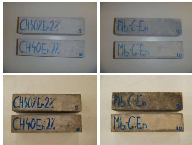
Figura 7.34 Inspección visual en el ensayo Kesternich de los morteros definitivos de fábrica. (Parte superior: antes de ensayo; Parte inferior: después del ensayo).
