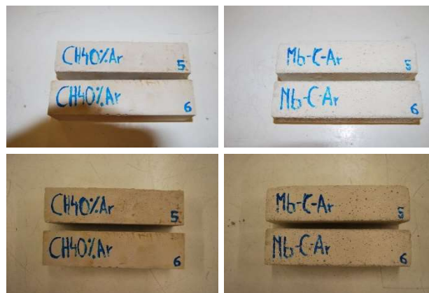
Figura 7.19 Inspección visual en el ensayo de carbonatación acelerada de los morteros patrón con árido natural (NA). (Parte superior: antes de ensayo; Parte inferior: después del ensayo).
