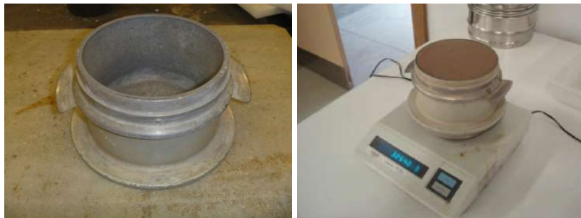
Figura 3.7 Molde densidad aparente (Capacidad 1 \text{ dm}^3 ). Determinación de la densidad aparente del mortero fresco.
