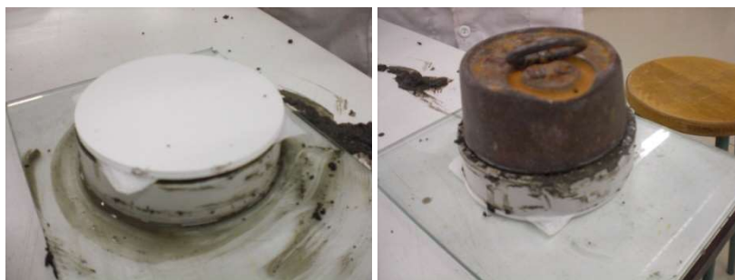
Figura 3.10 Procedimiento de ensayo para la determinación de la retención de agua.
