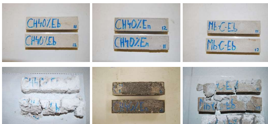
Figura 7.36 Inspección visual en el ensayo de cristalización de sales de los morteros patrón con áridos siderúrgicos (LF y EAF). (Parte superior: antes de ensayo; Parte inferior: después del ensayo).
