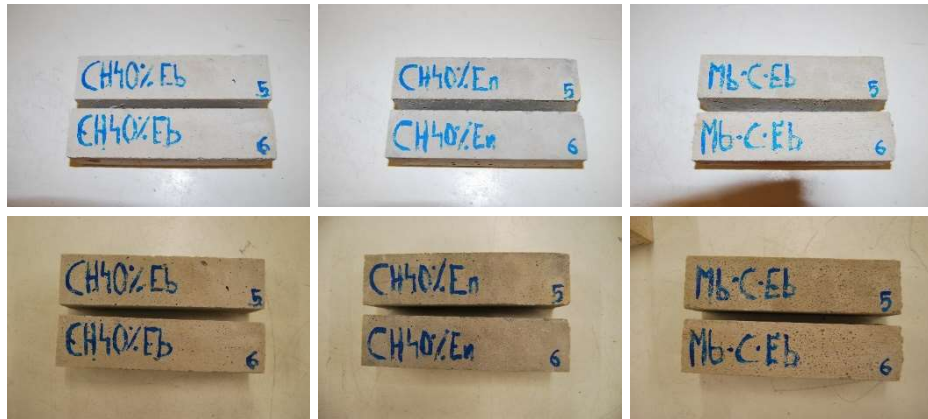
Figura 7.20 Inspección visual en el ensayo de carbonatación acelerada de los morteros patrón con áridos siderúrgicos (LF y EAF). (Parte superior: antes de ensayo; Parte inferior: después del ensayo).
