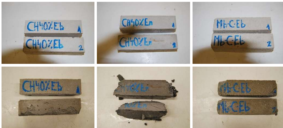
Figura 7.12 Inspección visual en el ensayo de heladicidad de los morteros patrón con áridos siderúrgicos (LF y EAF). (Parte superior: antes de ensayo; Parte inferior: después del ensayo).
