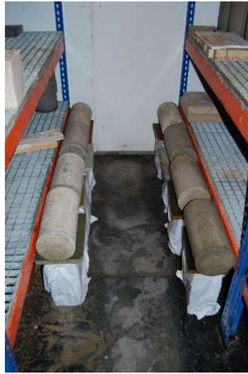
Figura 3.37 Probetas en proceso de curado en bolsas de polietileno y con carga.
