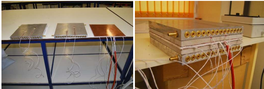
Figura 3.19 Placas de ensayo con sonda de medición (izquierda) y muestras colocadas entre las mismas (derecha).
