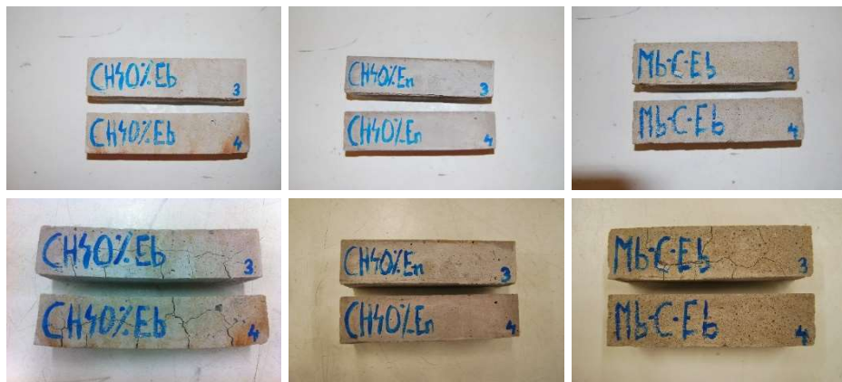
Figura 7.16 Inspección visual en el ensayo de choque térmico de los morteros patrón con áridos siderúrgicos (Parte superior: antes de ensayo; Parte inferior: después del ensayo).
