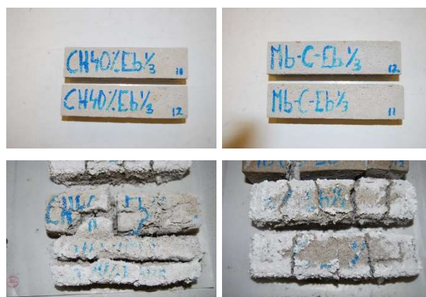
Figura 7.37 Inspección visual en el ensayo de cristalización de sales de los morteros definitivos de revestimiento. (Parte superior: antes de ensayo; Parte inferior: después del ensayo).
