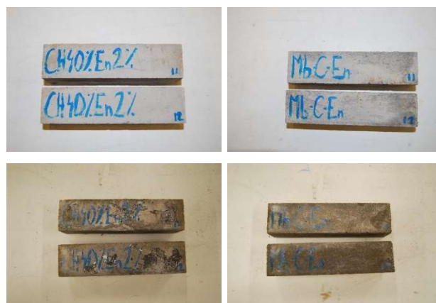
Figura 7.38 Inspección visual en el ensayo de cristalización de sales de los morteros definitivos de fábrica. (Parte superior: antes de ensayo; Parte inferior: después del ensayo).
