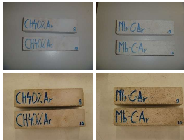
Figura 7.31 Inspección visual en el ensayo Kesternich de los morteros patrón con árido natural (NA). (Parte superior: antes de ensayo; Parte inferior: después del ensayo).
