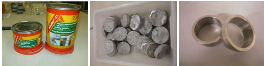
Figura 3.33 Adhesivo, pastillas para realizar el ensayo y cilindros.
