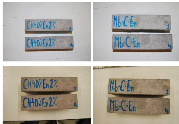
Figura 7.18 Inspección visual en el ensayo de choque térmico de los morteros definitivos de fábrica. (Parte superior: antes de ensayo; Parte inferior: después del ensayo).
