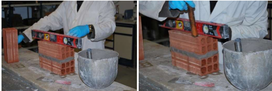
Figura 8.8 Realización de la fábrica de albañilería. Octubre 2016.
