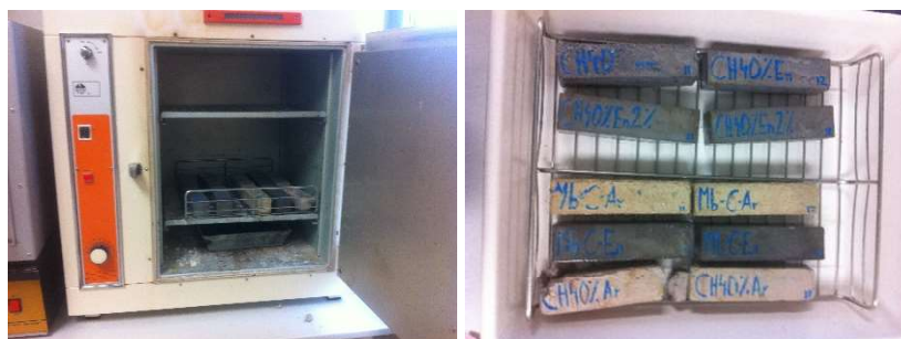
Figura 3.46 Realización del ensayo de cristalización de sales.
