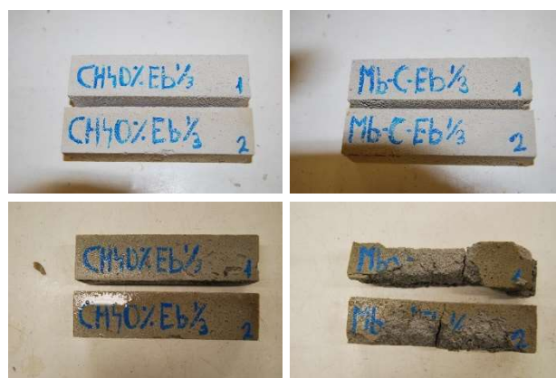
Figura 7.13 Inspección visual en el ensayo de heladicidad de los morteros definitivos de revestimiento. (Parte superior: antes de ensayo; Parte inferior: después del ensayo).
