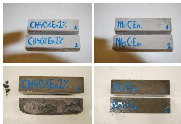
Figura 7.14 Inspección visual en el ensayo de heladicidad de los morteros definitivos de fábrica. (Parte superior: antes de ensayo; Parte inferior: después del ensayo).
