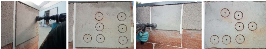
Figura 8.6 Realización de discos. Muestra CH40EAF+2%MR2100 (izquierda) y BAS-C-EAF (derecha).
