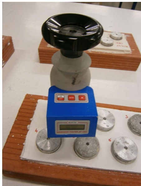
Figura 3.34 Ensayo de adherencia para morteros en estado endurecido.
