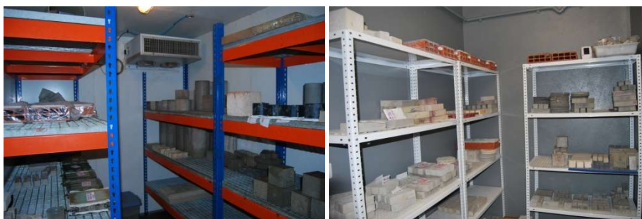
Figura 5.6 Cámara húmeda (izquierda) y cámara de curado (derecha).
