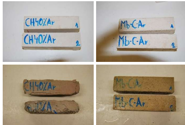
Figura 7.11 Inspección visual en el ensayo de heladicidad de los morteros patrón con árido natural (NA). (Parte superior: antes de ensayo; Parte inferior: después del ensayo).
