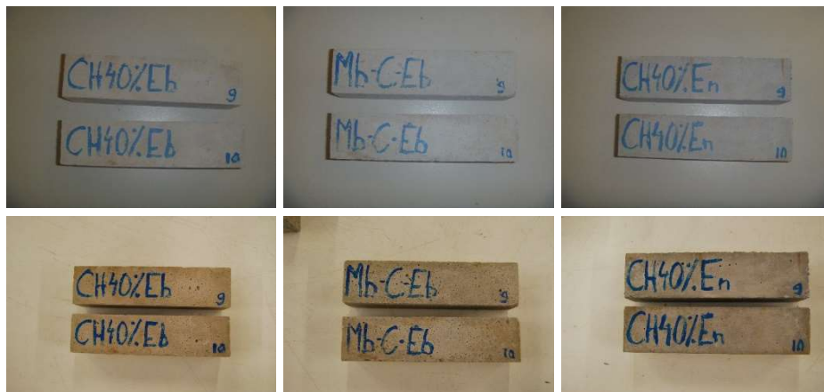
Figura 7.32 Inspección visual en el ensayo Kesternich de los morteros patrón con áridos siderúrgicos (LF y EAF). (Parte superior: antes de ensayo; Parte inferior: después del ensayo).
