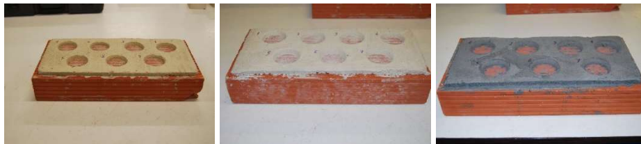
Figura 6.1 Muestra del ensayo de adherencia de mortero con Árido Natural (NA), Escoria Blanca (LF) y Escoria Negra (EAF).
