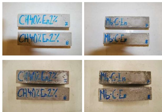
Figura 7.30 Inspección visual en el ensayo de agua salina de los morteros definitivos de fábrica. (Parte superior: antes de ensayo; Parte inferior: después del ensayo).
