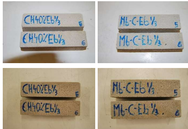
Figura 7.21 Inspección visual en el ensayo de carbonatación acelerada de los morteros definitivos de revestimiento. (Parte superior: antes de ensayo; Parte inferior: después del ensayo).
