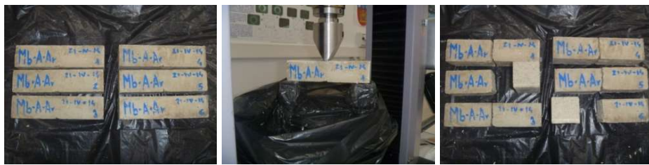
Figura 5.8 Probetas BAS-A-NA con edad de 7 días sometidas al ensayo de fractura.
