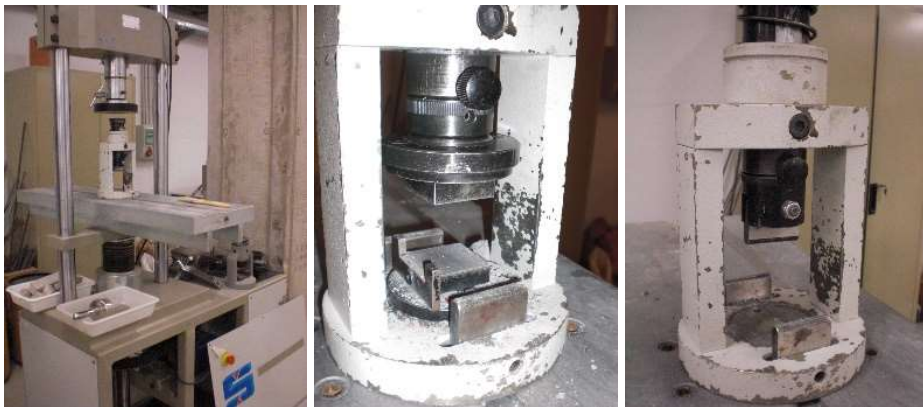
Figura 3.29 Maquina de ensayo (izquierda) con sus adaptadores para el ensayo a flexión (centro) y el ensayo a compresión (derecha).
