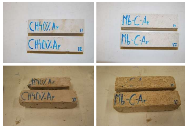
Figura 7.35 Inspección visual en el ensayo de cristalización de sales de los morteros patrón con árido natural (NA). (Parte superior: antes de ensayo; Parte inferior: después del ensayo).
