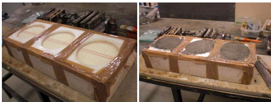
Figura 3.17 Elaboración probetas para el ensayo de permeabilidad al vapor de agua.
