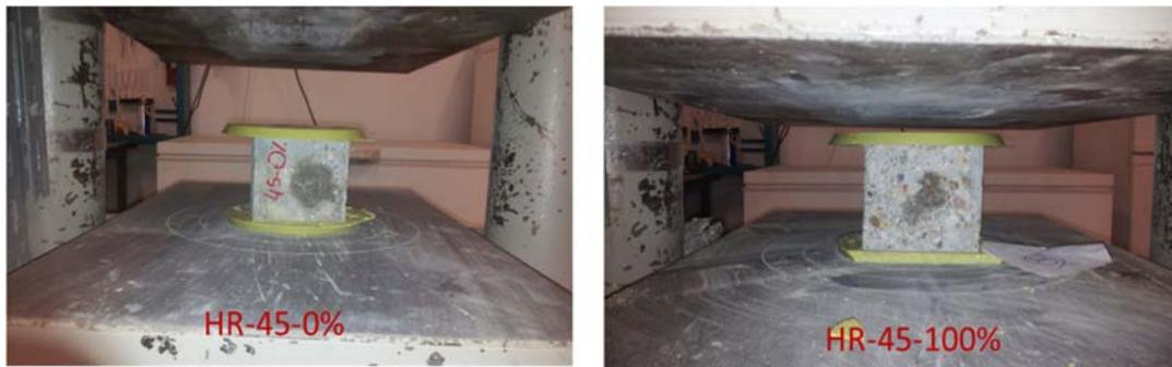
Fig. 103 Refrentado de las probetas después del ensayo y durante el ensayo a compresión.
