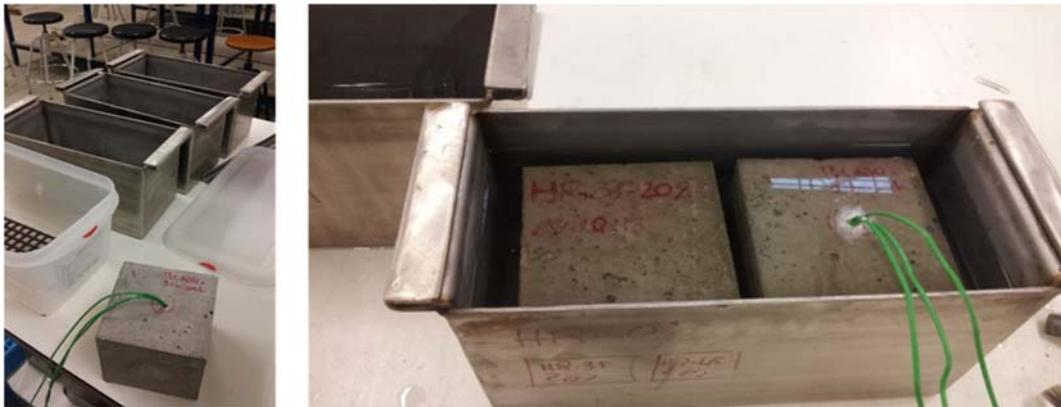
*Fig. 98 Preparación de los recipientes y de las muestras una de ellas mediante la sonda de temperatura.*
