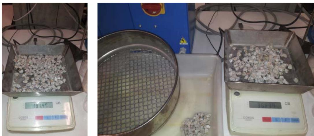
Fig. 46 Pesaje después de los ciclos y material de árido que pasa por el tamiz 10 mm.
