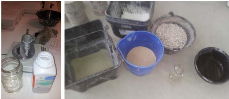
Fig. 62 Foto izquierda preparación solución de NaOH; y componentes para la dosificación incluido solución NaOH en la foto derecha.
