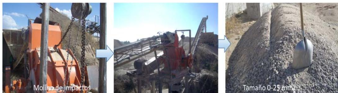
Fig. 27 Proceso final reducción en molino de impactos hasta tamaño 0/25 mm.
