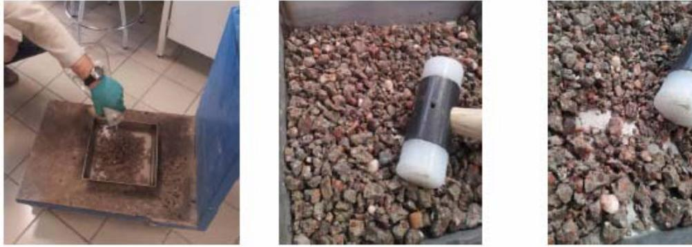
Fig. 48 Foto izquierda choque térmico mediante pulverización agua. Foto centro y derecha: separaciones mortero de árido ayudadas por martillo de goma.
