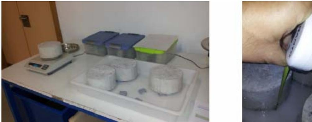
*Fig. 84 Ensayo de absorción por capilaridad.*
