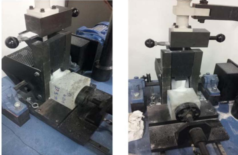
*Fig. 104 Máquina de abrasión empleada en el ensayo.*
