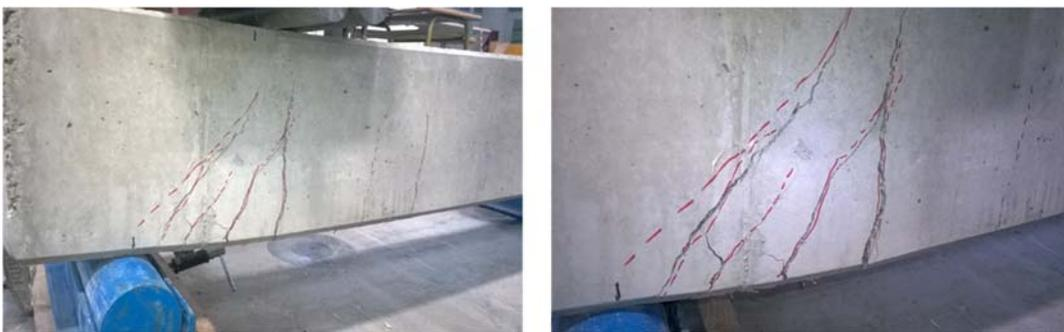
Fig. 250 Fotos donde se aprecia la fisuración canalizada a la carga al apoyo.
