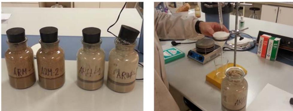
Fig. 55 Muestras sacadas del agitador (Foto izquierda) y Filtrado de las muestras (Foto derecha).
