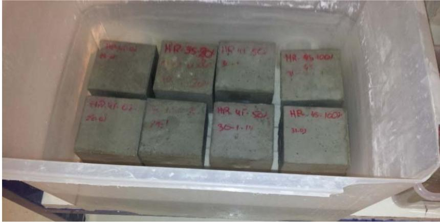
Fig. 113 Recipiente alojamiento agua con sulfatos para realización ciclos humedad-sequedad.
