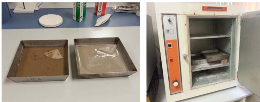
Fig. 61 Filtrado y secado al horno.
