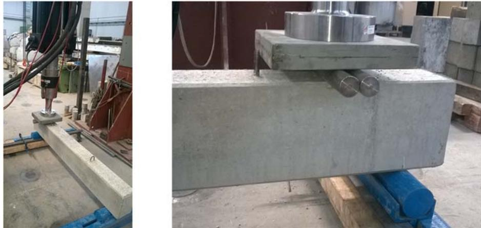
Fig. 226 Composición del ensayo a cortante.
