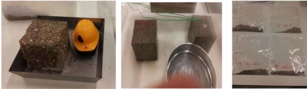
Fig. 102 Raspado superficial con cepillo (foto izquierda), Termopar en una de las probetas, y foto derecha residuo de las probetas en los intervalos que marca la Norma.
