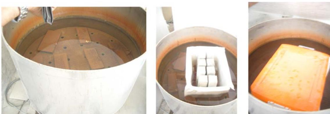
Fig. 64 Recipiente preparado a una temperatura de  $36 \pm 2$  ° C y HR=100%.
