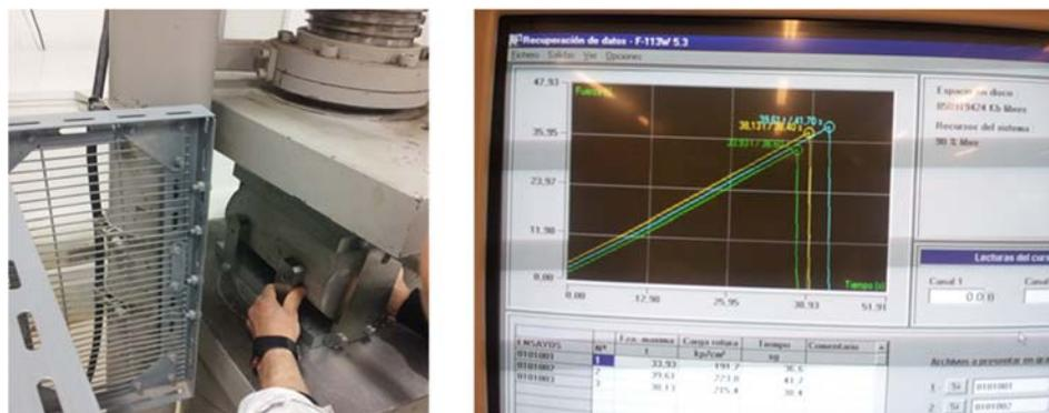
Fig. 78 Prensa y utensilio utilizado y los resultados de las tres el probetas.
