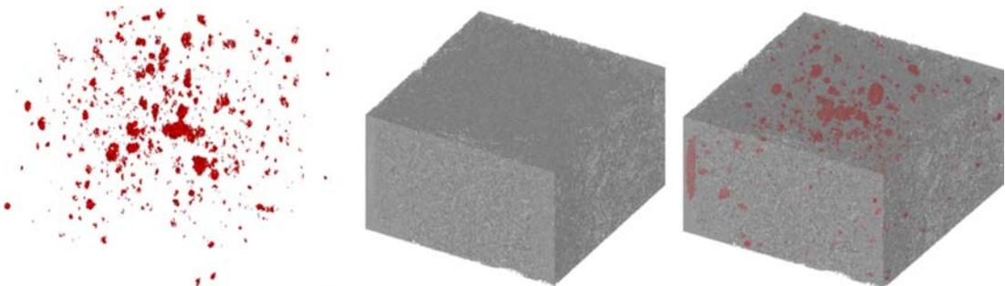
Fig. 162 Hormigón HR-45-0% (Control) resultados tomografía. Composición Poros+Mortero-Árido.
