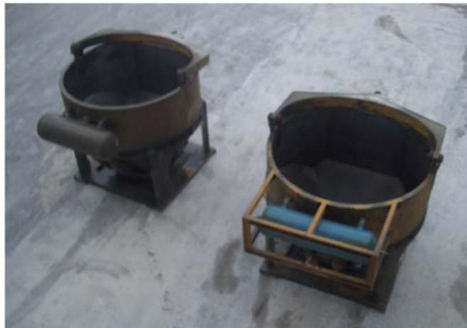
*Fig. 216 Cubilotes para transporte de hormigón fresco a la nave de prefabricados.*
