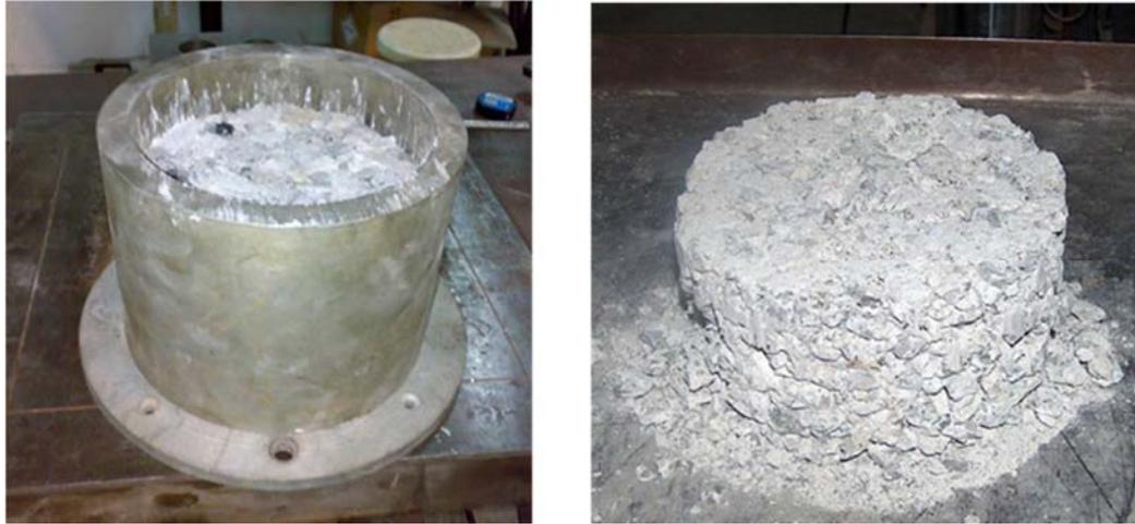
*Fig. 40 Aspecto de la muestra del ensayo de machacabilidad tras retirar el émbolo (izq.) y después de su extracción del recipiente (dcha.).*
