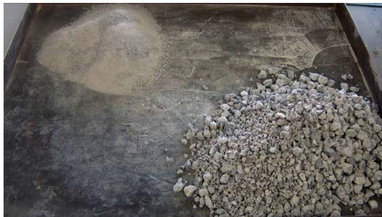
*Fig. 41 Aspecto de las dos fracciones obtenidas en el ensayo de machacabilidad tras el tamizado del árido a la conclusión del mismo.*
