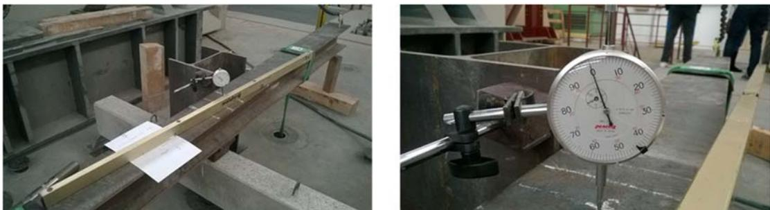
*Fig. 229 Colocación del dispositivo de medición con nivelación soportes.*
