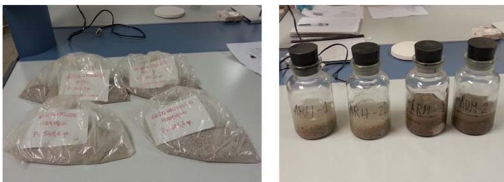
Fig. 54 Muestras de los áridos y botellas con áridos y agua.
