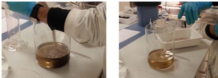
*Fig. 56 Cloruro de cinc y vertido del árido sobre el cloruro de cinc.*
