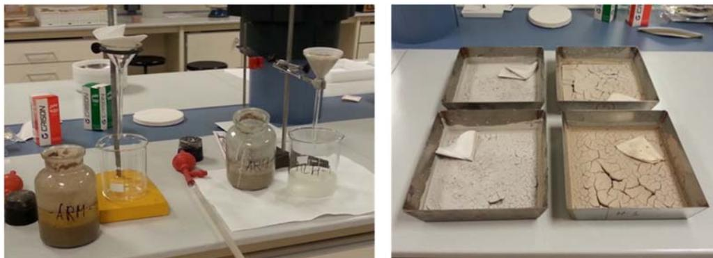
Fig. 60 Filtrado de precipitados y recipiente con árido decantado.
