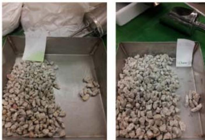
Fig. 31 Separación por tamaños y partículas con relación especificada fuera de rango.
