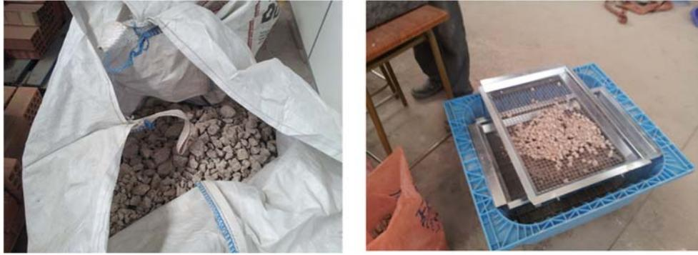
Fig. 28 Sacas de árido reciclado tamaño 0/25 mm (Foto izquierda) y cribado manual a tamaño 4/12,5 mm (Foto derecha).
