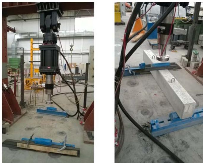
Fig. 222 Transductor y apoyo del pistón sobre rodillo para carga a flexión.
