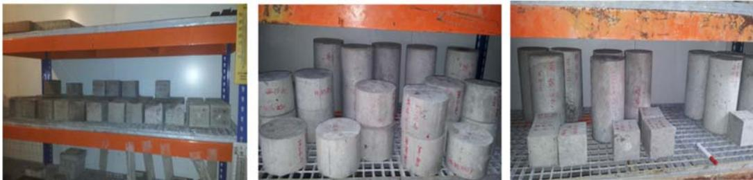
*Fig. 75 Cámara curado probetas a temperatura  $20^{\circ} C \pm 0,5$  y humedad del 95%.*
