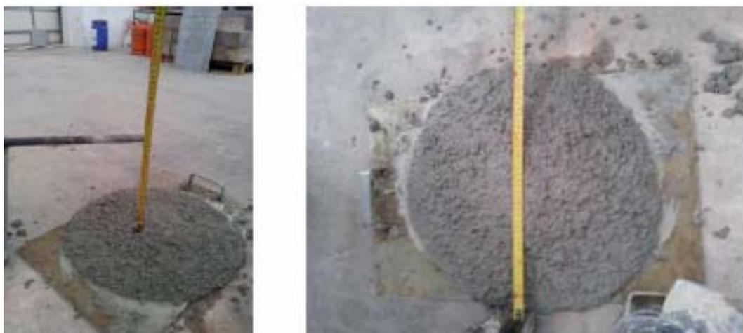
Fig. 76 Ensayo de docilidad por escurrimiento.
