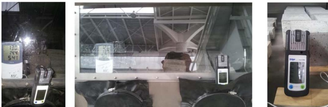
Fig. 108 Termómetro e higrómetro de control y medidor CO<sub>2</sub>
