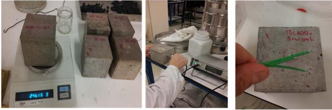
*Fig. 97 Medición del peso de las probetas antes del ensayo (foto izquierda, medición de ultrasonidos antes del ensayo, foto centro, y termopares de medición de temperatura, foto derecha.*
