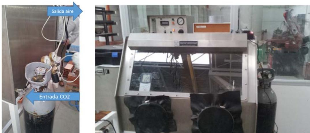
Fig. 107 Botella de CO<sub>2</sub> de capacidad 20 kg, cámara estanca adaptada e instrumentada, caudalímetro y sistema purga.
