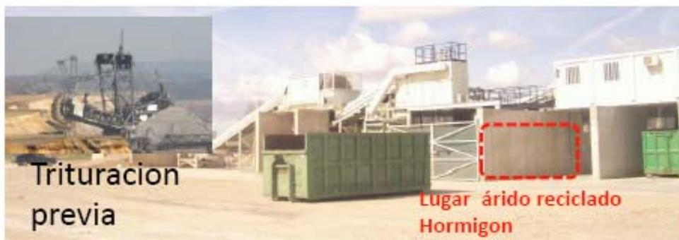
Fig. 29 Propuesta organización añadiendo una trituradora móvil en el proceso, tamizado (tromel), triaje, etc. y posteriormente acopiarlo.
