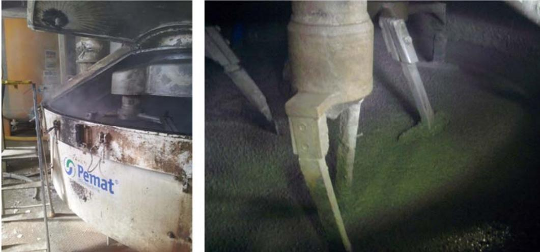
*Fig. 215 Amasadora planetaria de capacidad máxima 3 m<sup>3</sup> y mezclado de los componentes que forman parte del hormigón.*
