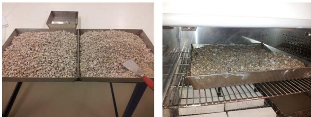
Fig. 42 Primera fase de selección de muestras y secado previo en horno a 50° C.
