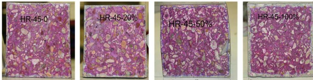
Fig. 189 Resultados de profundidad carbonatación en el HR-45.
