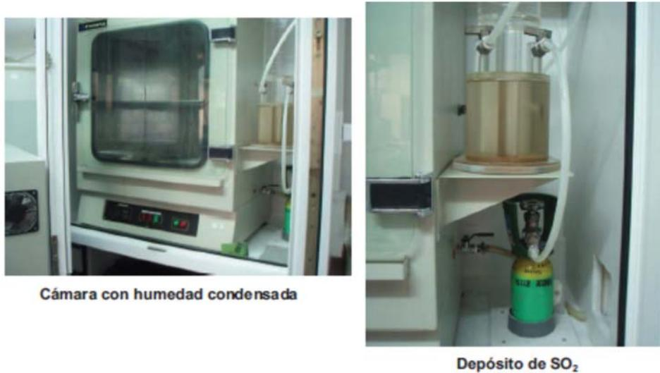
Fig. 110 Cámara de gases y dispositivo de medición del  $\text{SO}_2$ .
