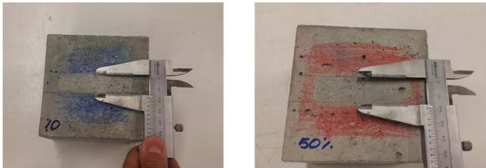
*Fig. 105 Medición de huella mediante calibre.*
