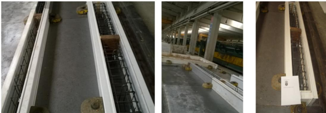
*Fig. 218 Molde preparado en la bancada de los paneles con sujeción de costeros mediante imanes.*
