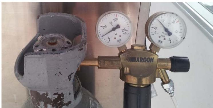
Fig. 109 Medidor de presión y caudal en litros/minuto, medidor reloj derecho.
