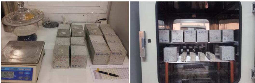
Fig. 111 Preparación probetas y medición de pesos antes de entrada en la cámara.
