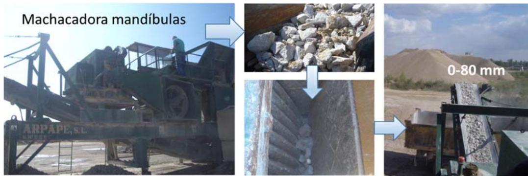
Fig. 26 Proceso de obtención de árido reciclado hasta un tamaño de 0/80 mm.
