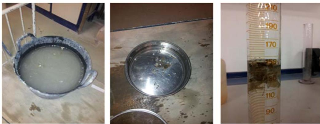
Fig. 43 Foto izquierda y foto centro: decantado de las partículas flotantes; foto derecha: volumen de partículas flotantes en el ensayo de clasificación por componentes.
