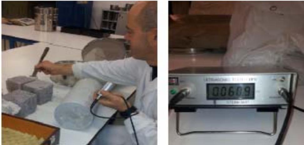
Fig. 82 Ensayo ultrasonidos en probeta cilíndrica 150x300 a la edad 180 días.
