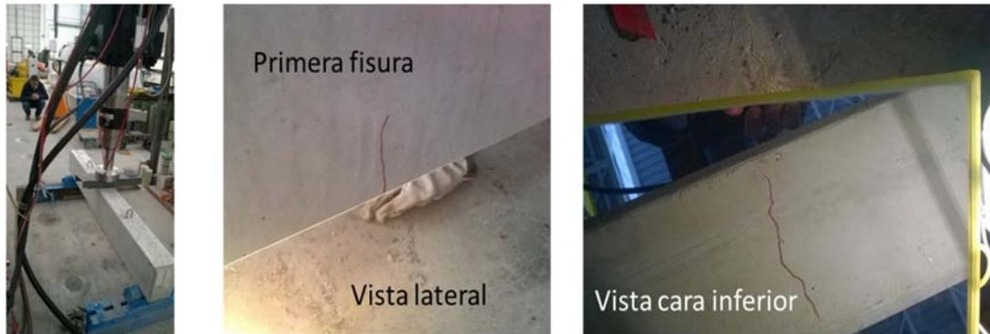
Fig. 235 Aparición primera fisura. Vista lateral e inferior vista mediante espejo.
