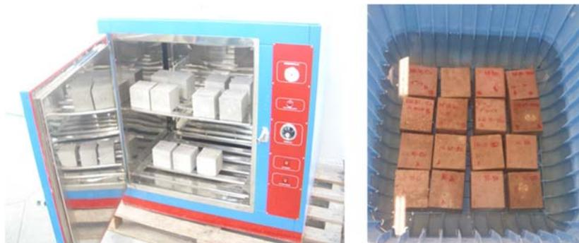
*Fig. 106 Probeta en horno a 105 ° C en ciclo de 16 horas y recipiente con agua para ciclos de 8 horas sumergido.*
