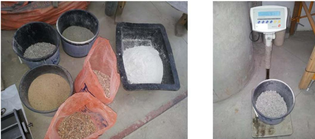
*Fig. 71 Componentes de una dosificación (foto izquierda), pesaje en báscula de capacidad 50 kg (foto derecha).*
