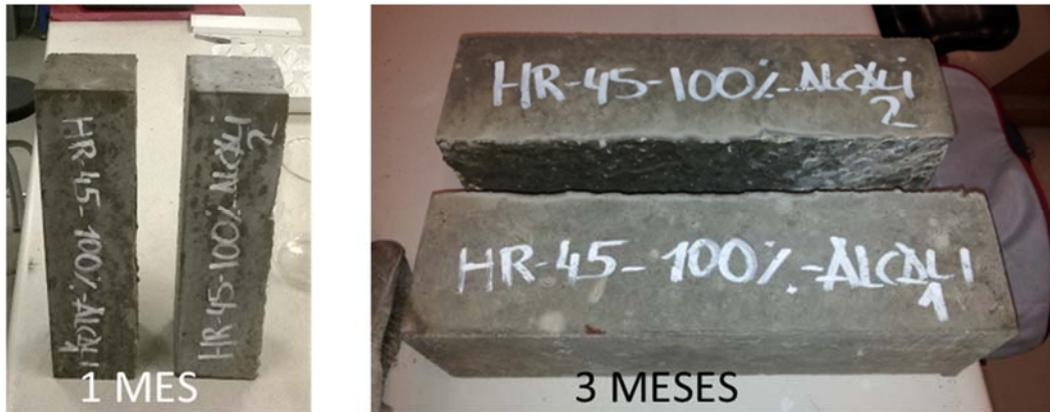
Fig. 65 Foto de evolución de las probetas con el tiempo.
