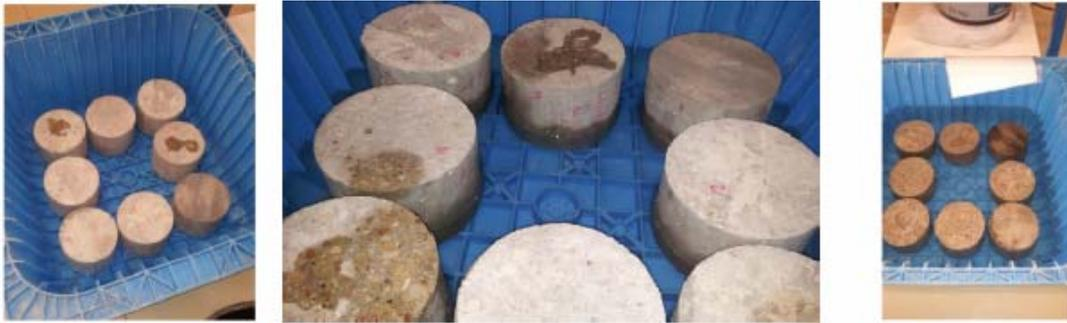
Fig. 83 Ensayo de absorción según el método ASTM C642.
