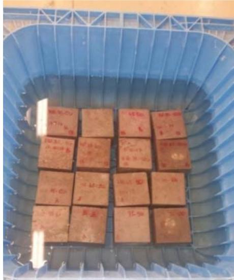
Fig. 112 Recipiente de alojamiento de probetas sometido a los ciclos humedad-sequedad.
