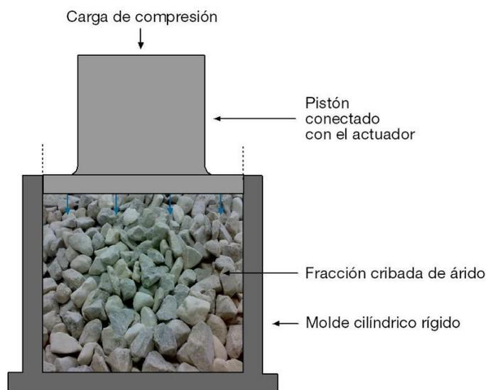
Fig. 38 Representación esquemática del ensayo de determinación del índice de machacabilidad del árido.
