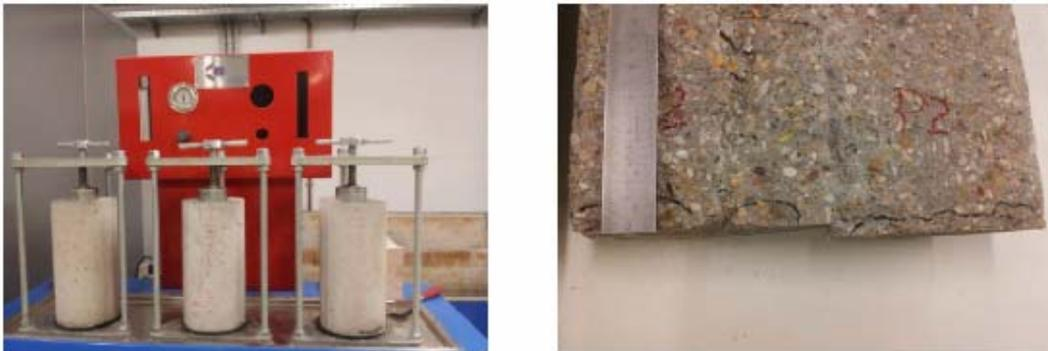
*Fig. 86 Ensayo permeabilidad bajo presión sobre tres probetas. Foto derecha medición de las profundidades de penetración.*
