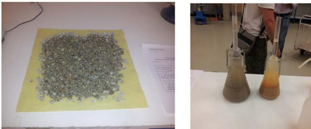
Fig. 35 Ensayo densidad y absorción del árido reciclado.
