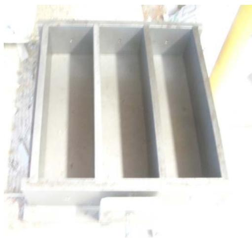
Fig. 93 Molde de probetas 7,5x7,5x27,5 cm para ensayo retracción.
