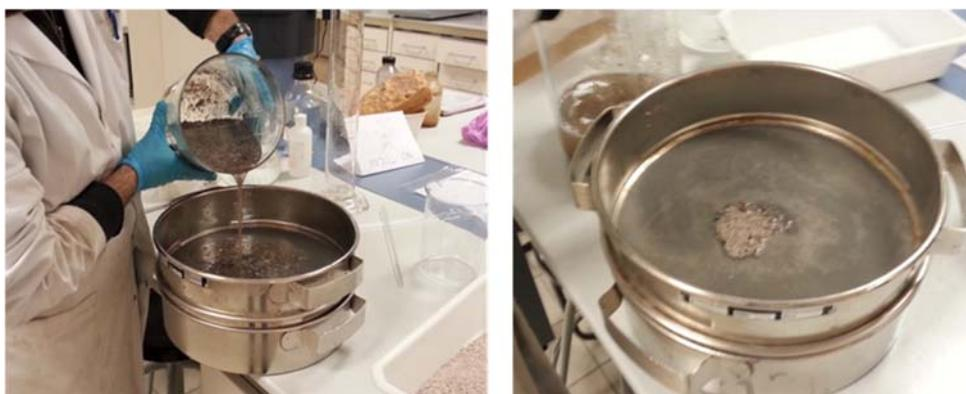
*Fig. 57 Decantado de precipitados y partículas retenidas.*
