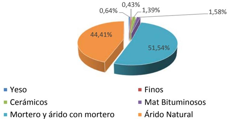
Fig. 13 Porcentaje en peso de componentes de un árido reciclado de hormigón.
