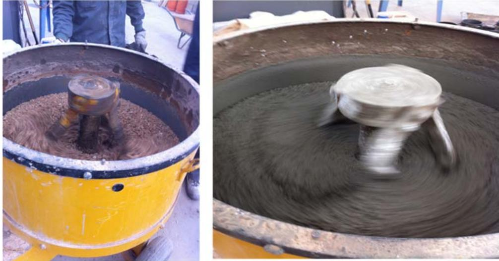
*Fig. 74 Proceso de amasado en hormigonera planetaria del laboratorio.*
