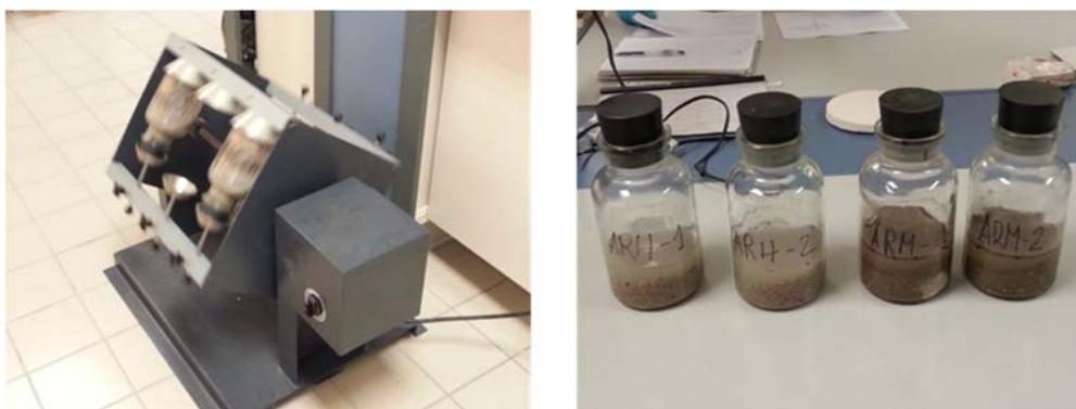
Fig. 59 Muestras del árido del ensayo de solubilidad al agua.
