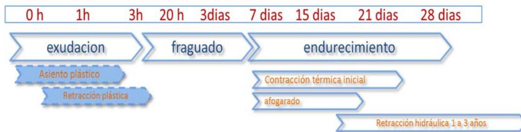
Fig. 20 Cuadro de retracción desde la retracción plástica en el periodo de exudación del hormigón a la retracción hidráulica que puede tener lugar hasta los tres años<sup>285</sup>.
