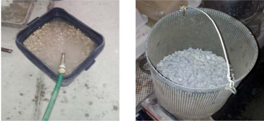
Fig. 72 Condiciones de saturación con superficie seca del árido grueso reciclado.
