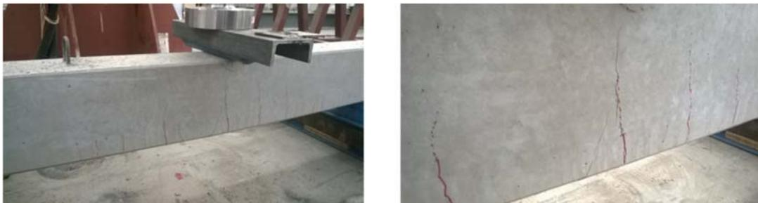
Fig. 224 Ensayo de flexión realizado con carga puntual. Señalización de las fisuras y progresión entre ellas con líneas de punto.
