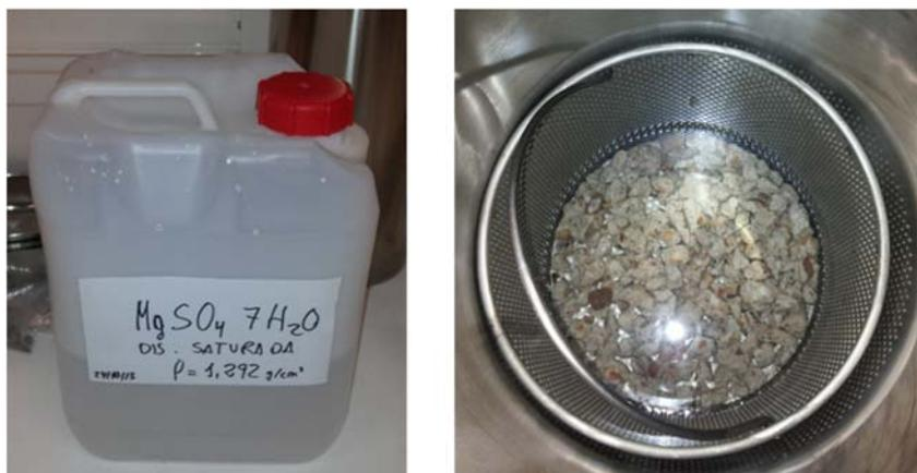
Fig. 45 Ensayo de sulfato de magnesio con la muestra sumergida en solución de sulfato magnésico durante 8 h.
