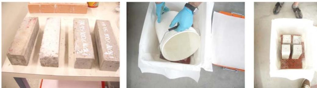
Fig. 63 Preparación de las probetas y recipiente aislado con papel traza para evitar goteo humedad.
