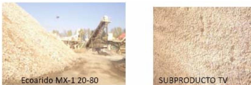
*Fig. 6 Tipos de árido que produce RESBUR: ecoáridos MX-1 20-80, Subproducto TV.*
