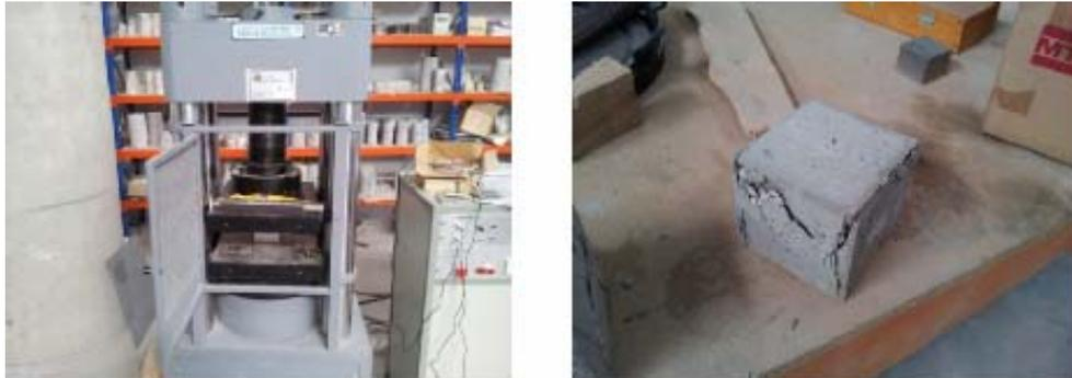
Fig. 77 Ensayo de determinación de la resistencia a compresión.
