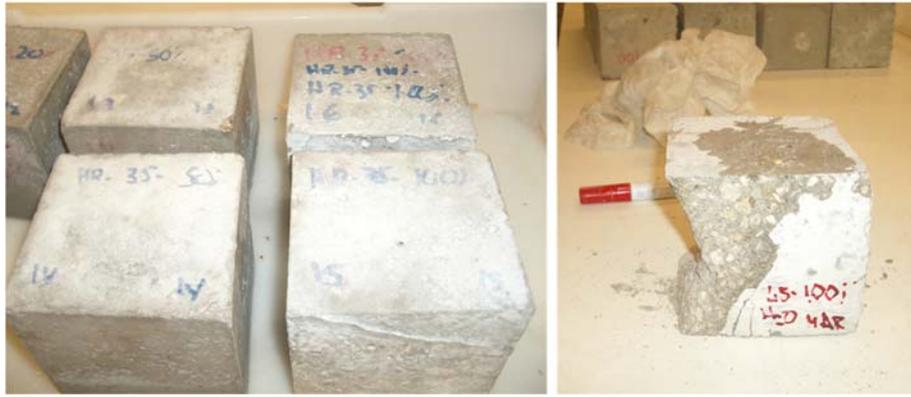
Fig. 206 Apariencia de las probetas una vez finalizados los ciclos humedad sequedad en agua de mar.
