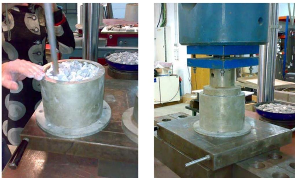
*Fig. 39 Compactación del material en el molde cilíndrico (izq.) y aplicación de la carga de compresión en el transcurso del ensayo de determinación del índice de machacabilidad del árido (dcha.).*
