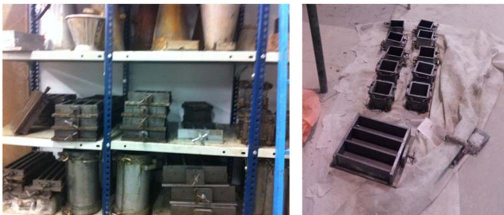
*Fig. 73 Diferentes tipos de moldes para la confección de probetas.*
