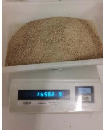
*Fig. 70 Determinación de la humedad de la arena por diferencia de pesada en condiciones de laboratorio.*
