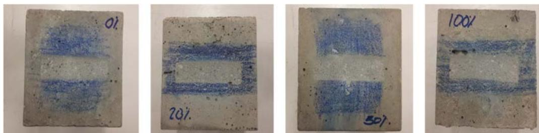
Fig. 181 Resultado de la huella producida en las probetas de hormigón según el grado de sustitución por AR.
