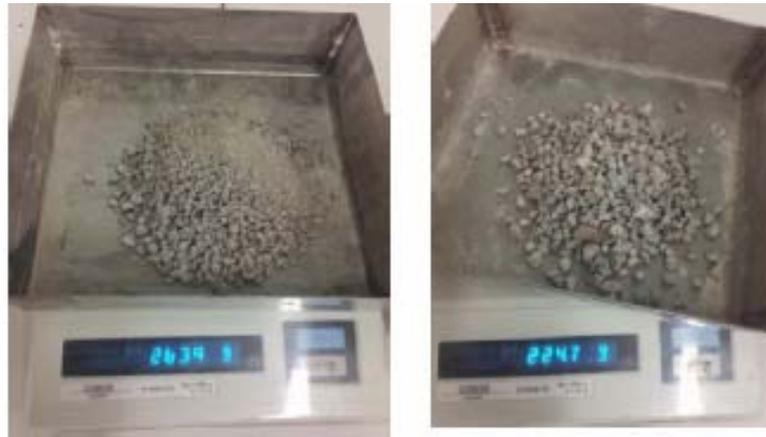
Fig. 49 Pesaje de mortero adherido (foto izquierda) y árido (foto derecha).
