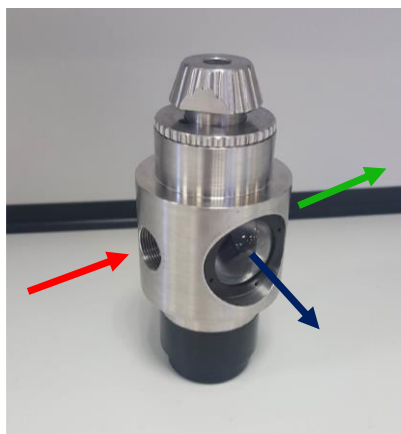
Figura 12. Celda de T-Jump para medidas de absorbancia y de fluorescencia. La luz entra por la ventana pequeña (flecha roja), y se recoge la luz que sale a 90^\circ en el caso de medidas de fluorescencia (flecha azul) y a 180^\circ en el caso de medidas de absorbancia (flecha verde).
