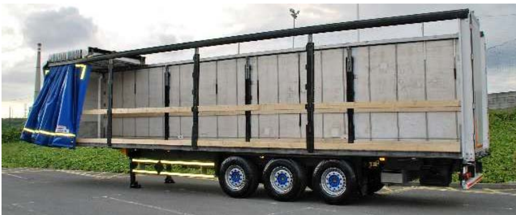
Figura 106.- Semirremolque tipo tauliner con apertura de lonas. Fuente: Elaboración propia.
