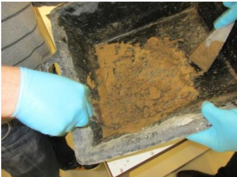
Ilustración 91: Fraguado casi instantáneo del mortero
