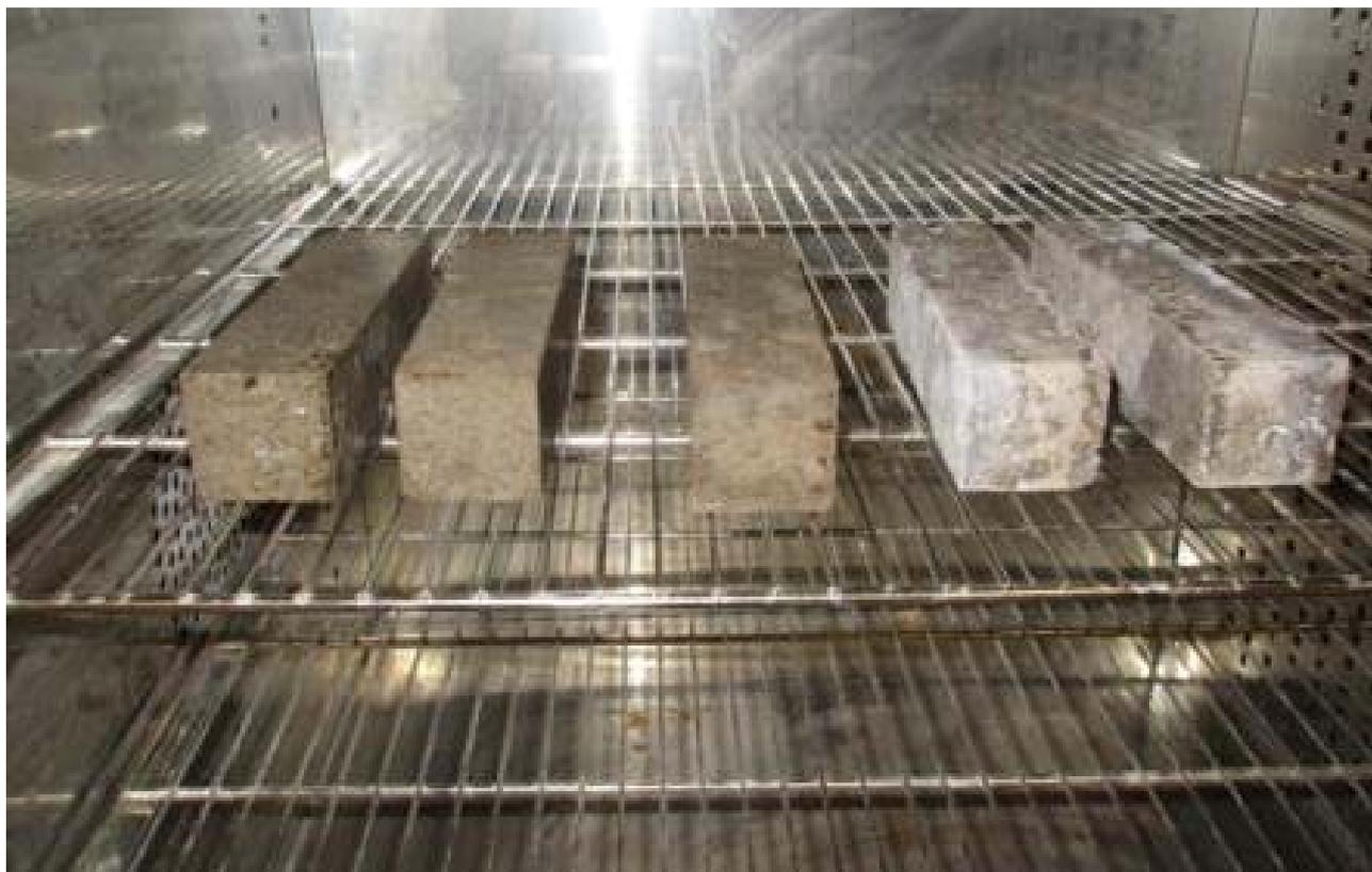
Ilustración 127: secado de probetas
