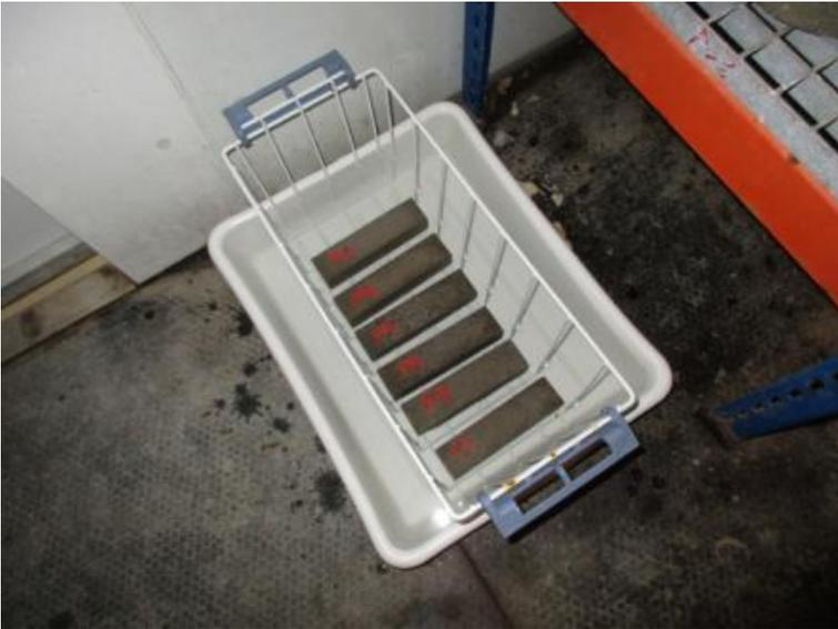
Ilustración 133: Probetas en tanque de deshielo
