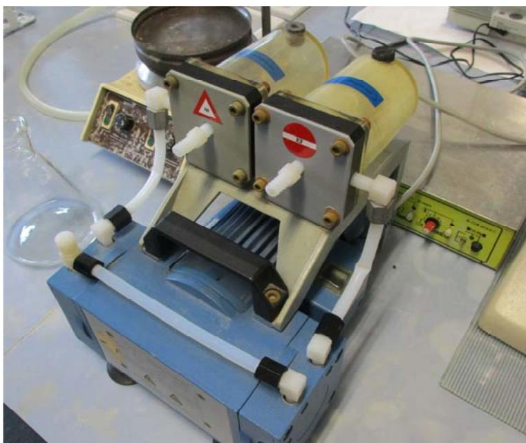
Ilustración 169: Bomba de vacío empleada en el filtrado
