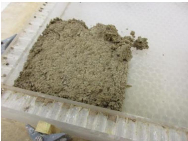
Ilustración 98 Estado del mortero a las 48 horas
