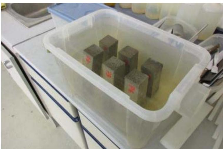
Ilustración 132: probetas en proceso de saturación
