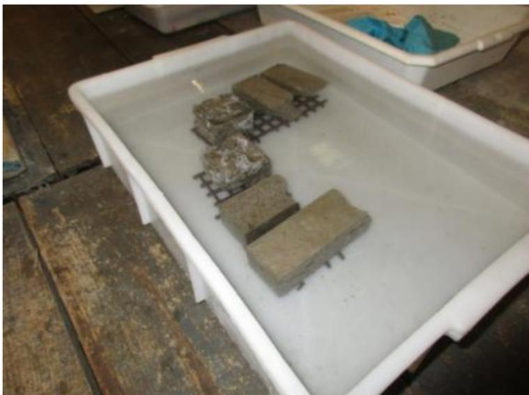
Ilustración 128: semiprobetas sumergidas en agua
