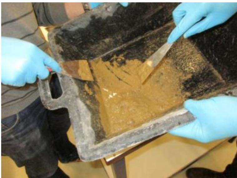
Ilustración 90: Mezclado manual del mortero
