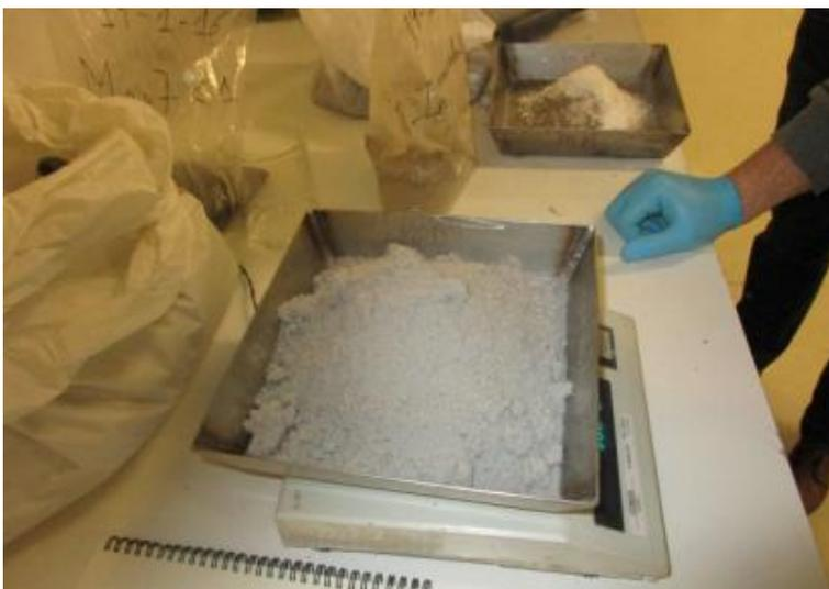
Ilustración 94: Aporte de PU demasiado elevado respecto al volumen de MPC en fase seca (bandeja en segundo plano en la imagen)
