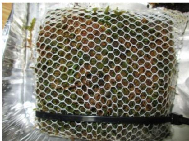
Al cabo de 5 semanas se examina la evolución de la muestra. Se retira el tejido sintético (Ilustración 155), y se comprueba que, en su mayor parte, el briófito no ha arraigado en el mortero MPC (Ilustración 156).
