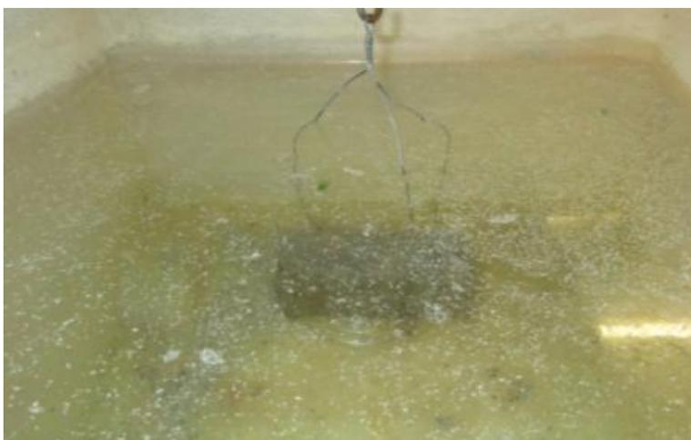
Ilustración 129: Pesada hidrostática
