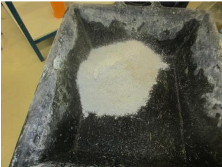
Ilustración 95: Volumen de PU en la mezcla del mortero
