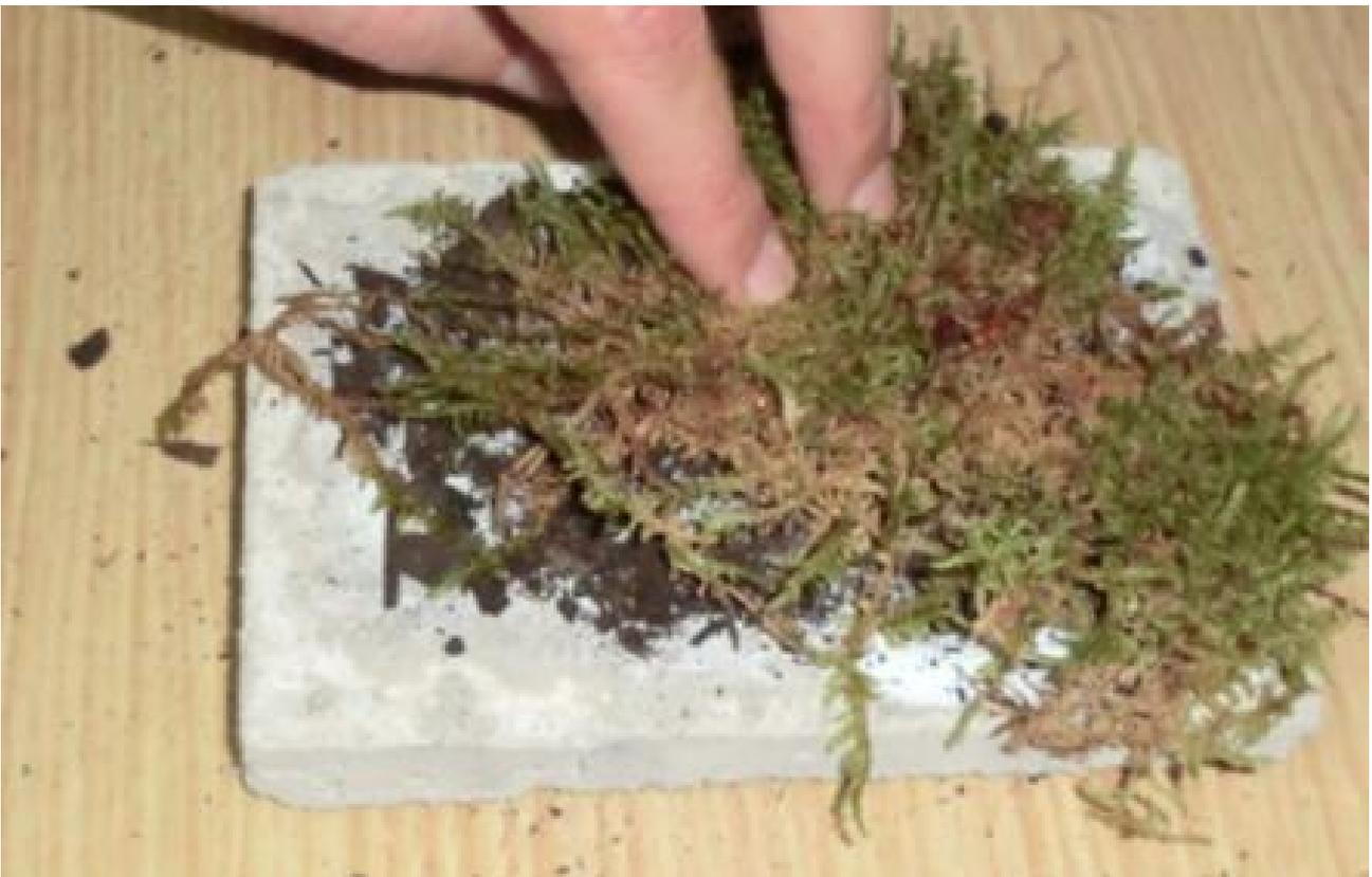
Ilustración 118: Cultivo sobre el sustrato de cemento aligerado con añadido de turba y yogur
