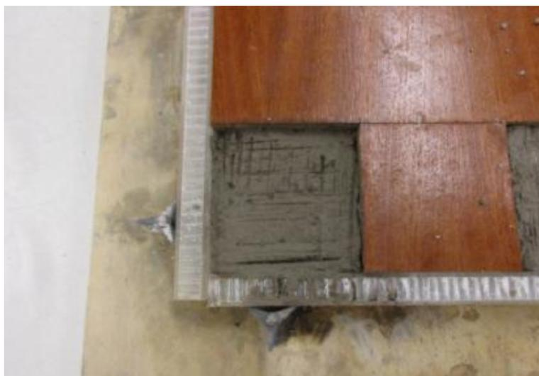
Ilustración 100: Muestra de consistencia plástica tras su vertido al molde
