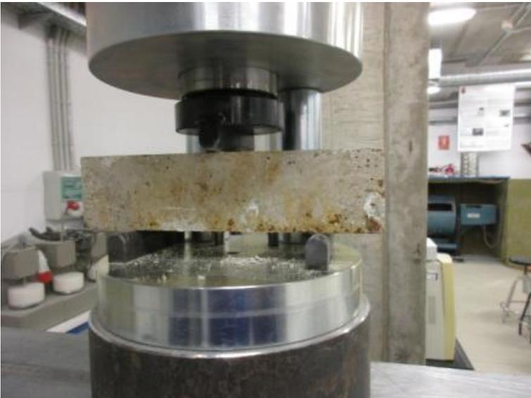
Ilustración 125: máquina para ensayo, colocación de la probeta
