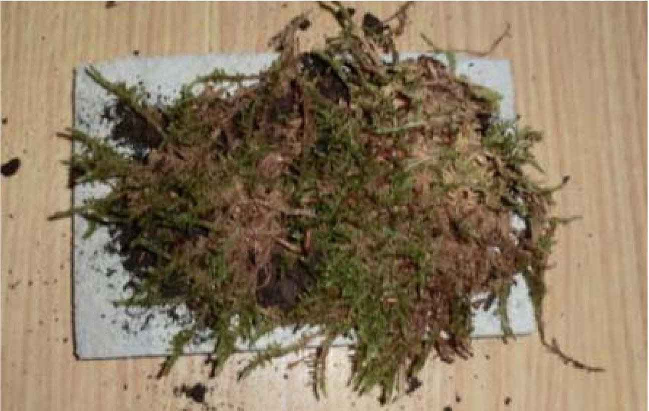
Ilustración 117: Cultivo sobre el sustrato de cemento aligerado con añadido de turba
