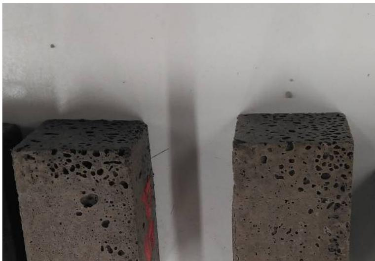
Ilustración 136: Aspecto de superficie de probetas tras ensayo de heladicidad
