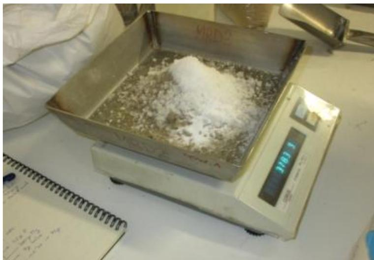
Ilustración 88: Pesado de los distintos componentes del mortero MPC
