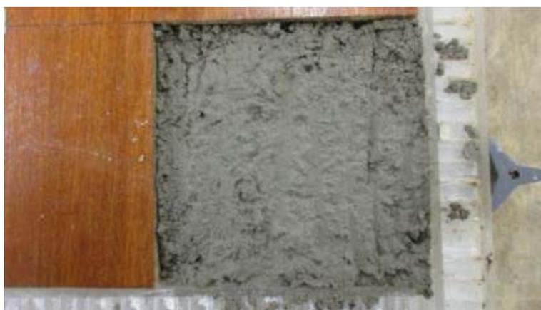
Ilustración 104: Muestra de consistencia plástica tras su vertido al molde
