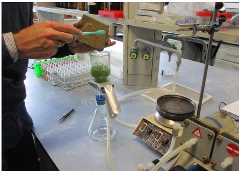
Ilustración 168: Proceso de extracción de la biomasa mediante cepillado, lavado, y posterior filtrado
