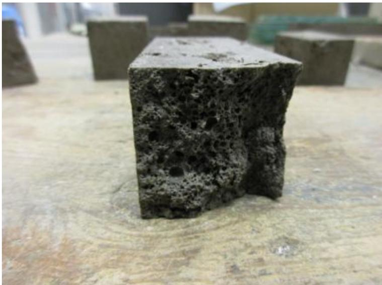
Ilustración 123: Probeta rota al ser desmoldada
