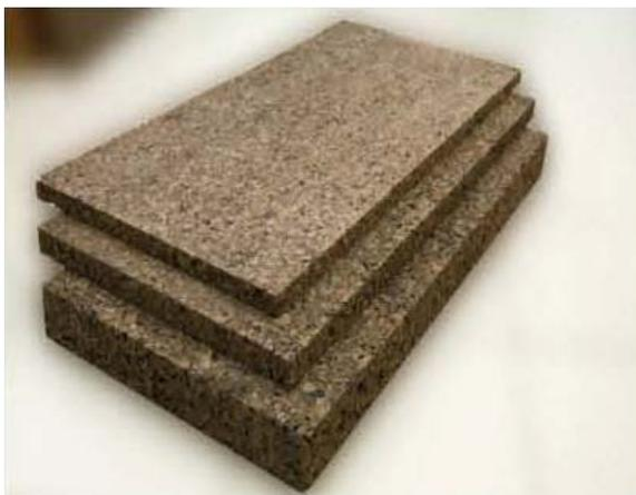
Ilustración 73: Paneles de aislamiento térmico de corcho tratado, fuente Aglocork
