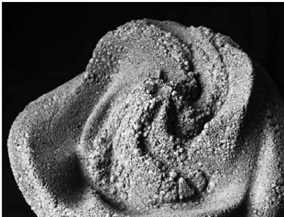
Ilustración 65: Componentes de fachada de hormigón aligerado para crecimiento de criptógamas, fuente BiotA Lab
