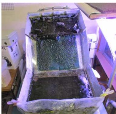
Ilustración 166: canal compuesto por tres planos para recolección de microalgas
