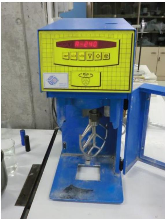
Ilustración 82: Mezcladora de laboratorio empleada
