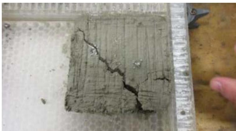
Ilustración 103: muestra fracturada en el desmolde, sin resistencia mecánica adecuada
