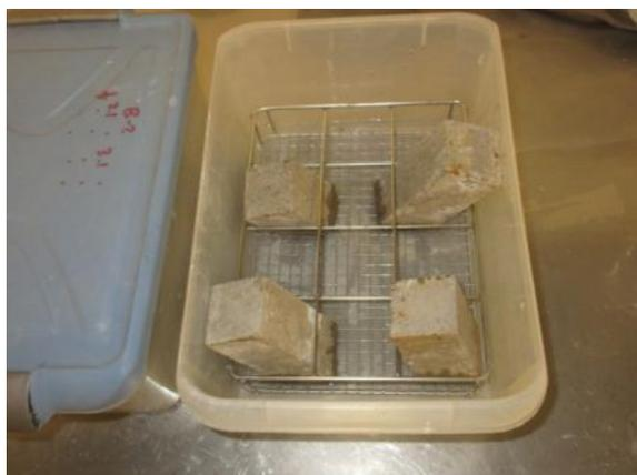
Ilustración 130: Semiprobetas sumergidas en 7 mm de agua
