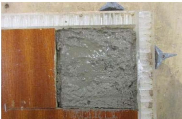
Ilustración 105: Muestra de consistencia fluida tras su vertido al molde
