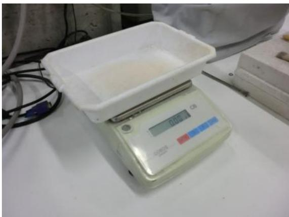
Ilustración 81: Balanza electrónica empleada, con el peso de la bandeja descontado
