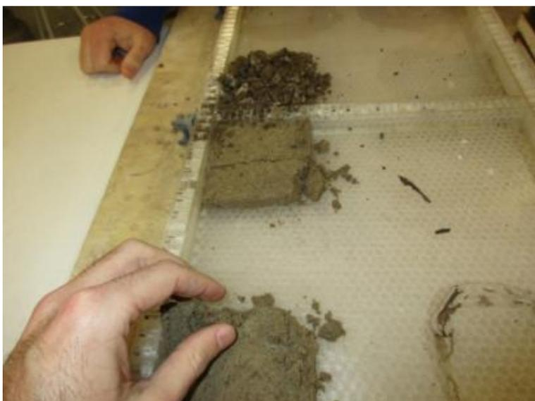
Ilustración 99: Estado del mortero a las 48 horas, nula resistencia y consistencia
