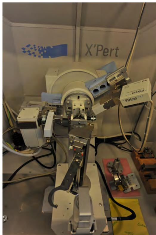
**Fig. 3.12: Interior del difractómetro de rayos X PANalytical X'Pert PRO.**
