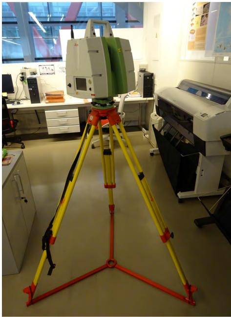
**Fig. 3.5: Láser Escáner Leica ScanStation C10.**
