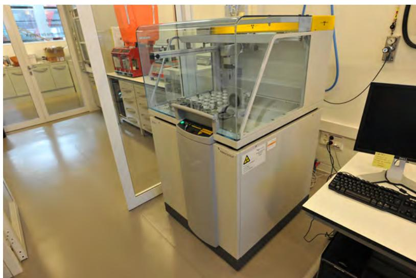
**Fig. 3.13:** Espectrómetro de fluorescencia de rayos X por dispersión de longitud de onda PANalytical Axios disponible en el Laboratorio de Arqueometría del CENIEH.
