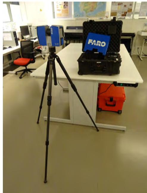
**Fig. 3.6: Láser Escáner Faro Focus 3D X330.**
