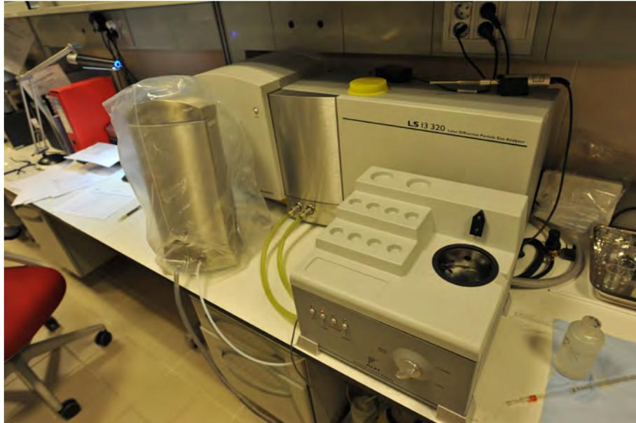
**Fig. 3.9: Difractómetro láser Coulter LS13 320, usado para analizar la fracción de limos y arcillas.**
