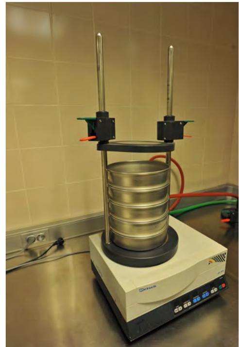
**Fig. 3.8: Tamizadora automática RESTCH AS200 con cuatro tamices a una distancia de 1  $\phi$ .**
