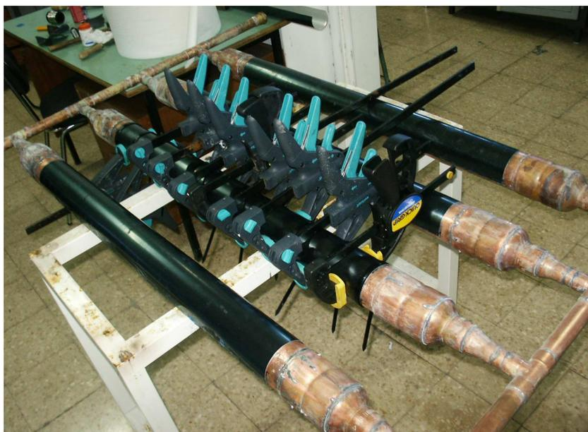
Figura 4.8: Detalle de los tubos del generador durante el proceso de fijación de la lámina.
