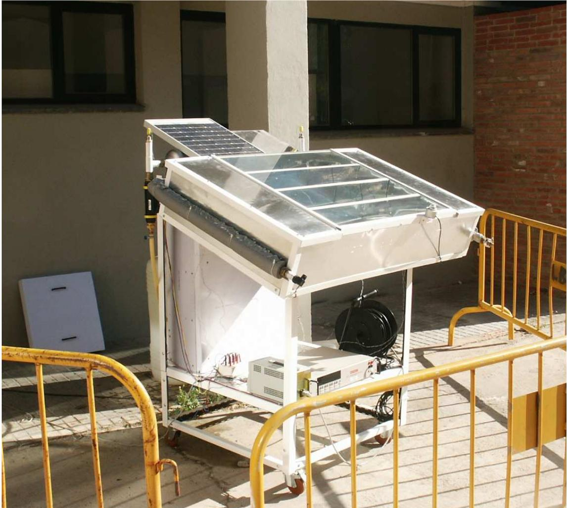
Figura 4.5: Vista frontal del prototipo. Se aprecian en la parte superior el sistema de captación y el módulo fotovoltaico que permite la circulación de agua a través del condensador. En la parte inferior destacan el recinto frío y el sistema de captura de datos.
