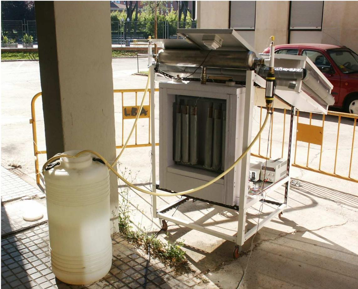
Figura 4.6: Vista posterior de la máquina de 2005. Destacan el condensador, el recinto frío con el evaporador a la vista y el depósito de agua para el condensador.
