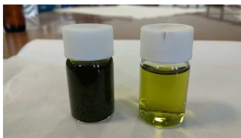
Figura 10. Fotografía del concentrado (izquierda) y permeado (derecha) obtenidos después de la nanofiltración del permeado de UF del extracto de hojas de olivo.
