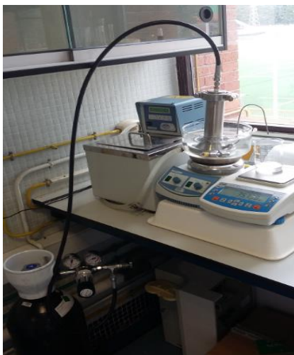
Figura 7. Fotografía del dispositivo utilizado para la concentración del extracto mediante nanofiltración.
