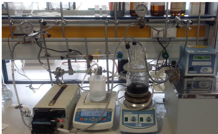
Figura 6. Fotografía del dispositivo utilizado en la decoloración del extracto acuoso mediante un proceso combinado de adsorción con CA y UF.
