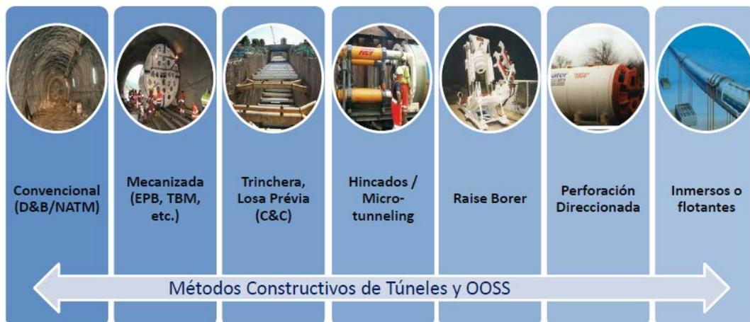
Aunque para el sector hidroeléctrico, los métodos más usuales pueden ser resumidos en términos del método convencional y del mecanizado, respectivamente.
