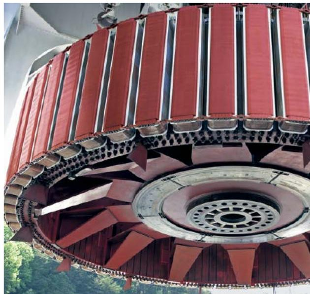
El flujo magnético creado por la corriente de excitación pasa a través del espacio entre el rotor y el estator y, al girar el rotor, induce en el devanado del estator una fuerza electromotriz que al aplicarla a un circuito exterior (la red) hace fluir una corriente eléctrica.
