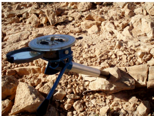
Figura. 4.2. Inclinómetros con brújula integrada para la determinación del azimut y la inmersión de las muestras in situ.
