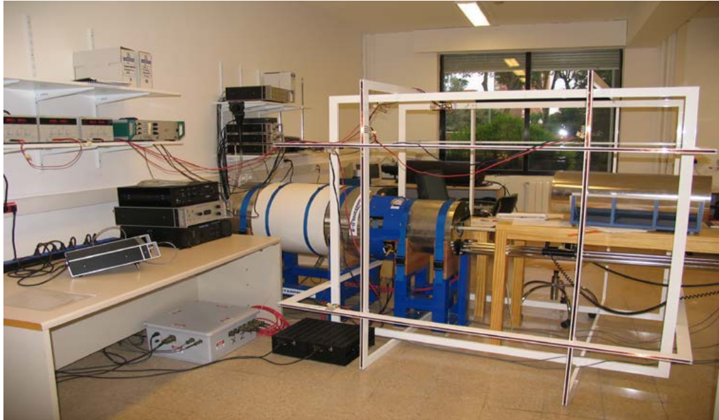
Figura. 4.9 Magnetómetro criogénico superconductor 2G-755.
