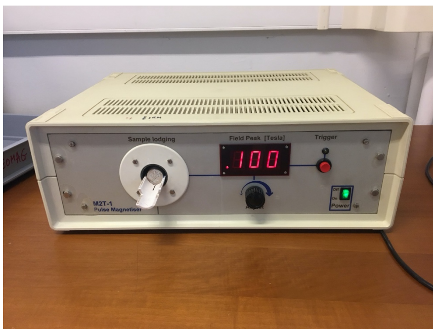
Figura. 4.10. Inductor Magnético Magnetizador de pulsos M2T-1 (FERRONATO).
