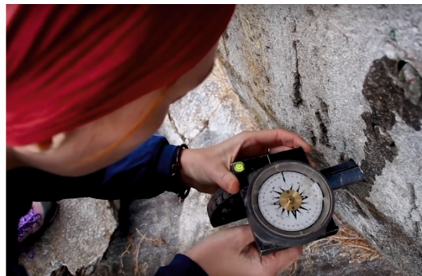
Figura. 4.2. Inclinómetros con brújula integrada para la determinación del azimut y la inmersión de las muestras in situ.
