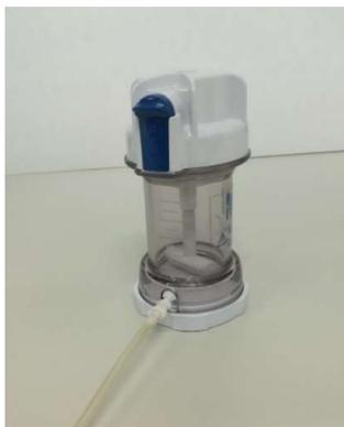
**Figura 5.** Celda de ultrafiltración modelo Amicon® 8050.
