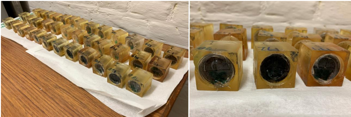
Fig. 3.6. Muestras preparadas dentro de los portamuestras correspondientes para la adquisición de la IRM con el sistema robotizado acoplado al magnetómetro criogénico.
