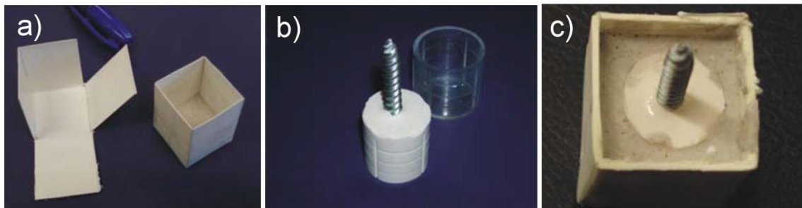
Fig. 3.3. Proceso de creación de cubos de escayola para insertar muestras tomadas con el dispositivo de blandos: (a) moldes cúbicos; (b) molde de silicona replicando el interior de las cápsulas de plástico; (c) cubo en proceso, donde se ve el molde de silicona inmerso en la escayola. Una vez que esta se seca un poco, se extrae el molde de silicona, quedando impreso su negativo (que es donde se introducirá la muestra). [Modificado a partir de Carrancho (2010)]
