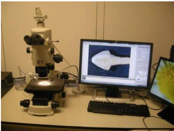
Fig. 4.29. Lupa binocular Nikon AZ 100 con cámara digital Nikon DS-V3 acoplada.
