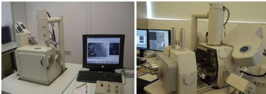
Fig. 4.32. a) Microscopio Electrónico de Barrido JEOL JSM-6460LV con sistema INCA de análisis elemental por Rayos X (UBU); b) Espectro multicanal Model 7000 que opera en sistema Quantex (CENIEH)
