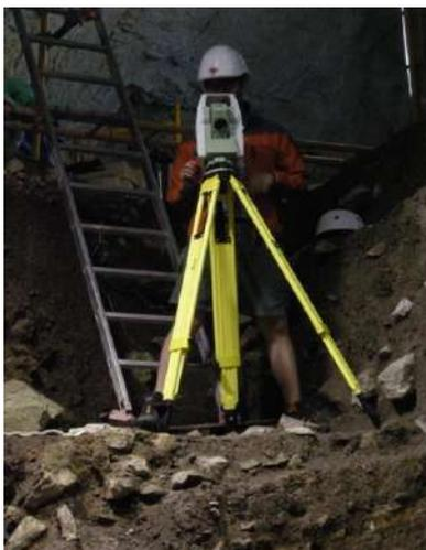
Fig. 4.9. Toma de coordenadas espaciales con Estación Total (Leica TS02).
