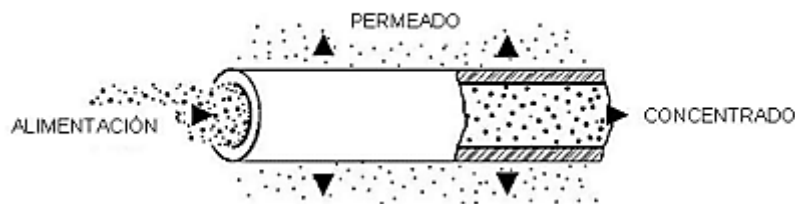
Figura 5. Diagrama de operación de una membrana tubular.
