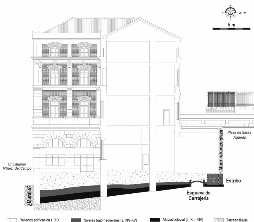
Figura 3. Sección transversal del inmueble a la altura del martillo occidental, con la esgueva de Cerrajería, el refuerzo de la plaza de Santa Águeda, los rellenos de la cimentación del siglo XIX y los depósitos arqueológicos bajomedievales
